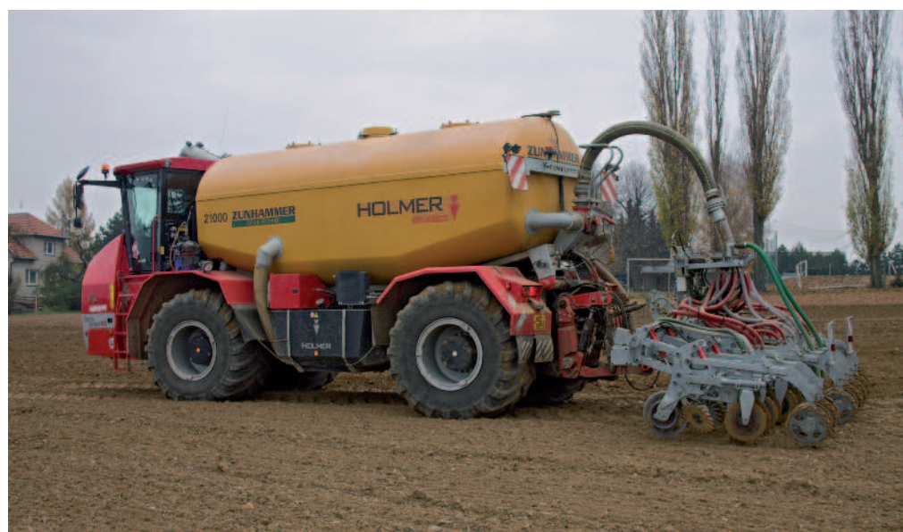
Obr.: Systémový nosič Terra Variant se strojem na aplikaci a zapravování organických hnojiv v pásech.
