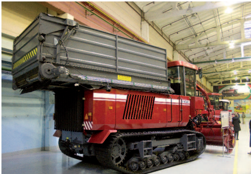
Obr.: Pásová řezačka s vlastním překládacím zásobníkem je určena převážně do Kazachstánu.
