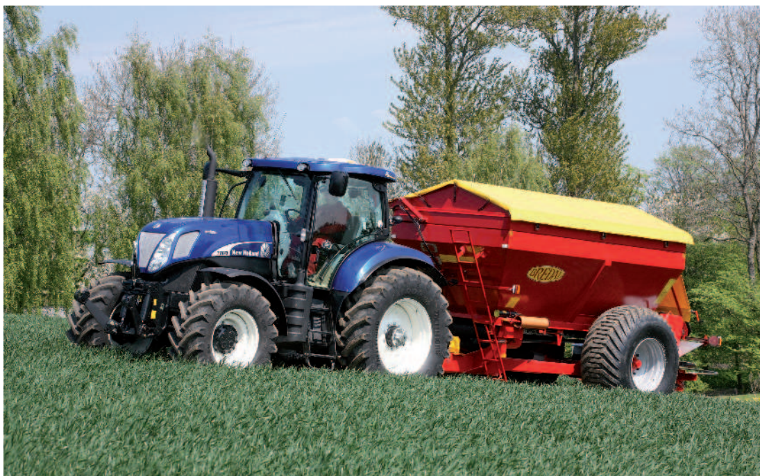
Obr.: Návěsné rozmetadlo průmyslových hnojiv Bredal K105. Foto archiv P & L, spol. s r. o.
