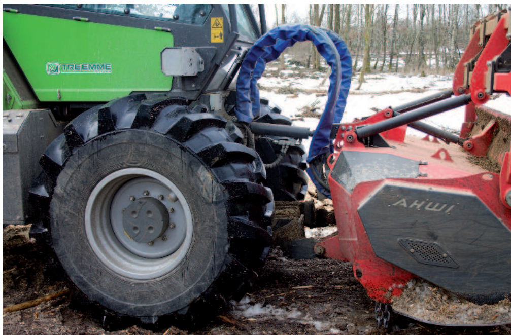
Obr.: Připojená fréza je poháněna hydraulicky, aby se rázy nepřenášely na stroj.
