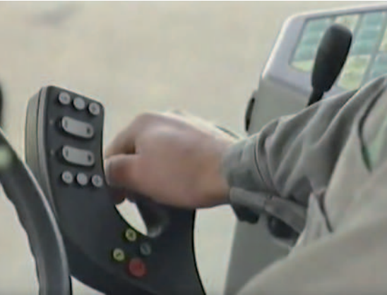
Obr.: Takto vypadal první joystick použitý v traktoru s plynulou převodovkou.
