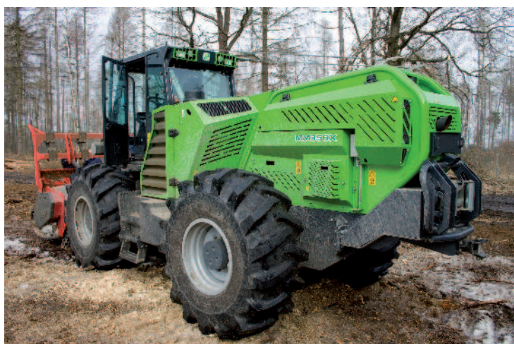
Obr.: Motorový prostor je v tom nejširším místě za kabinou vyhrazen pro chladiče motoru a oleje.
