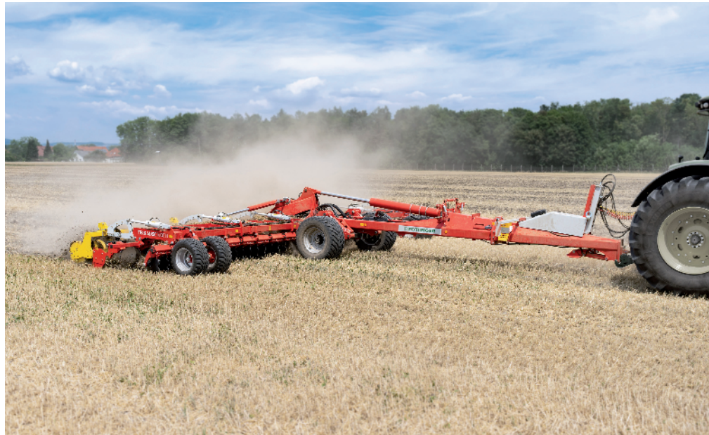
Obr.: TERRADISC je rozdělen na jednotlivé hydraulicky sklopné sekce, každá z nich se individuálně přizpůsobuje povrchu pole.
