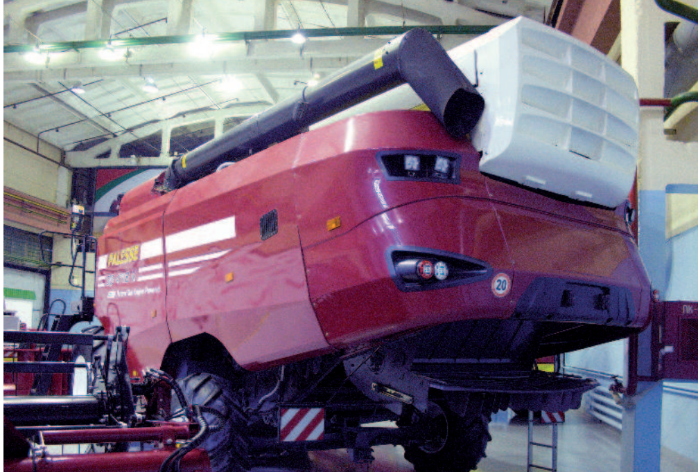
Obr.: Světově první mlátička s pohonem na plyn v sériovém provedení. Pod bílým krytem se nachází zásobník plynu.
