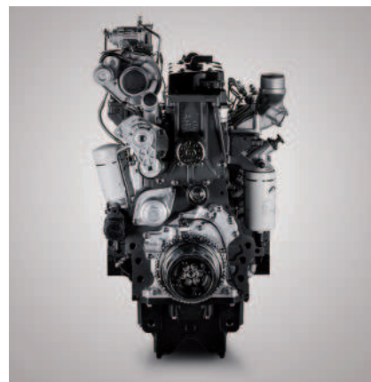
Obr.: Pro pohon traktoru byl konkrétně zvolen čtyřválcový motor N45, který je vybaven technologií HI-eSCR2 pro plnění emisní normy Stage V.
