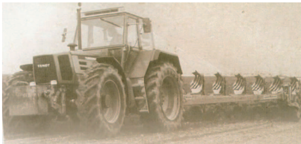
Obr.: Jeden z testovacích prototypů s plynulou převodovkou.
