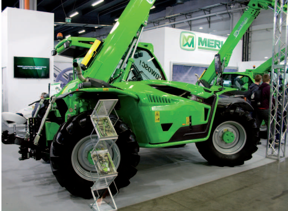
Obr.: Tento manipulátor byl vybaven zadním tříbodovým závěsem pro agregaci nejrůznějšího nářadí na zpracování půdy a setí či tahání přívěsů a návěsů.
