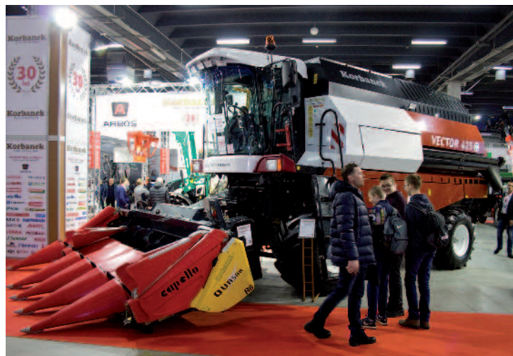
Obr.: Vector 425 osazený motorem Cummins o výkonu 228 koní. Zásobník zrna pojme 6 000 litrů.
