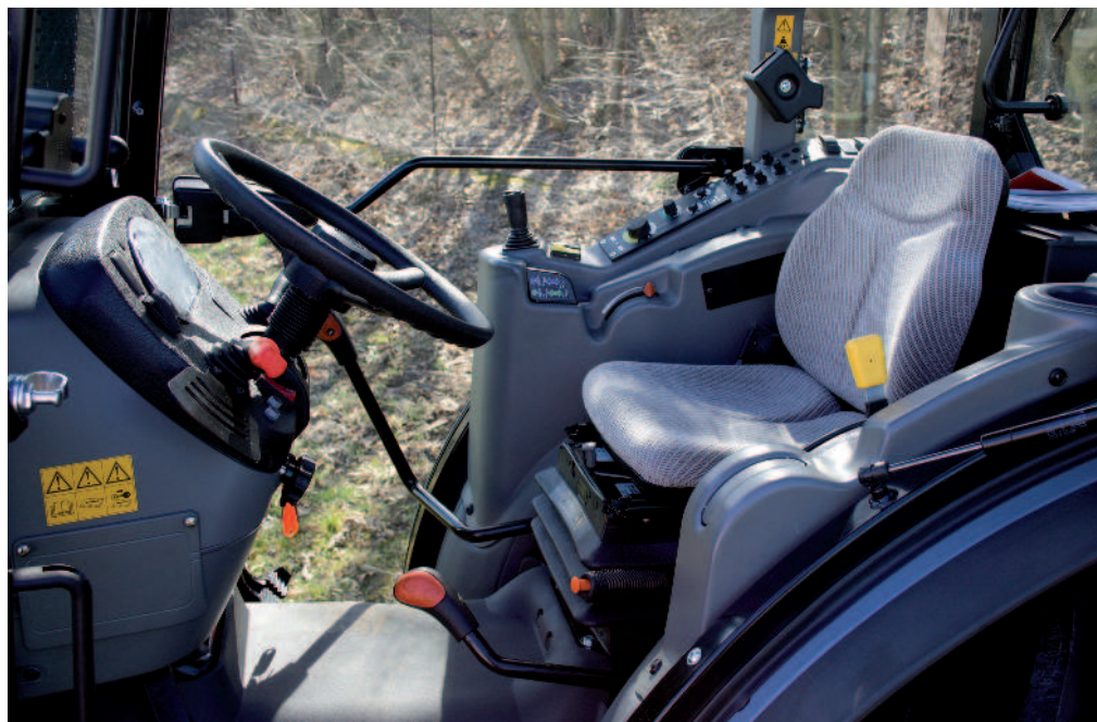
Obr.: Přístup do kabiny je možný zprava i zleva. Na obou stranách se nachází ovládání.
