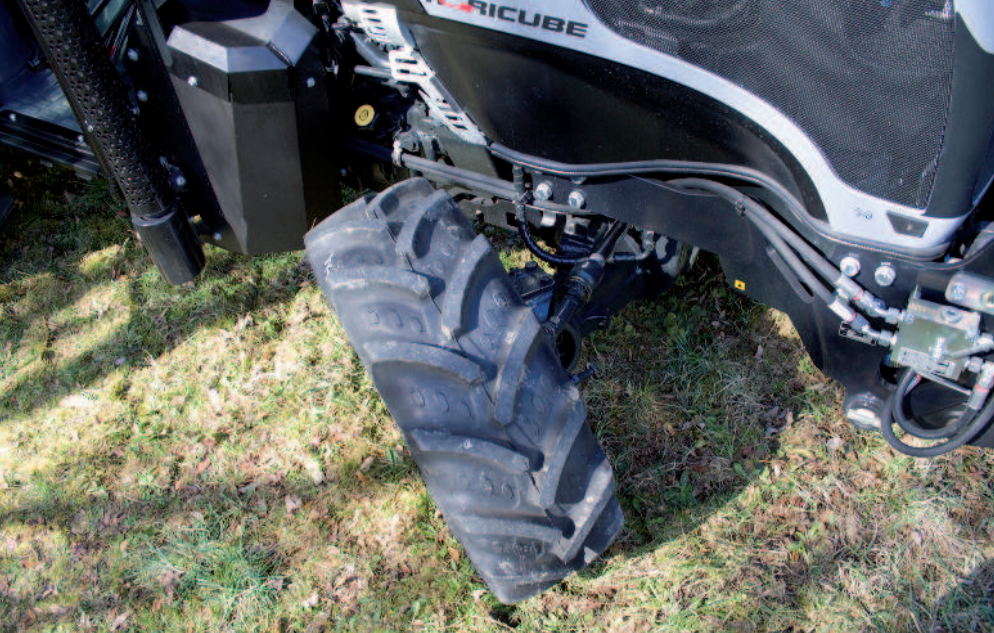
Obr.: Přední náprava Carraro nabízí úhel řízení 55 °.
