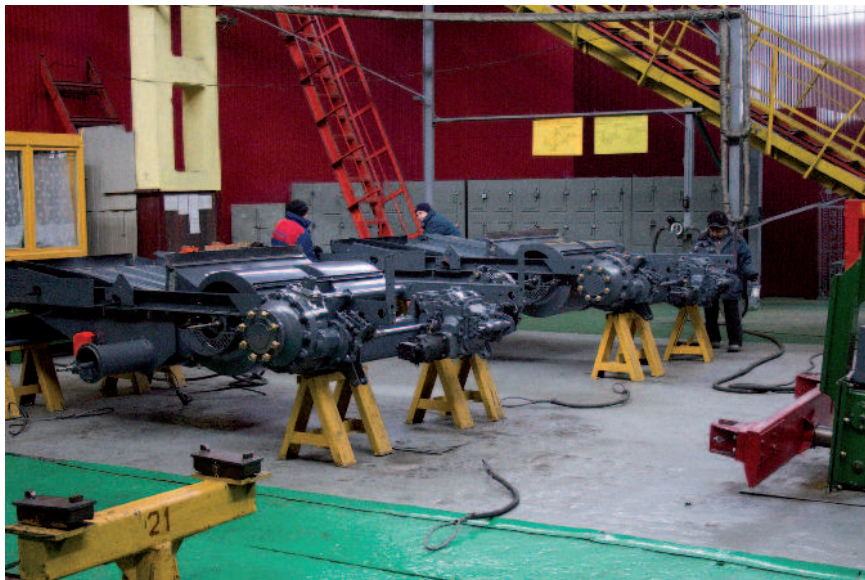
Obr.: Montážní linka na podvozky.
