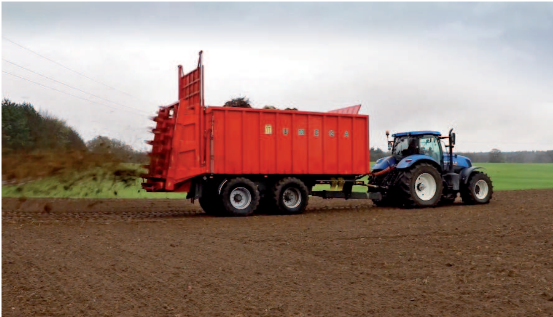
Obr.: Návěs UMEGA PI 20 je určen pro traktory o výkonu zhruba 160 koní. Na obrázku varianta s osazeným rozmetacím adaptérem
