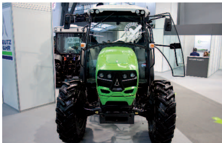
Obr.: Řada 5D Keyline obsahuje čtyři modely o výkonu motoru od 65 k/48 kW do 91 k/71 kW.
