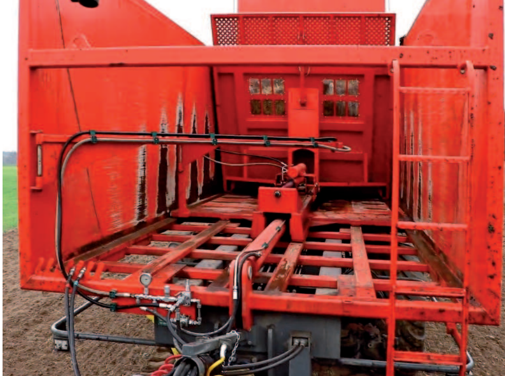
Obr.: Vytlačování materiálu má na starosti výtláčné čelo, jehož posouvání obstarávají trojitě teleskopické hydraulické válce.
