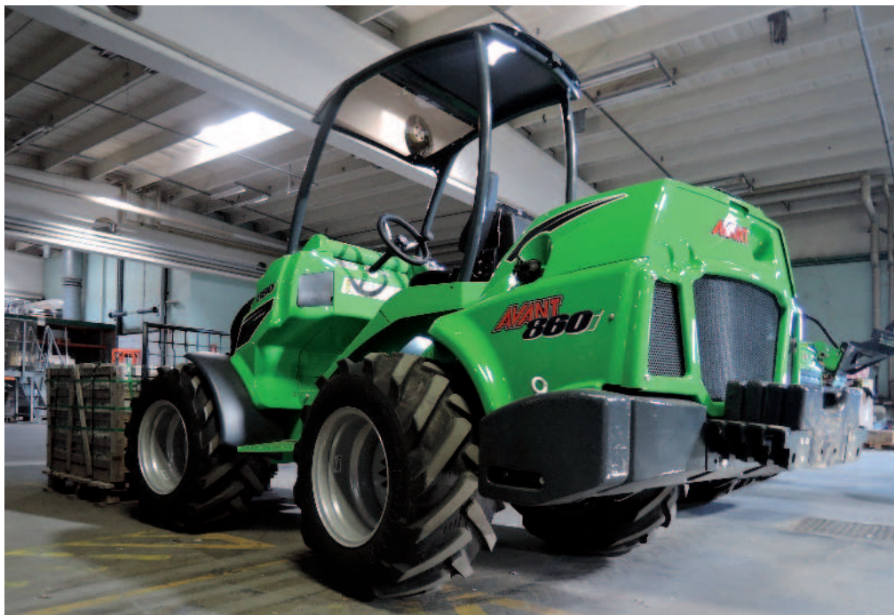
Obr.: Motor spolupracuje s osvědčenou a známou hydrostatickou převodovkou s hnacím hydromotorem v každém kole spolu s dvojicí stupňů rychlosti jízdy.
