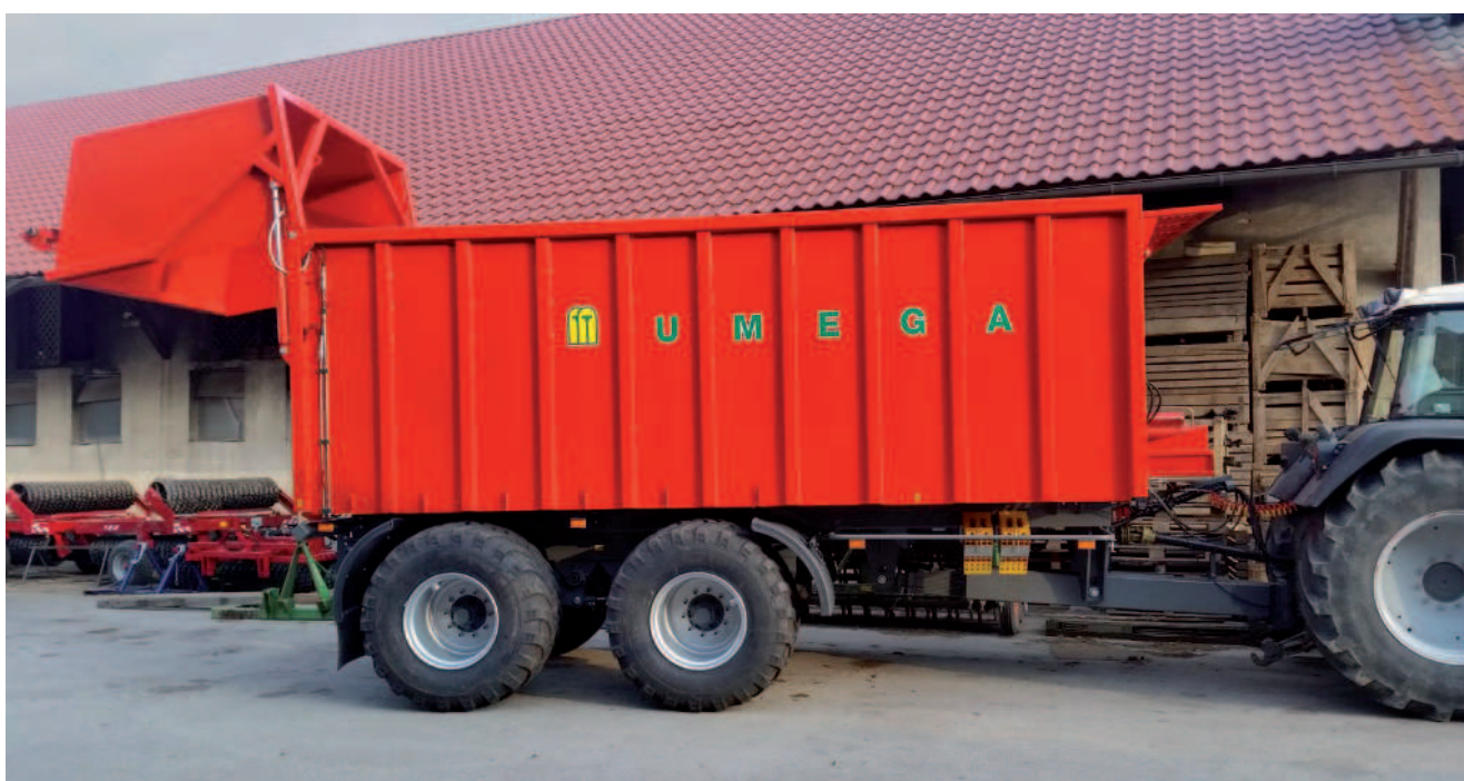
Obr.: UMEGA PI 20 se zadním čelem pro přepravu nejrůznějších materiálů.
