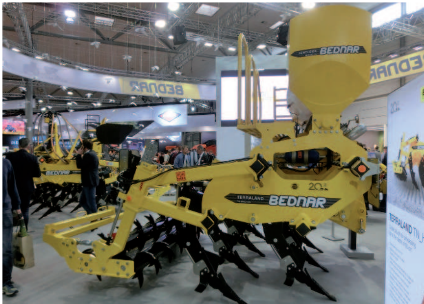
Obrr.: Alternativou k rozmetání může být uložení hnojiva pod patu
