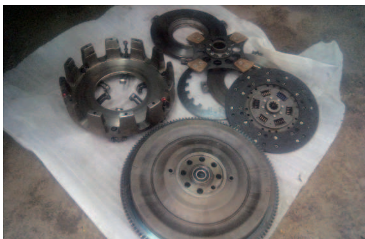
Obr.: Očištěné a odmaštěné části spojky, která toho moc nenažejdila. Naopak unikajícím olejem byla perfektně zakonzervovaná
