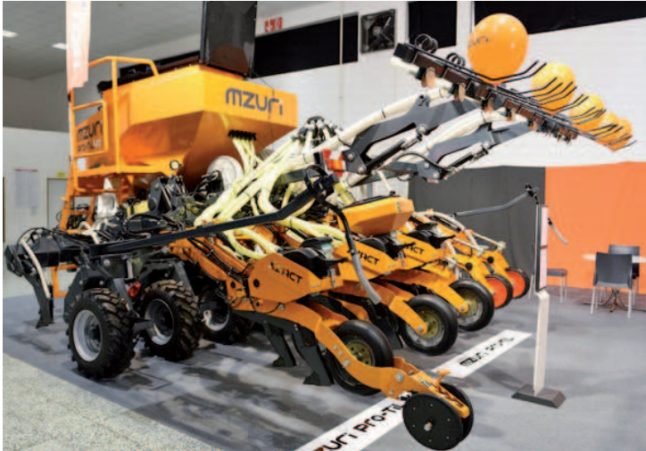
Obr.: Secí stroj MZURI Pro – Til 4T s výbavou Xzact pro výsev v systému pásového zpracování půdy – tzv. strip-till..
