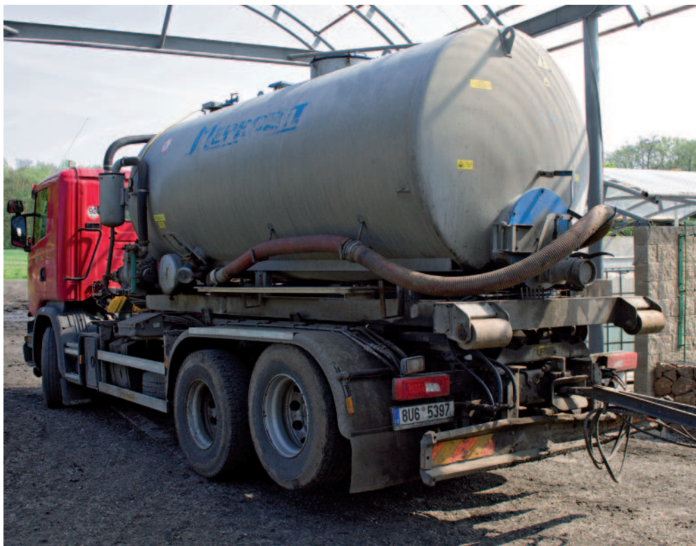
Obr.: Základní výbava zahrnuje pojistný, vypouštěcí ventil (zbohu) a napouštěcí ventil a vývěvu (zezadu).
