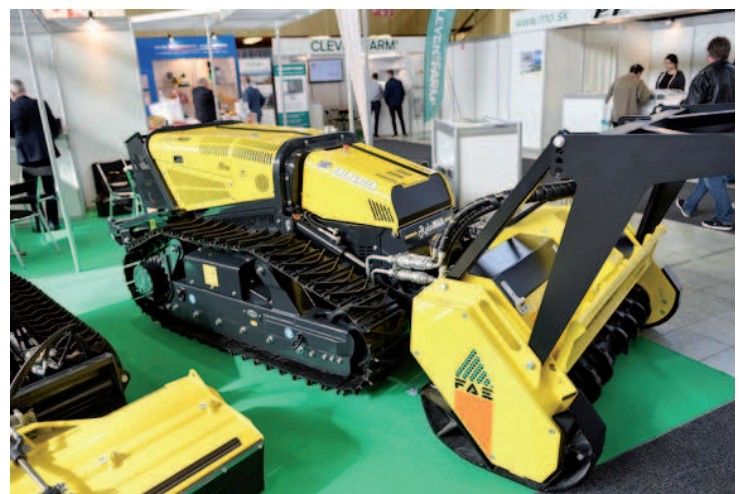
Obr.: Rádiem ovládaný nosič nářadí Energreen RoboMAX s pásovým podvozkem.
