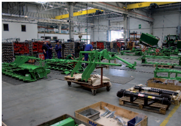
Obr.: Montáž žacích lišt. Na konci jsou větší modely odzkoušeny přímo traktorem.
