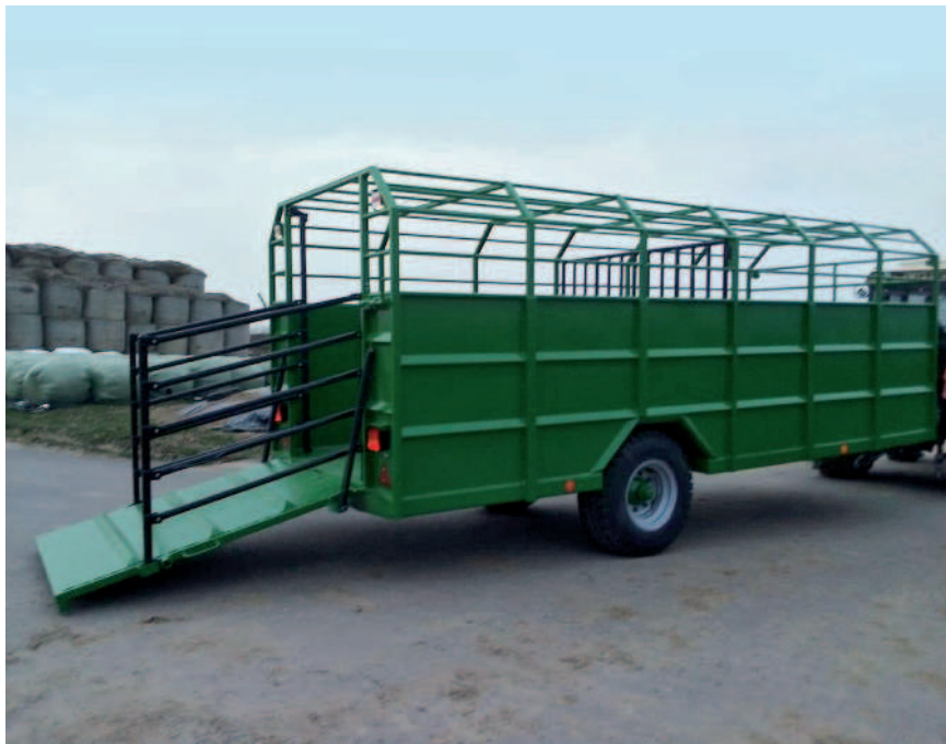
Obr.: Nechybí ani sklopné čelou sloužící ke vstupu a výstupu.
