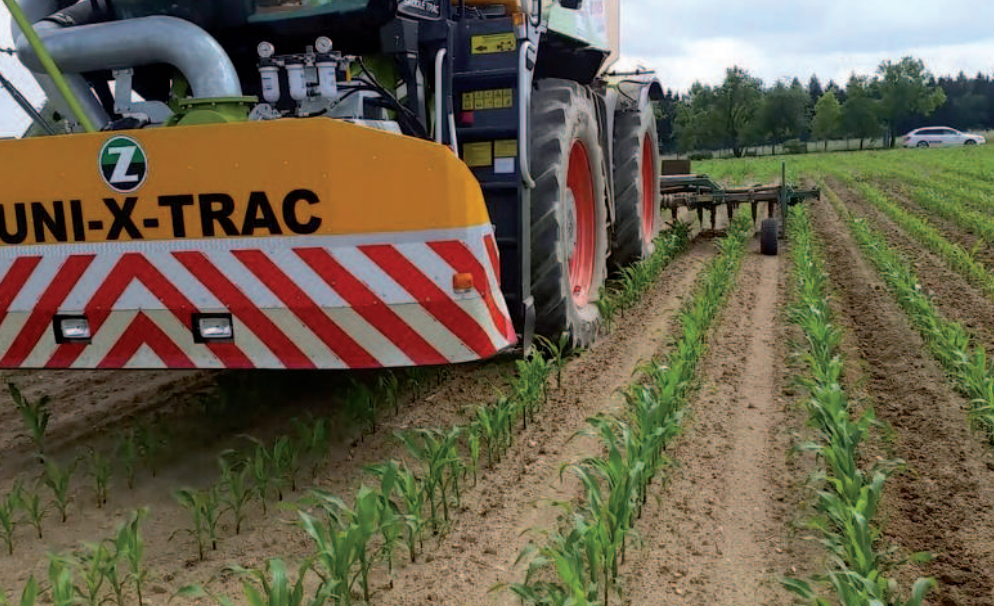
Obr.: Nejvyšší požadavek na přesnost má samotný aplikátor Xerion. Pneumatiky s vysokou únosností se musí vejít do meziřádku.
