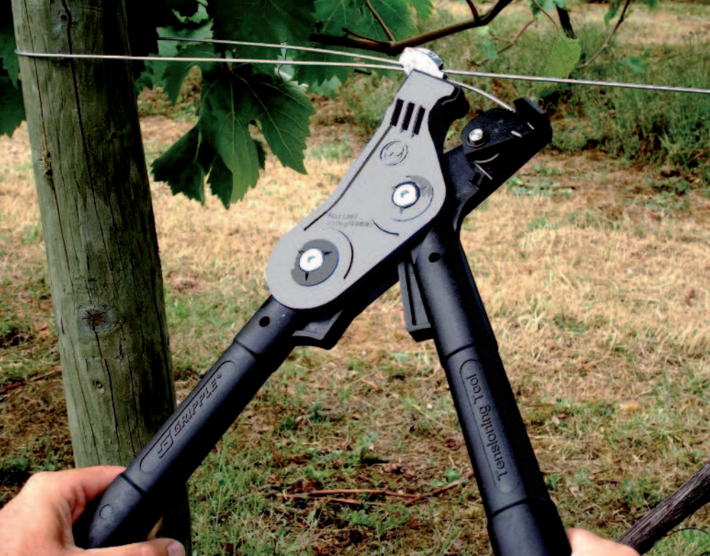
Obr.: Napínací kleště GRIPPLE pracují s drátem či lanem od 1,5 mm do 6 mm a jsou dostupné ve dvou variantách – plastové a kovové.
