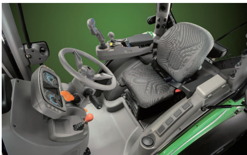
Obr.: Díky kompaktní konstrukci převodovky TTV má kabina rovnou podlahu.
