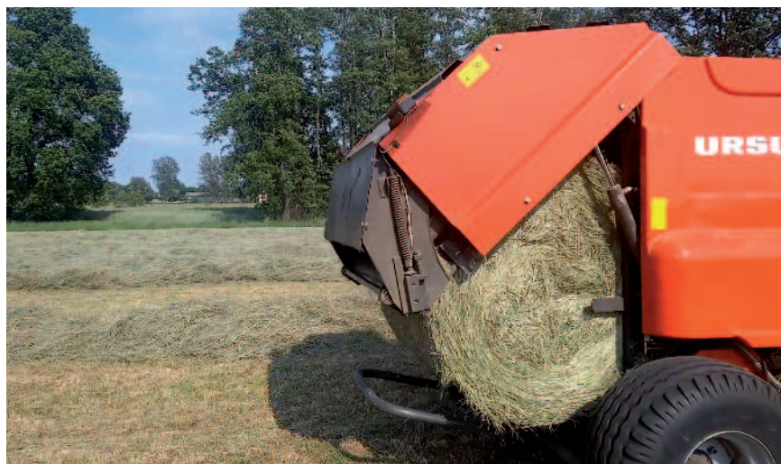
Obr.: Komora lisu je tvořena řetězy s příčkami pro balíky 120 × 120 cm. Pětiramenný sběrač o šířce 185 cm si poradí i s větším objemem hmoty na řádku.
