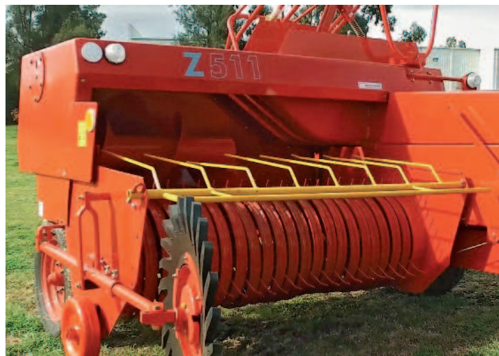
Obr.: Tento lis je velmi nenáročný na výkon traktoru, kdy dostatečný výkon je již 30 k.
