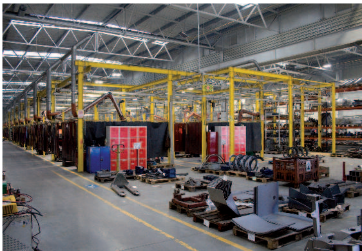
Obr.: Tady probíhá svařování, které je převážně manuální. K dispozici jsou ale i svařovací roboti.
