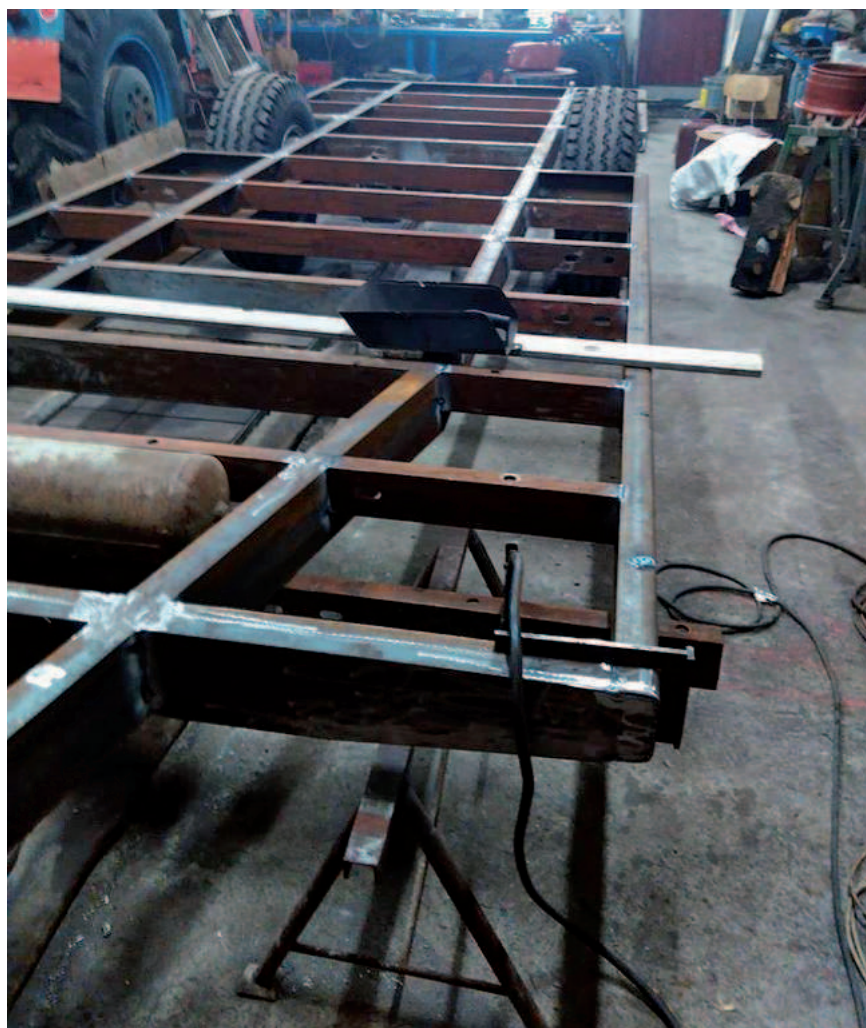
Obr.: Co se týče použitého materiálu, kupovat musel železo a pláště. Vše ostatní včetně nápravy a disků bylo ze zásob.
