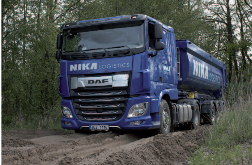
Obr.: Tahač v provedení 6×4 osazený systémem HydroAxle+ je v porovnání s plněpohonnou variantou zhruba o 2 tuny lehčí. Na fotografii souprava společnosti NIKA Logistics
