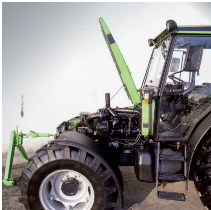
Obr.: Vzduchem chlazené motory Deutz nevyžadovaly příliš mnoho místa, i tak ale byly komponenty co nejefektivněji uspořádány. Fotografie je z roku 1992
