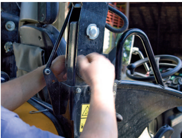
Obr.: Sklápění přístřešku se provádí za pomoci zajišťovacích kolíků
