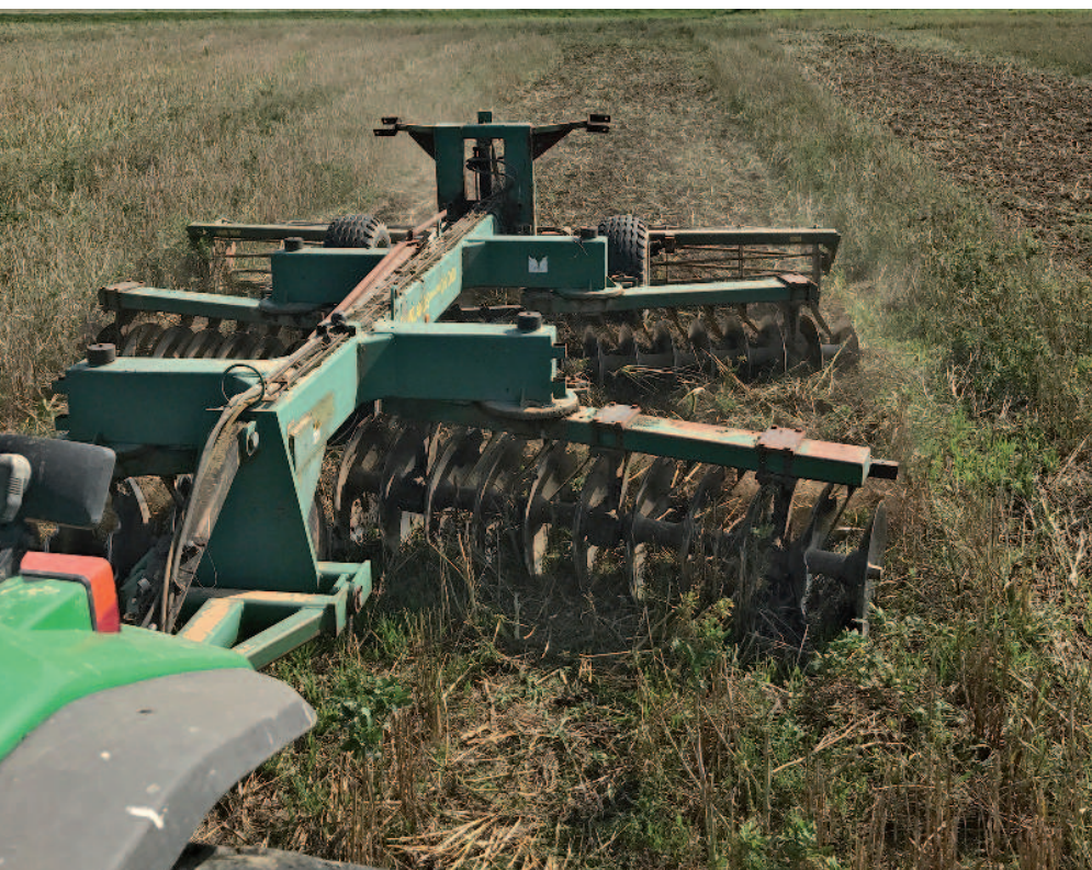
Obr.: Těžké talířové brány Disc Profi X 5000 jsou vhodné pro zpracování půdy
