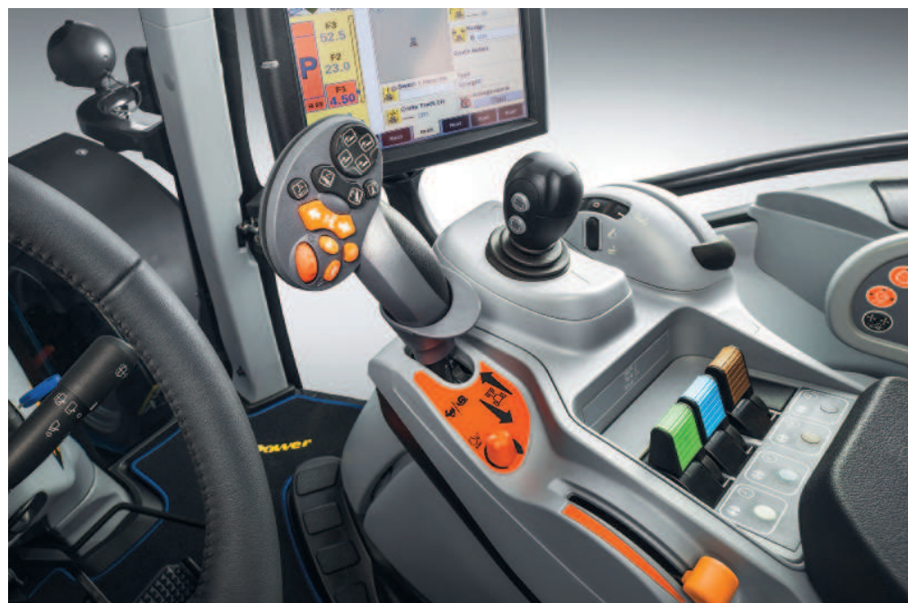
Obr.: Traktor se ovládá za pomoci multifunkční ovládací páky, která je umístěna na multifunkční loketní opěrce, jež je spojena se sedačkou
