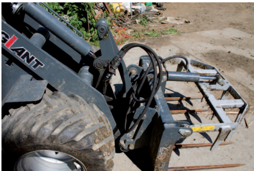
Obr.: Záměna mezi jednotlivými nářadím je velmi jednoduchá a rychlá, a to za pomoci hydraulického upínacího systému
