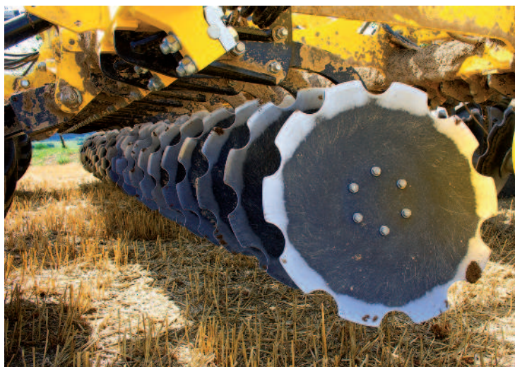
Obr.: Zubaté disky mají rozměry 620 × 6 mm. Ve dvou řadách je jich celkem 48
