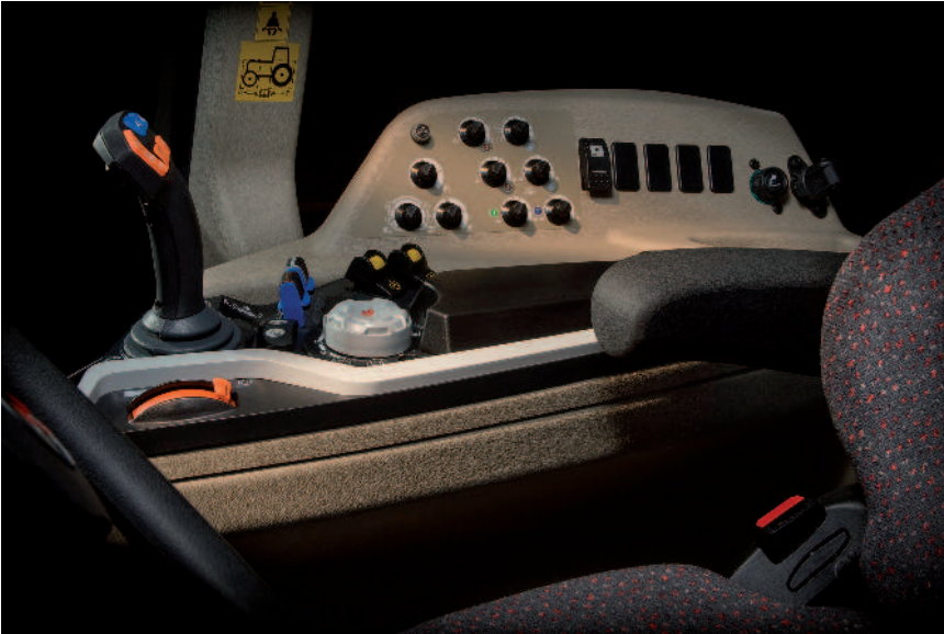
Obr.: Komplexní ovládání převodovky a hydrauliky je také umožněno multifunkčním joystickem MF
