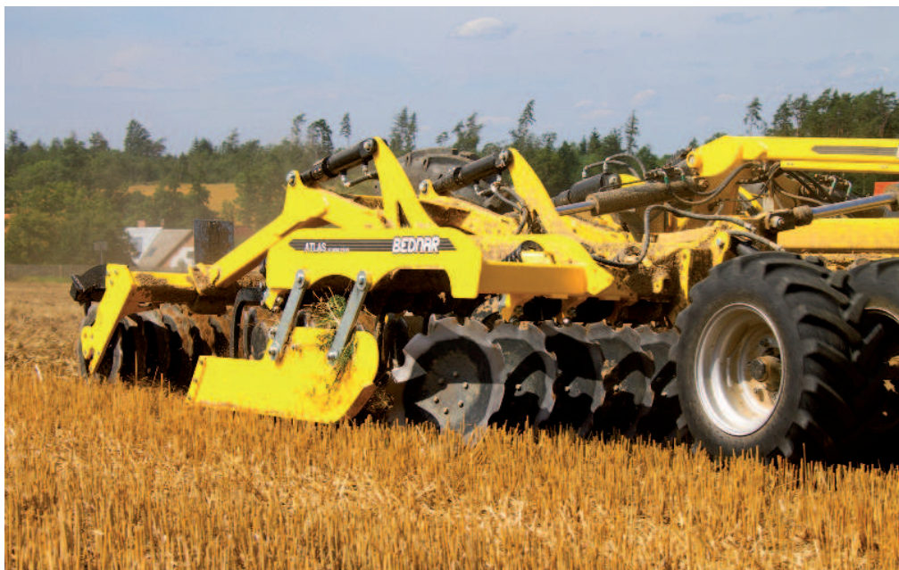
Obr.: Ani extrémně suché podmínky nevadí. Disky přesto lehce vnikají do půdy za podpory celkové hmotnosti stroje
