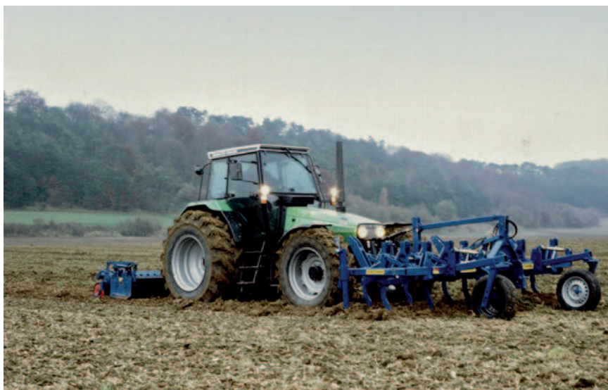
Obr.: Koncepte traktoru usnadňovala používání nářadí agregovaného v předním závěsu. Fotografie je z roku 1993
