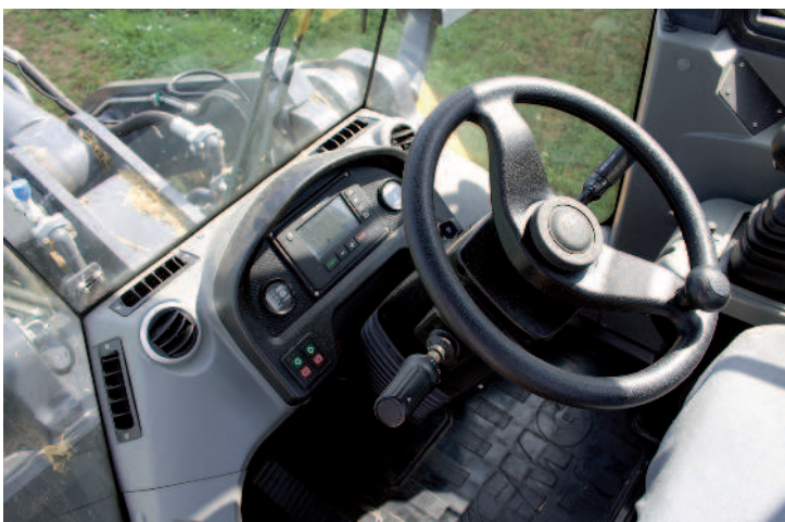
Obr.: Přístrojová deska zobrazuje jen nezbytně nutné údaje o provozu
