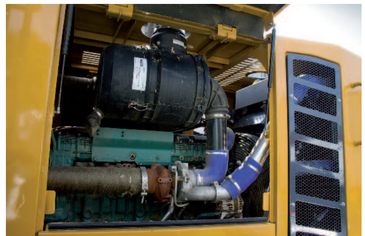
Obr.: Motor má výkonu na rozdávání s 223 koňmi patří tento model mezi největší nakladače využívané v agro sektoru
