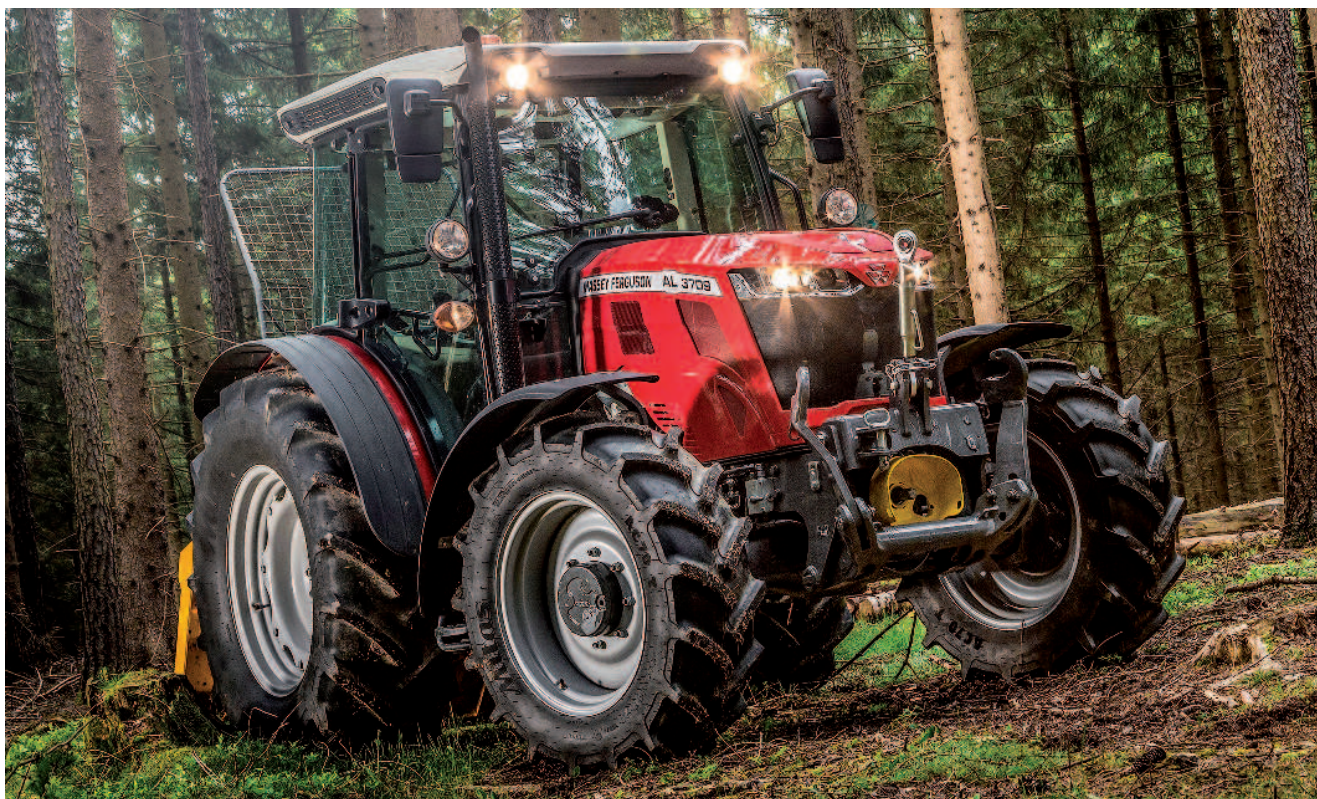
Obr.: Nový podvozek s rozchody od 1 150 mm do 1 908 mm a s rozvorem 2 156 mm umožňuje montáž 30palcových pneumatik a nabízí tak vynikající boční stabilitu
