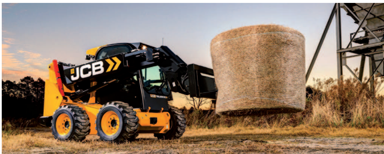
Obr.: Smykem řízený nakladač JCB Teleskid
