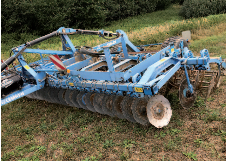
Obr.: Lemken Rubín 9 je polonesený talířový podmítač s průměrem disků 620 mm
