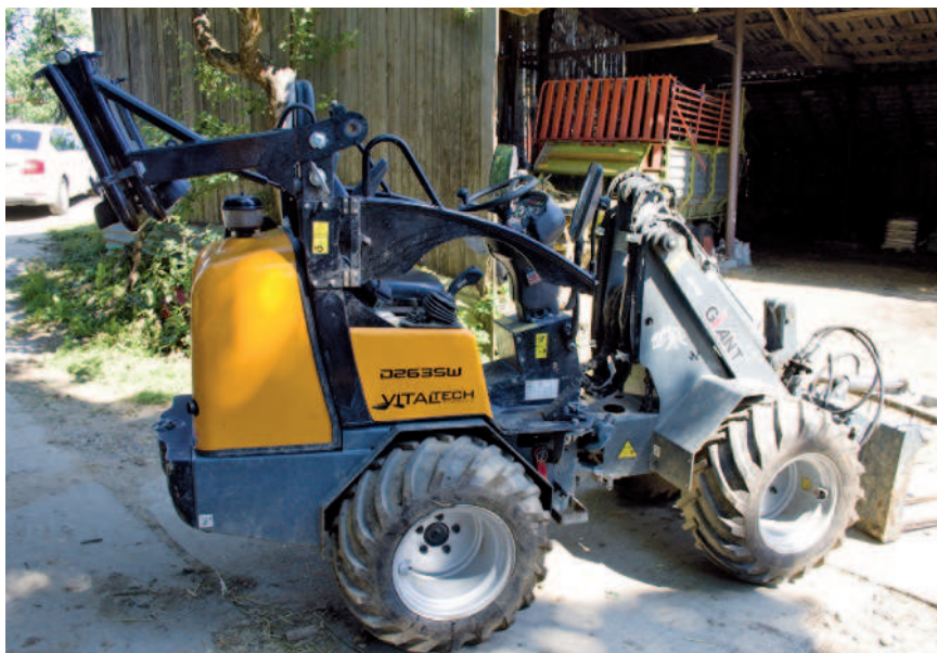
Obr.: Sklopení ochranného příštříšku včetně pracovního osvětlení a zrcátka umožňuje nakladači vjet do chlévů
