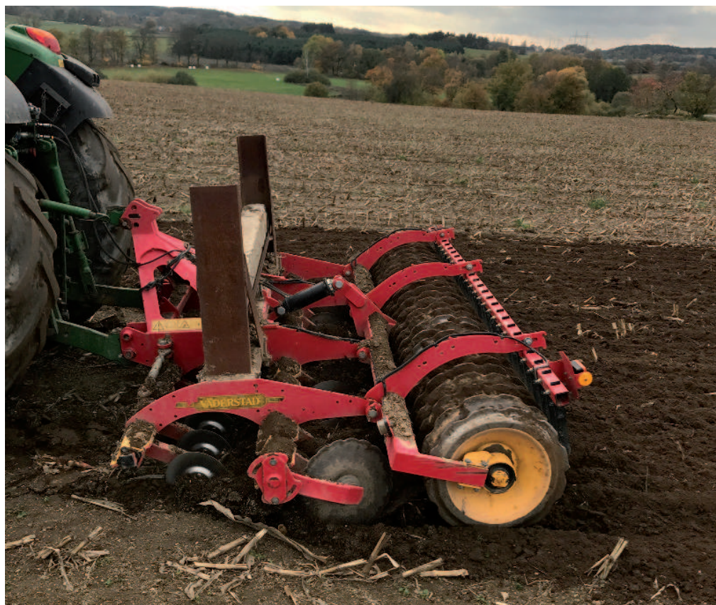
Obr.: Väderstad Carrier CR 350 je nesený talířový podmítač. s disky o průměru 450 mm
