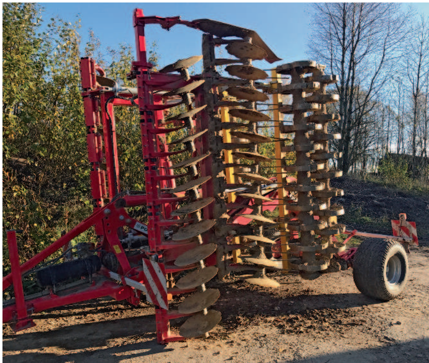
Obr.: Pöttinger Terradisc 6001 T je polonesený talířový podmítač s průměrem talířů 580 mm
