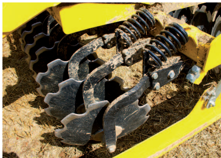
Obr.: Disk uchycený ke slupici. Slupice je uchycena k rámu. Pružina patří k horizontálnímu non-stop jištění
