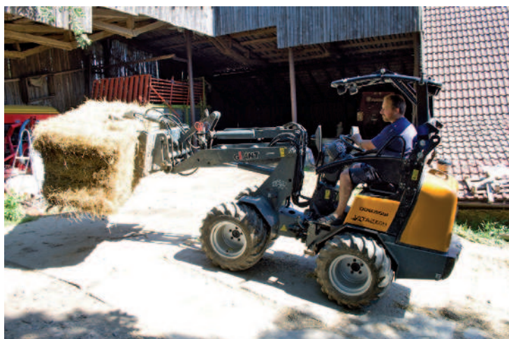
Obr.: Koncepte stroje a 90kg závaží umístěné v zadní části dovolují zvednout až 1 100 kg
