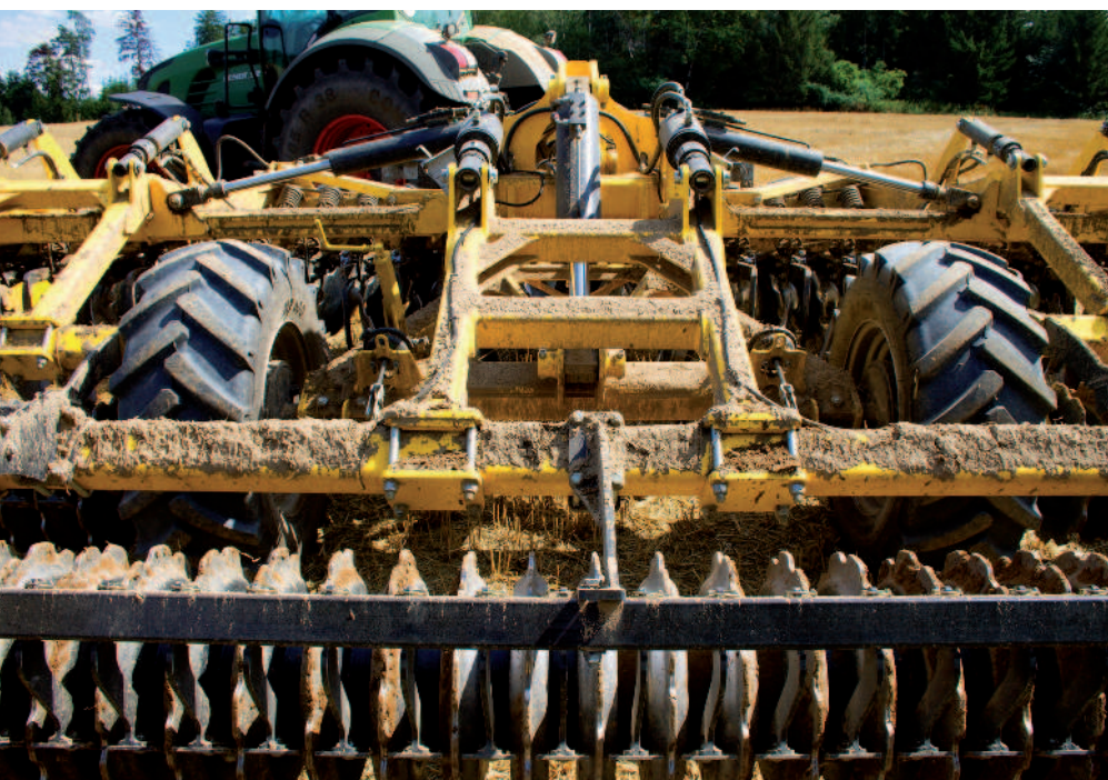
Obr.: Pohled na řešení konstrukce. Dobře jsou vidět pístitnice pro zvedání a odpružení
