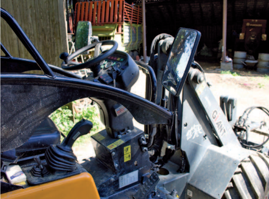
Obr.: Příslušenství a pojezd se ovládá skrze joystick
