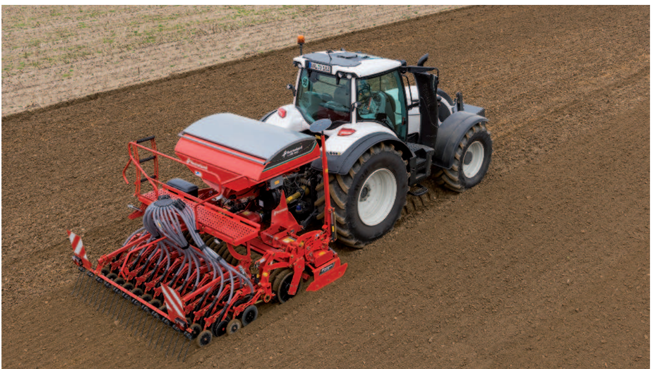
Obr.: Secí stroj e-drill vyniká svou konstrukcí s těžištěm blízko traktoru, takže umožňuje agregaci i s lehčími traktory
