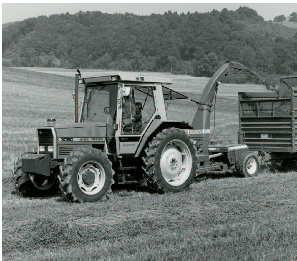
Obr.: Nová kabina byla navržena s důrazem na ergonomii, disponovala dvojicí širokých otevíratelných dveří a třídílným čelním sklem s dvěma tlustými sloupky nesoucími dveře
