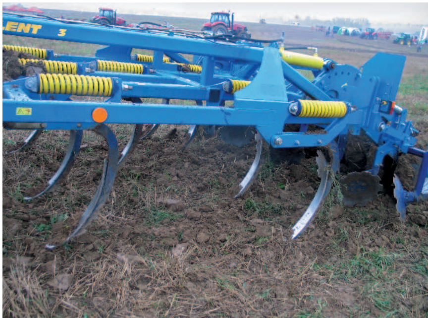
Obr.: Radličkové a dlátové nástroje obecně intenzivněji pracují s půdou
