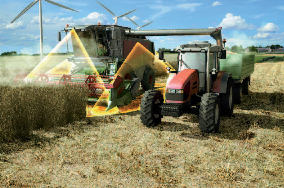
Obr.: Druhá generace inteligentního systému prostorového zobrazení ProViu 360 poskytne řidiči panoramatický pohled na stroj z ptáčí perspektivy v HD rozlišení na dotykovém displeji
