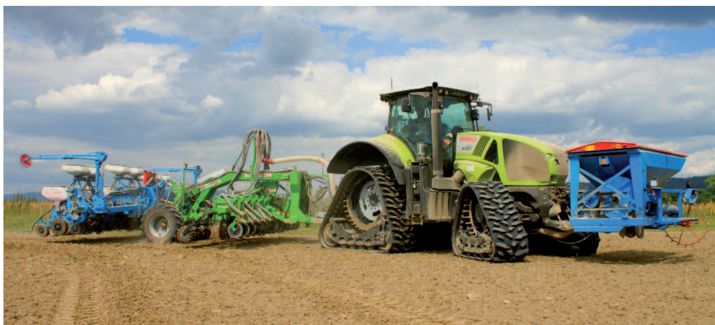
Obř. Souprava, která v současnosti obstarává výsev. Čtyřpásový traktor s poloneseným kypřičem Duro strip-till 2×45, na který je zavěšen secí stroj Monosem NG NG plus M 12×45. V předním závěsu traktoru je zavěšen zásobník Monosem na hnojivo
