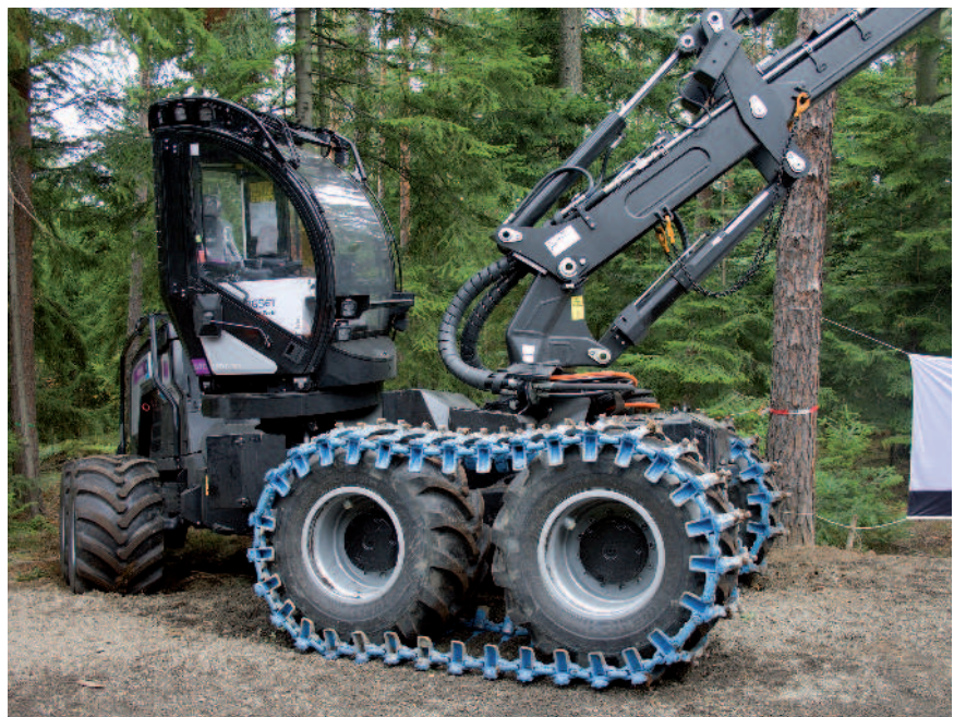
Obr.: Hybridní harvester Logset 8H GTE byl poprvé představen v květnu 2019 ve Finsku a je druhým harvestorem Logset, který používá hybridní technologii k pohonu
