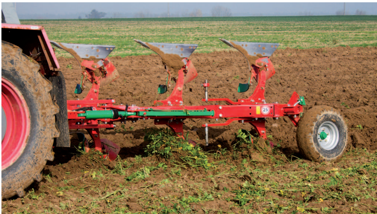
Obr.: Tříradličný pluh AGRO-MASZ PO3
