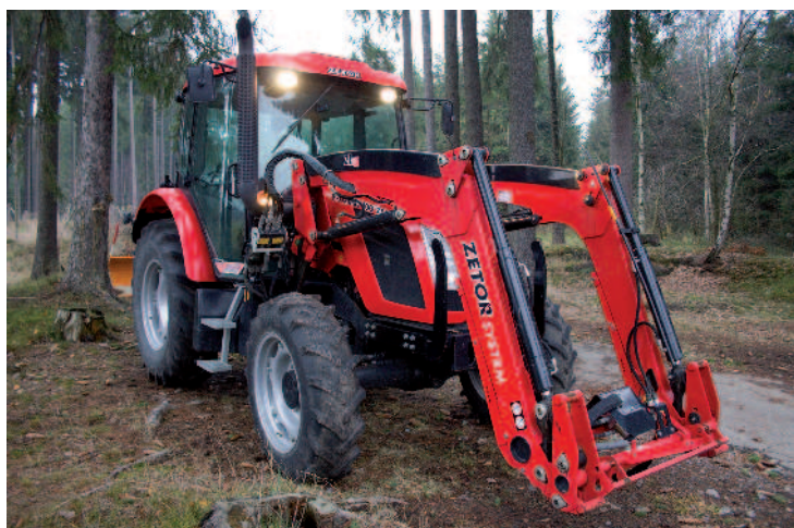
Obr.: ZL46 má speciálně zkosený výložník a tvarování pro lepší pevnost, tuhost a výhled na nářadí
