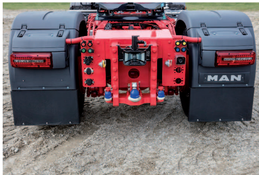
Obr.: Zadní strana vozidla MAN TGS 18.510 4x4 BLS je uzpůsobena pro agregaci zemědělských strojů a návěsů
