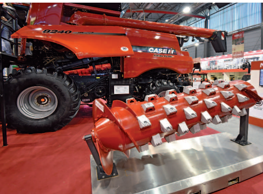
Obr.: Axiální rotor mlátiček Case IH Axial-Flow, na pozadí je nasvícené jeho umístění ve stroji
