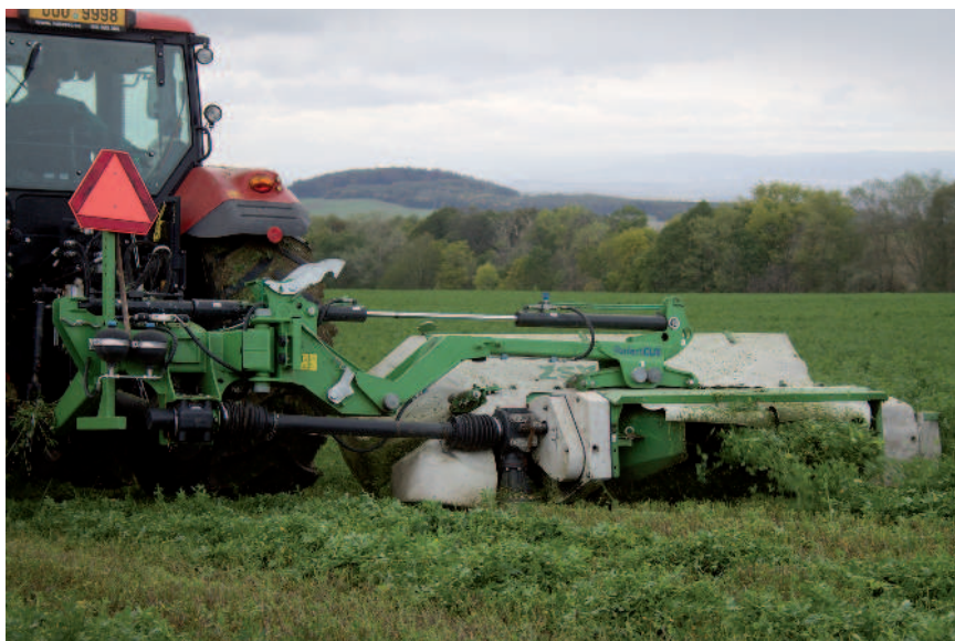
Obr.: Zadní diskový žací stroj KT 260W s hydropneumatickým odlehčením za traktorem Zetor Forterra 140
