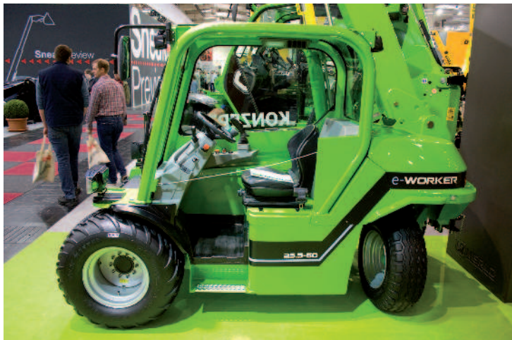
Obr.: Firma Merlo prezentovala novou řadu elektrických teleskopických manipulátorů E-Worker šetrnou k životnímu prostředí a se zmenšenými rozměry. Elektrické nakladače jsou převážně určeny do uzavřených prostor, jako jsou stáje či sklady
