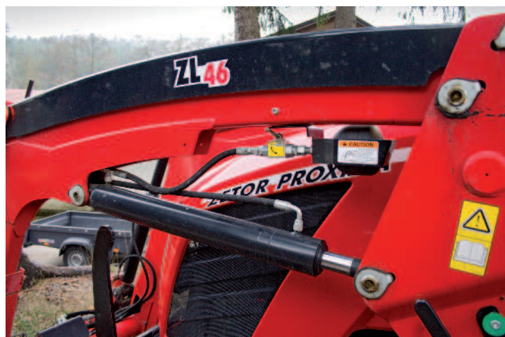
Obr.: Nakladač lze přes originální mechanismus jednoduše demontovat
