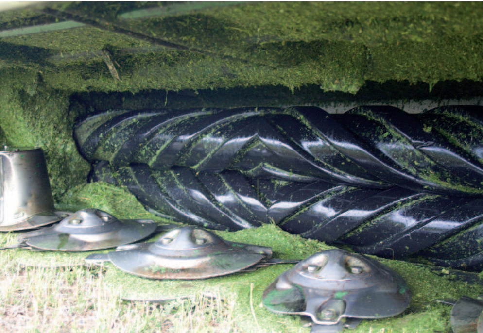
Obr.: Profil mačkáčeho válce je do písmene V, takže drážky do sebe zapadají a posečený materiál mačkají velkou intenzitou
