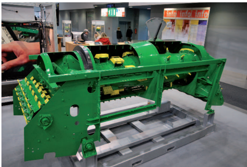
Obr.: Rotorový mechanismus John Deere pro evropské mlátičky řad S je vyráběn v tuzemském Agrostroji Pelhřimov
