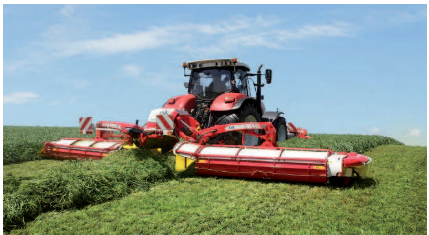
Obr.: Ukládat hmotu až z 10 metrů je nyní možné bez použití kondicionéru i během sečení, a to daleko šetrnějším způsobem
