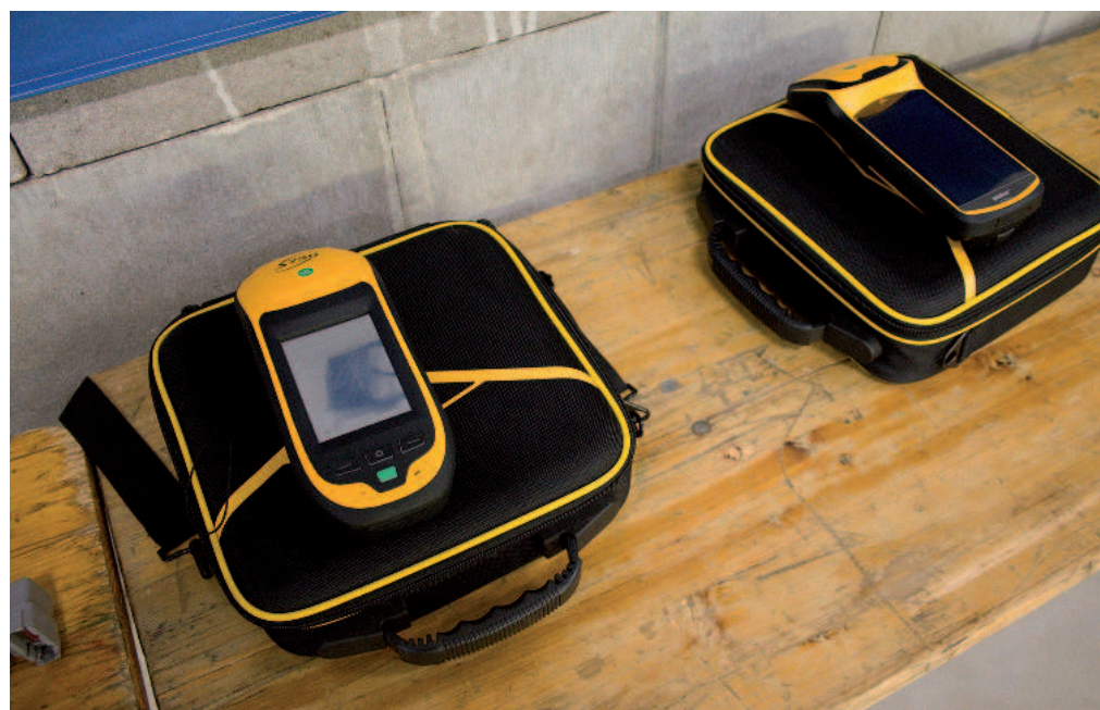
Obr.: Ruční GPS přístroje pro snadné vyměřování půdních bloků v terénu
