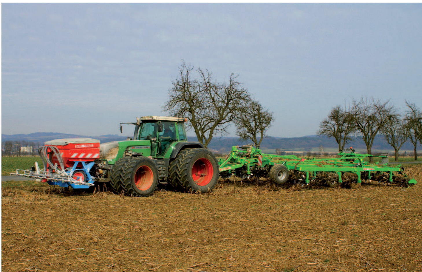
Obř. Souprava, která připraví půdu před setím řepky. Podmítač Duro France Compil a v předním závěsu traktoru je zavěšen zásobník Monosem s aplikační rampou od Duro France
