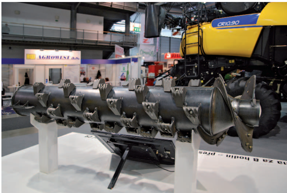
Obr.: Mlátičky New Holland mají dva rotory umístěné vedle sebe, na snímku jeden z nich. V pozadí vrcholový model CR 10.90
