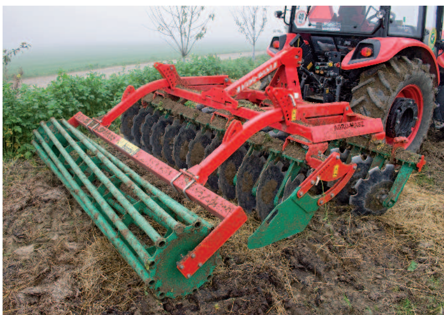
Obr.: Nesený diskový podmítač AGRO-MASZ BT30 s třímetrovým pracovním záběrem
