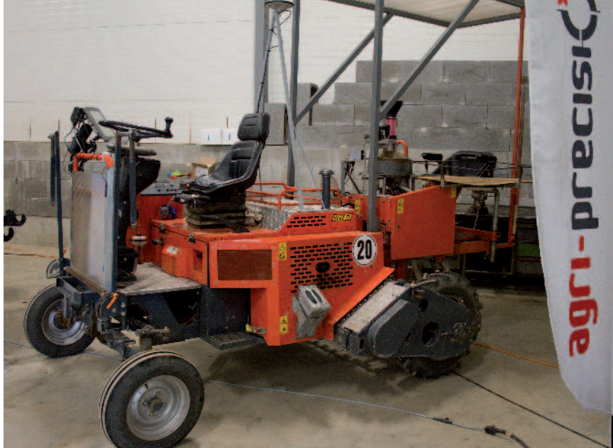
Obr.: Speciální vozítko určené pro zakládání porostů na pokusných parcelách
