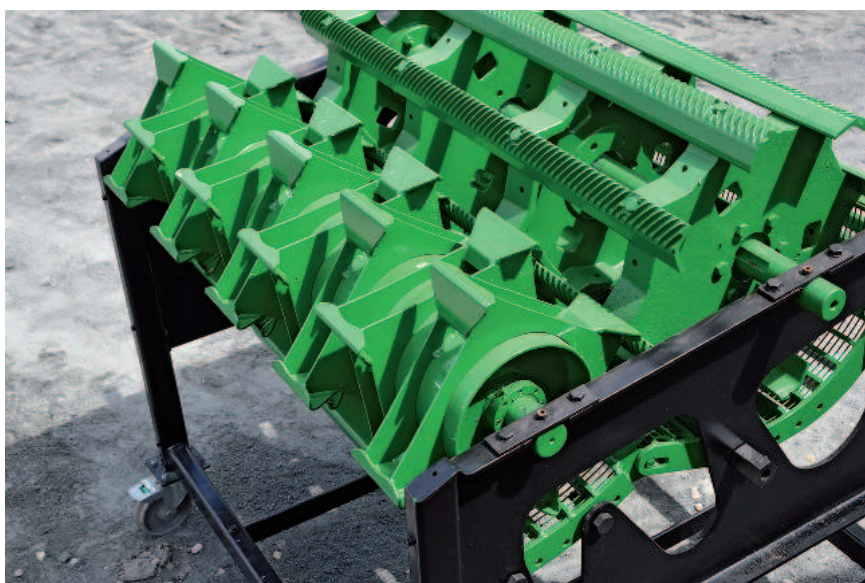
Obr.: Tangenciální mláticí soustava s předmláticím bubnem mlátiček Sampo Rosenlew a John Deere W PTC
