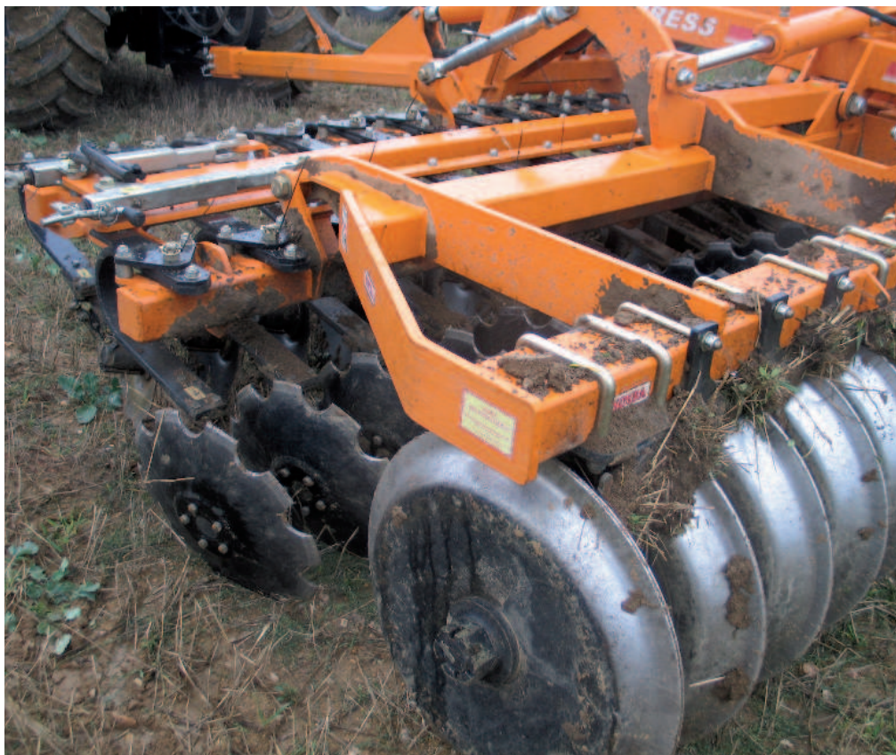
Obr.: Za talíři lze využít celou řadu válců pro úpravu povrchu
