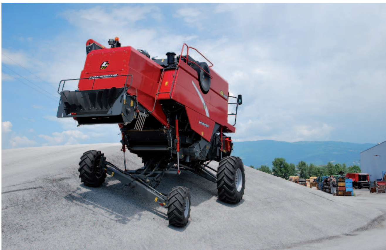
Obr.: Speciální mlátička Laverda ALrev s naklápacími hydraulicky řízenými paralelogramovými nápravami vyniká extrémní svahovou dostupností
