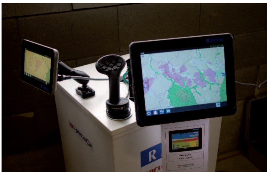
Obr.: Vlevo polní počítač s optickým naváděním a vpravo pokročilý polní počítač Raven CR12. Uprostřed joystick pro ovládání různých funkcí přípojně zemědělské techniky
