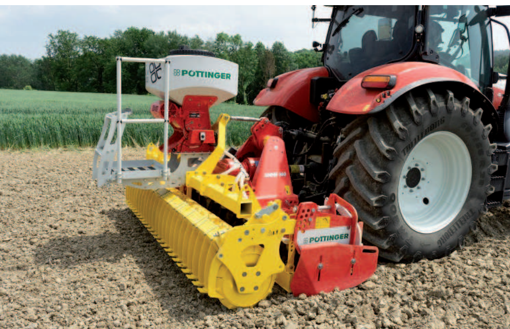
Obr.: Výsevní zařízení instalované na rotačních branách Lion
