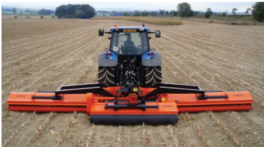
Obr.: Perfect vyrábí mulčovače na pole i do sadů či vinogradů. Od malých speciálů do úzkých sponů až po 9m trojkombinace pro velké plošné výkony
