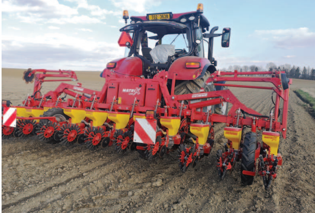
Obr.: BV Technika je prodejcem strojů GRIMME. Na fotografii vidíme 12řádkový mechanický přesný secí stroj MATRIX 1200 pro výsev řepky či řepy
