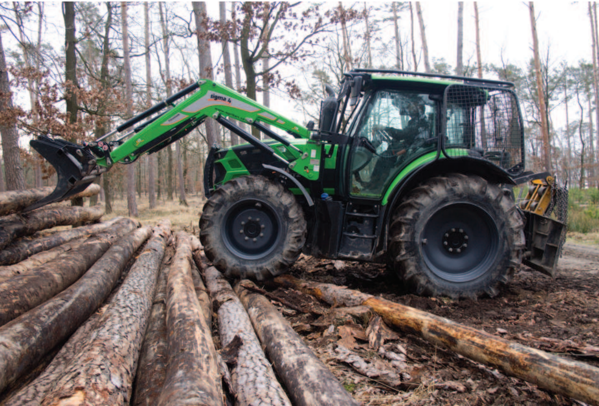
Obr.: Rampovací nakladač dovoluje navalování kmenů do výšek
