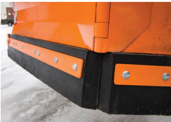
Obr.: Zákazník si může vybírat až ze šesti typů břitů (gumový, ocelový, kombinovaný apod.). Jejich životnost se pohybuje v řádu let
