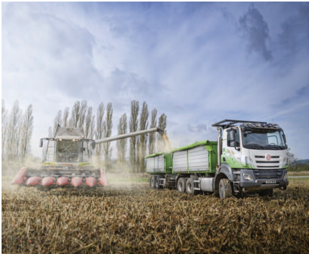
Obr.: Díky unikátnímu podvozku a automatické převodovce Allison zvládají agrotahače Tatra i ten nejtěžší terén. Flotační pneumatiky se systémem centrálního dohušťování zmírňují měrné tlaky na zemědělskou půdu
