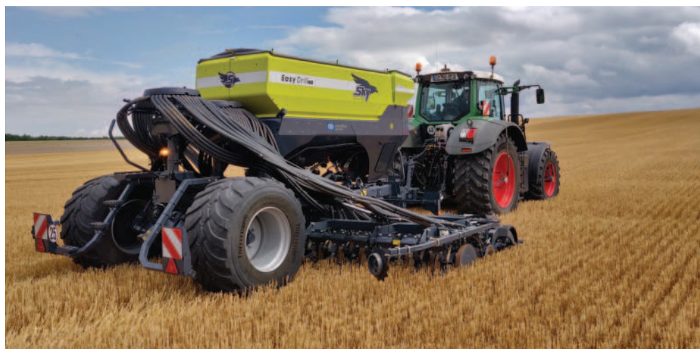
Obr.: Easy Drill – secí stroj primárně určený do technologie NO-TILL, tj. setí do nezpracované půdy jako je strniště, meziplodina, případně minimálně zpracovaná půda
