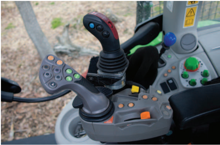
Obr.: Šedý joystick slouží k ovládní funkcí traktoru včetně pojezdové rychlosti a černý joystick k ovládní rampovačích nakladače
