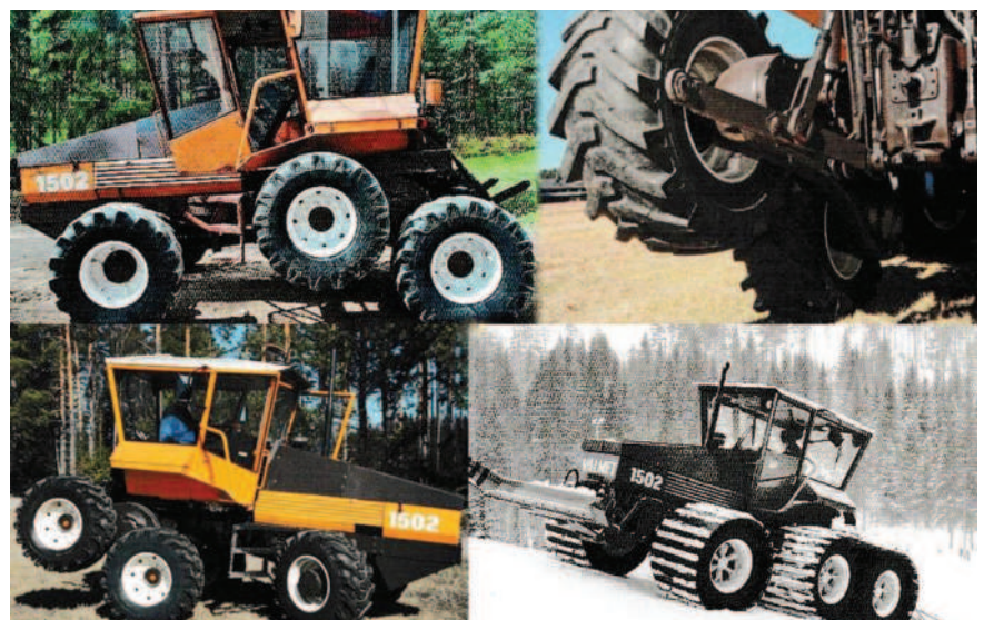
Obr.: Jednu ze dvou zadních náprav šlo zvednout. Všechny nápravy používaly pneumatiky o rozměru 13,6-24
