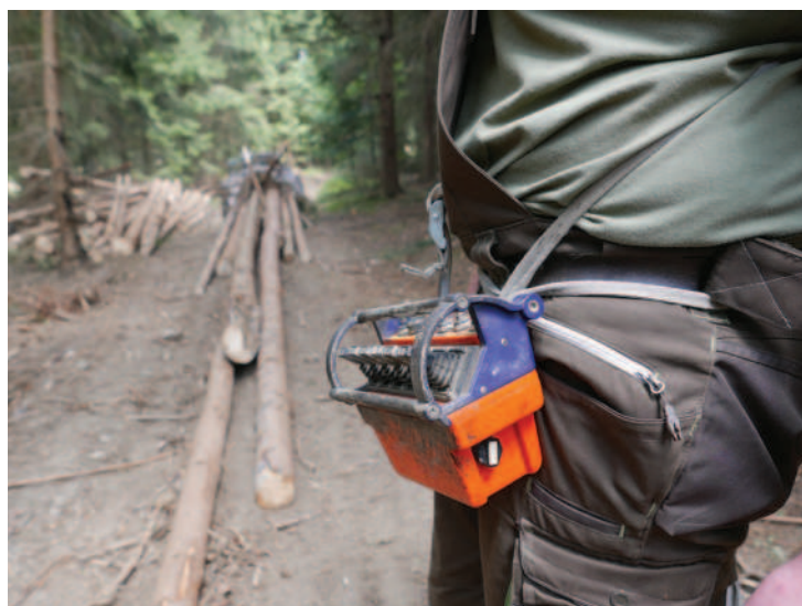
Obr.: Rádiové ovládání zaručuje rychlou reakci na zadané pokyny s dosahem signálu v lesním terénu běžně i 200 metrů
