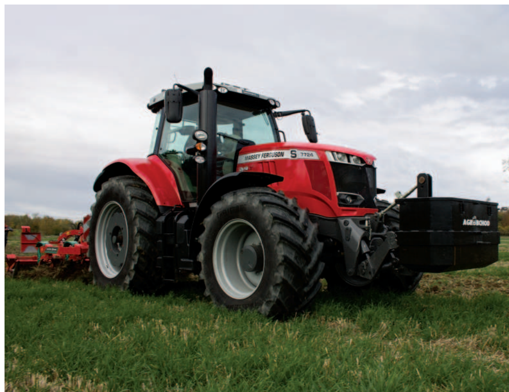
Obr.: Traktor na fotografii je vybaven převodovkou Dyna-VT s plynule proměnným převodovým poměrem
