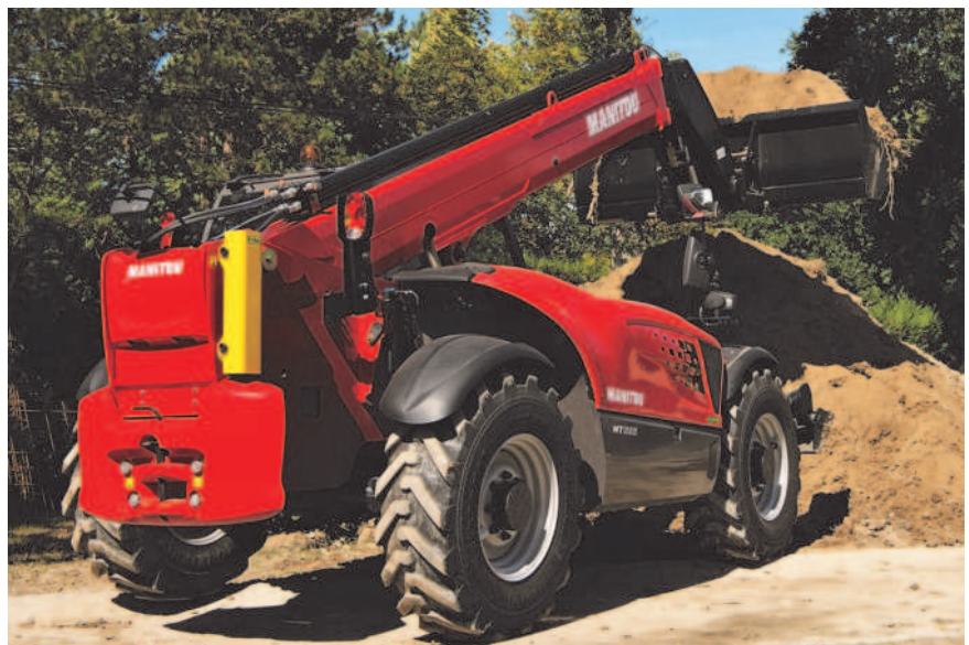
Obr.: Pro plně elektrický Manitou MT 1135 se používá 360V elektrický systém a 60kW elektromotor
