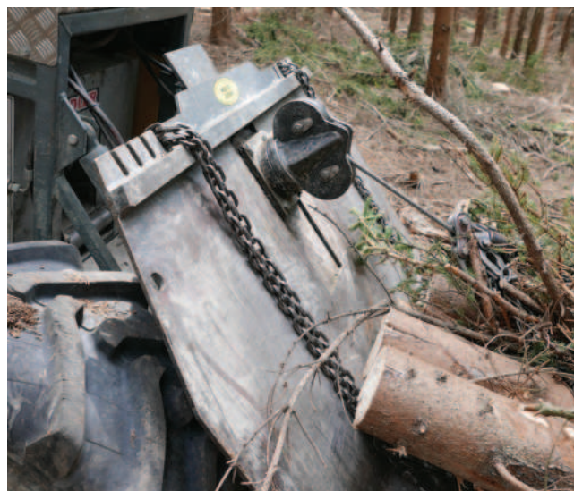
Obr.: Pohon navijáku je hydraulický s plynulou regulací vpřed a vzad
