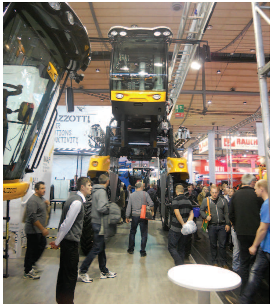
Obr.: U samojízdných postřikovačů lze dosáhnout extrémní světlé výšky i pro ošetřování vysokých porostů
