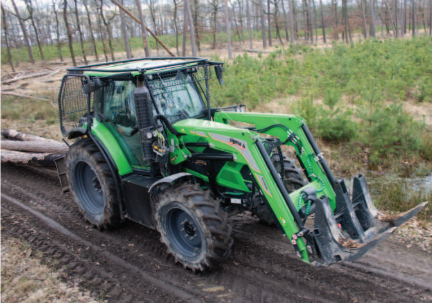
Obr.: Plynulá převodovka s řadou režimů a módů zefektivní soustředování dříví. Motor reaguje okamžitě a poskytuje vysoký točivý moment již od velmi nízkých otáček
