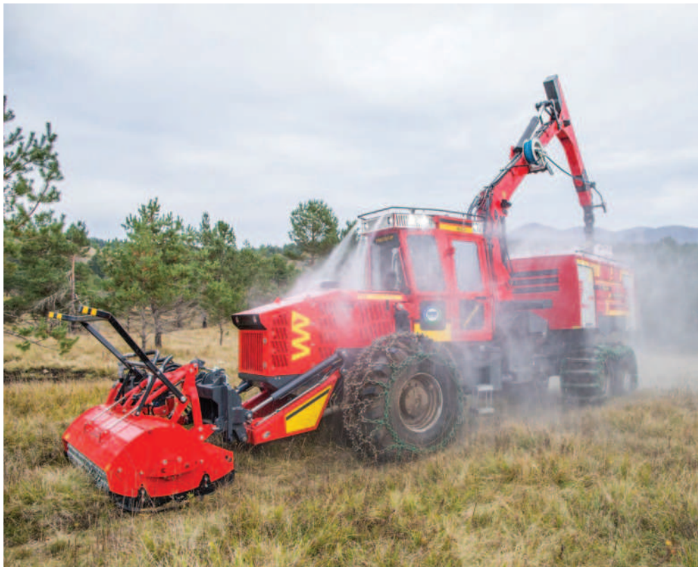
Obr.: Okolo celého stroje jsou umístěny trysky vytvářející vodní clonu
