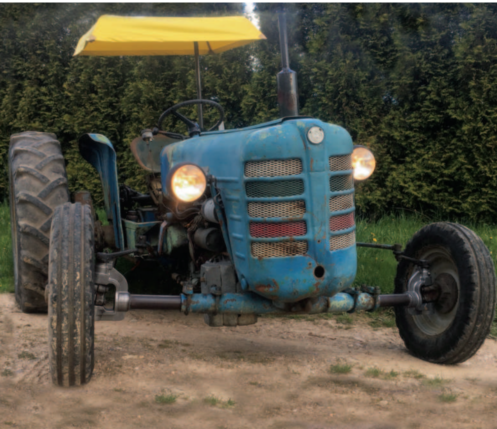
Obr.: Pan Myšák se v roce 2017 pustil do výroby traktoru Z3017. Základ tvoří klasický typ Z3011. Před renovací traktoru byla otestována přední náprava z druhovýroby
