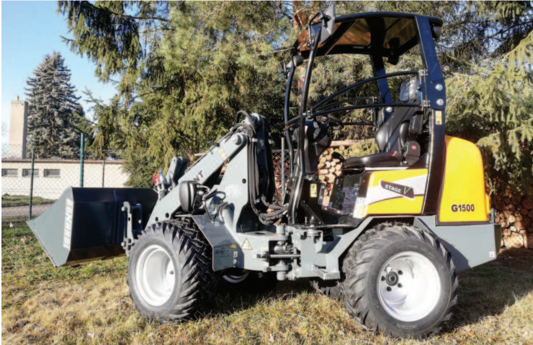
Obr.: Model G1500 X-TRA má průjezdnou výšku 1,95 m, výšku zdvihu 2,07 m a uzvedne až 1 500 kg
