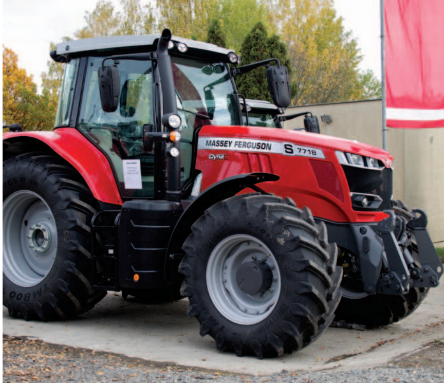
Obr.: Traktory řady MF 7700 S používají renomované motory AGCO Power. Model na fotografii je vybaven převodovkou Dyna-6, která umožňuje hladké řazení 6 rychlostních stupňů (Dynashift) v každém ze čtyř rozsahů převodů
