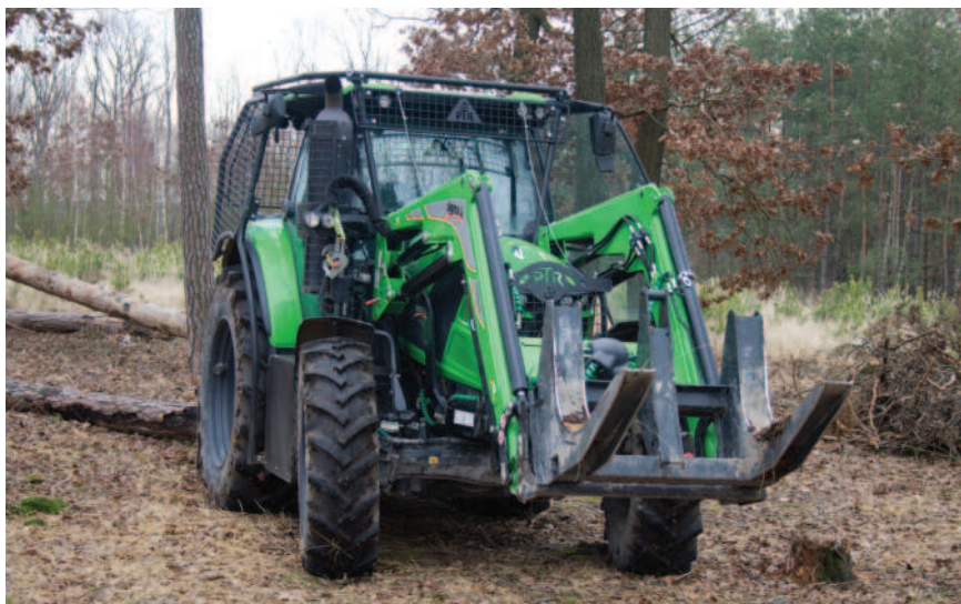
Obr.: Traktor je vybaven odpruženou přední nápravou. Dvojitelné ovládání kolmo uložených pístů odpružení maximalizuje pohodlí a bezpečnost při práci v lese i při jízdě na silnici
