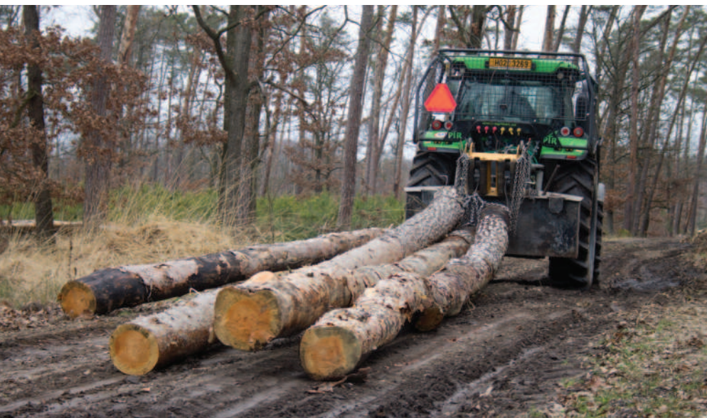
Obr.: Naviják má sílu 2×6 tun a dle obsluhy traktoru utáhne čtyři až pět kubíků dubu a třeba i sedm tun borovicového dřeva
