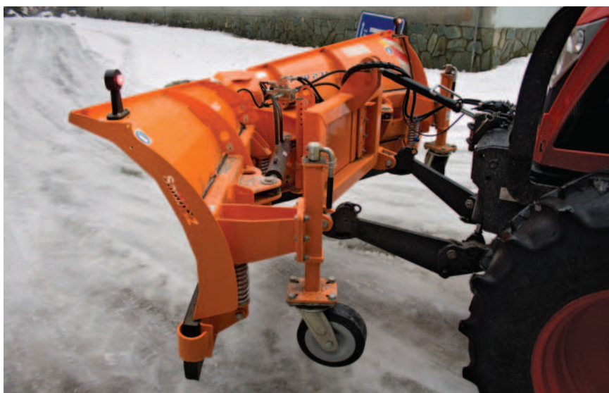
Obr.: Břity se při nárazu na překážku sklopí (díky pružinám hlídajícím tlak)
