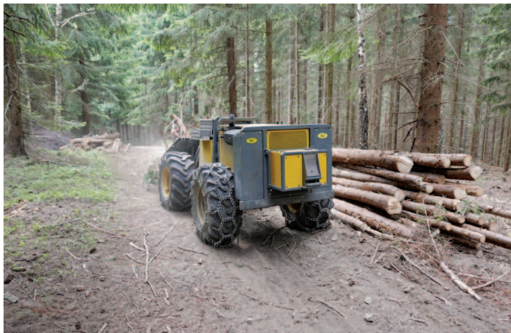
Obr.: Stroj je osazený diesellovým motorem Yanmar o výkonu 65 koní
