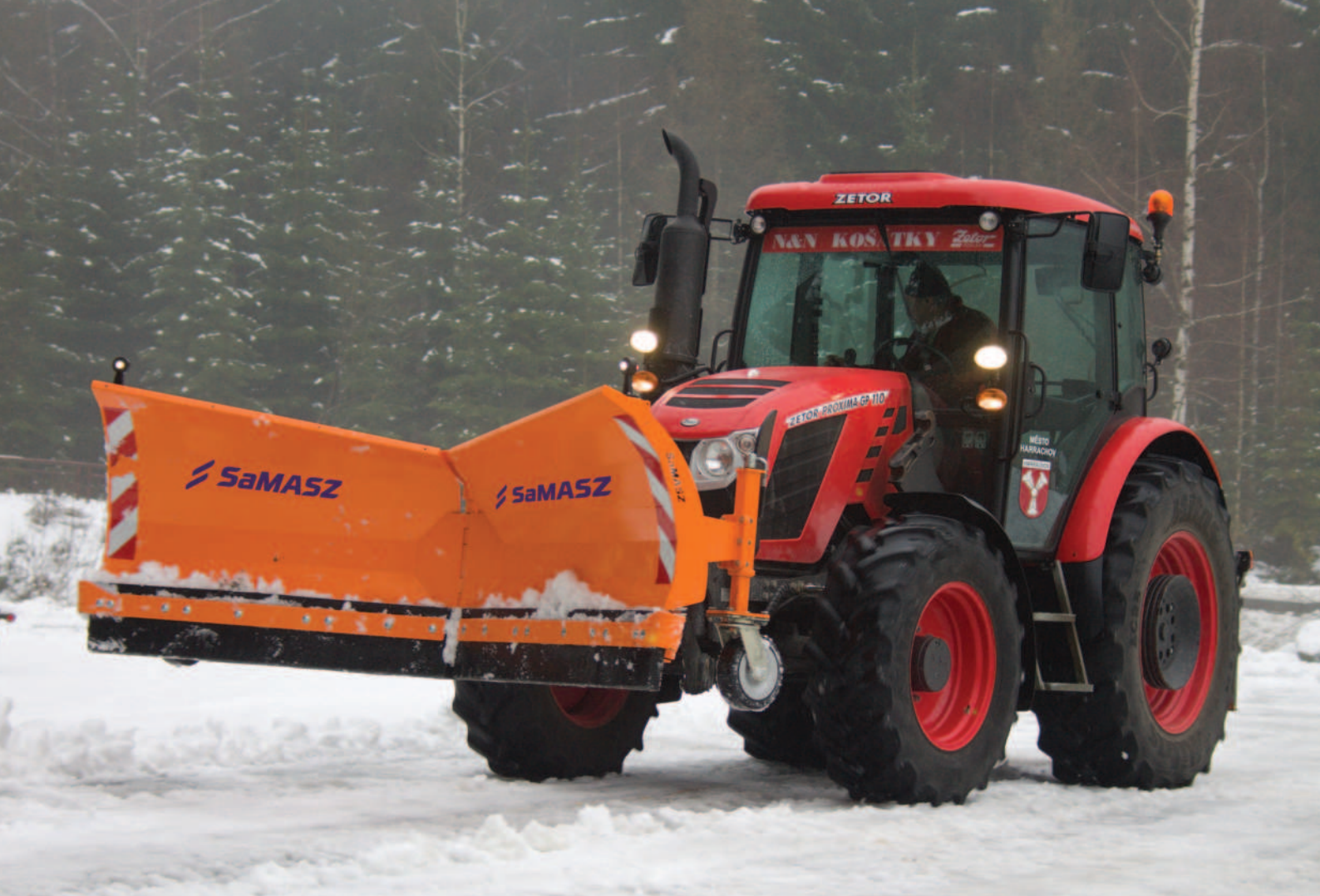
Obr.: Obsluha si může odhrnovačky radlice nastavit do jakékoliv polohy (obě nezávisle na sobě)
