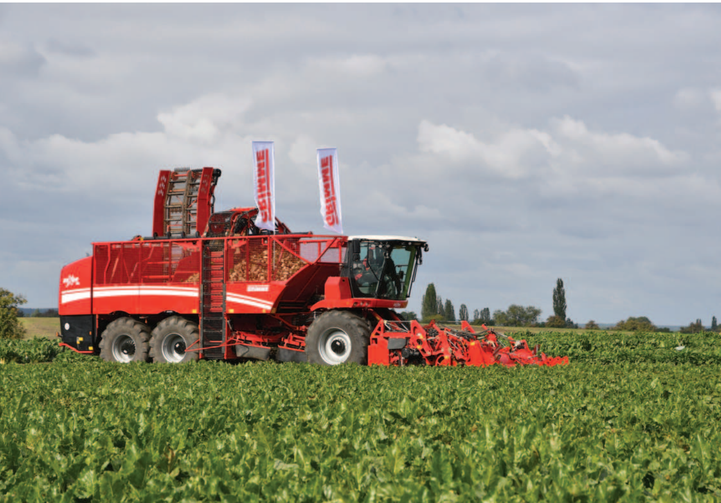
Obr.: Grimme Rexor 630 může být vybaven vyorávacími koly nebo radlicemi
