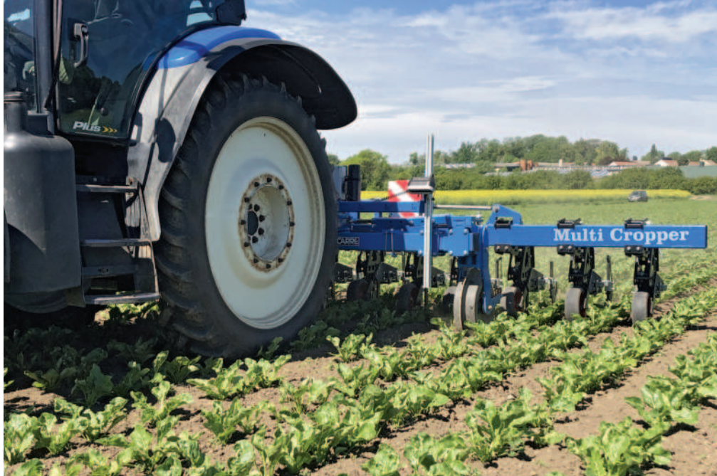
Obr.: Komerční systém navádění meziřádkového kypřiče Multi Cropper ve vzadu neseném provedení redukuje riziko poškození porostu vlivem nepřesné dráhy pracovních nástrojů ve směru jízdy a přináší větší komfort pro obsluhu
