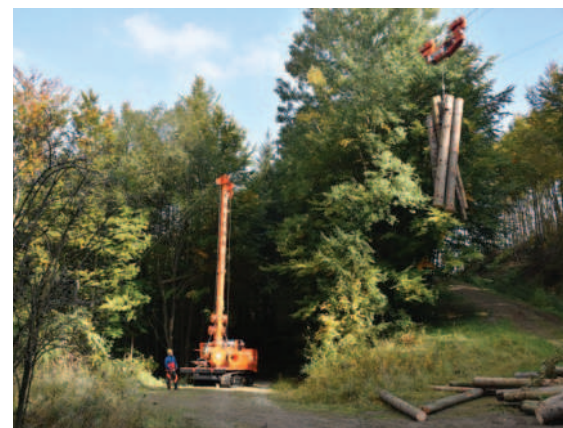
Obr.: MM Forsttechnik vyrábí i procesorovou lanovku Wanderfalke vyvinutou pro malé až středně velké kmeny
