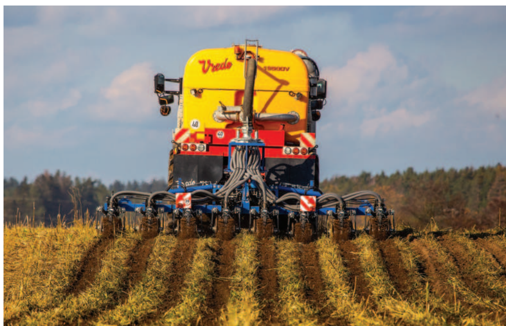
Obr.: Muck Tiller v agregaci za samojízdným aplikátorem Vredo
