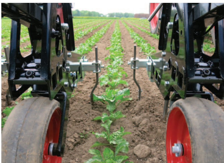
Obr.: Multi Cropper – cílem je tvarovat dno zpracovaného pásu půdy a na povrchu vytvořit hrubší půdní strukturu
