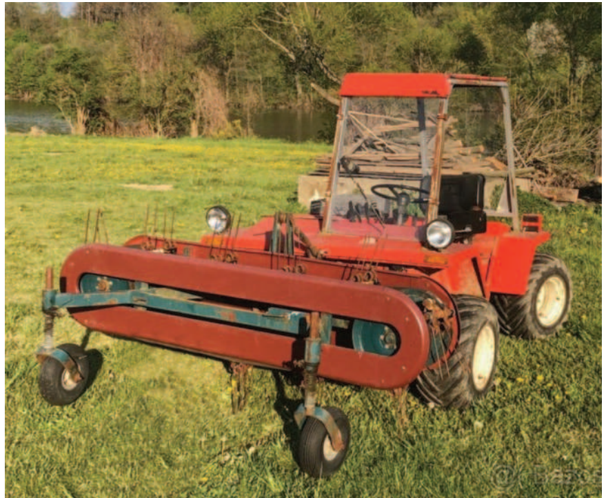
Obr.: Svahový traktor Reform Metrac 2002 se často využívá jako obraceč píce (ilustrace)
