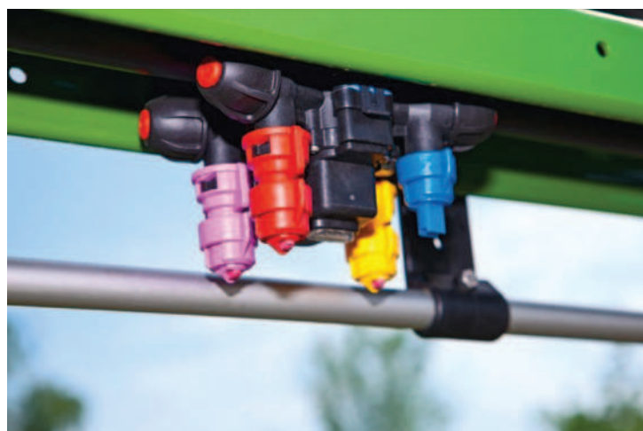
Obr. 2: Elektrické řazení různých kombinací trysek
