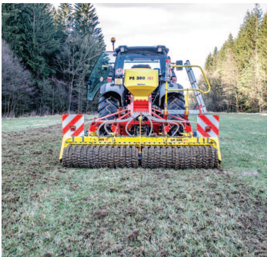
Obr.: Přísev do porostu s následným utužením zadním válcem
