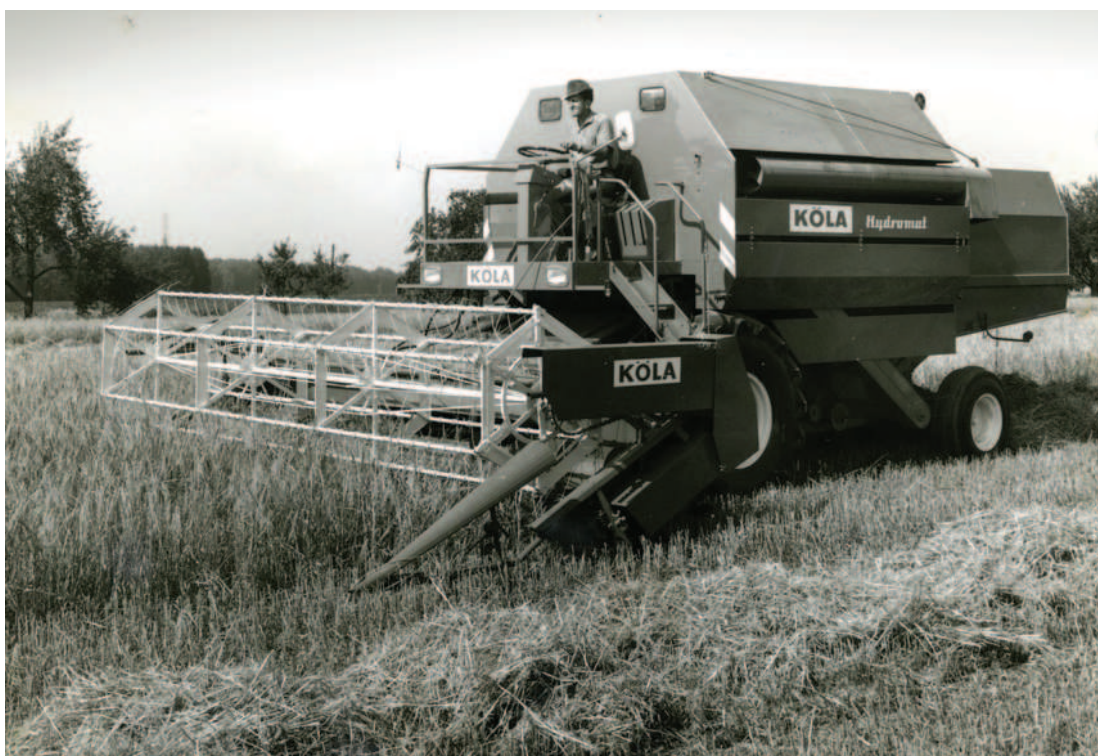
Obr.: Kōla Hydromat s hydrostatickým pohonem na fotografii někdy z let 1966–1969
