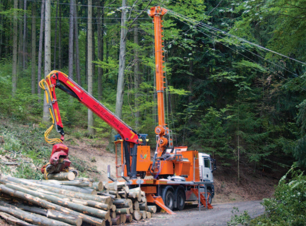
Obr.: Lesní lanovka Syncrofalke 3toK na podvozku nákladního automobilu MAN TGS 33.460 6x6 BB EURO 6 o výkonu 460 koní
