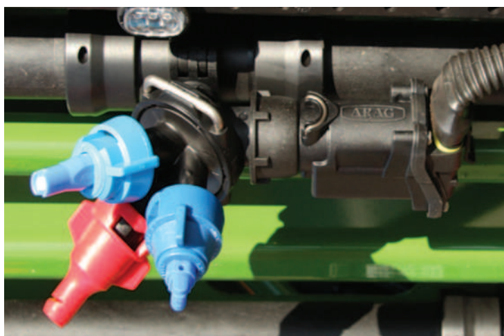
Obr. 1: Manuální volba třicestným přepínáním trysek
