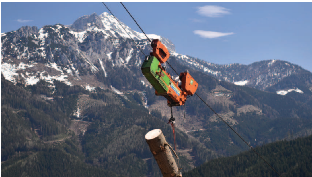
Obr.: Univerzální vozík MM-Sherpa. Elektrickým modulem lze dodatečně vybavit všechny stávající vozíky
