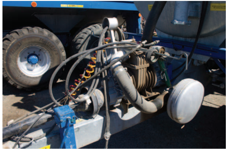
Obr.: U větších cisteren Meprozet (vlevo) má čerpadlo průtok 11 000 l/min a u menších 9 000 l/min
