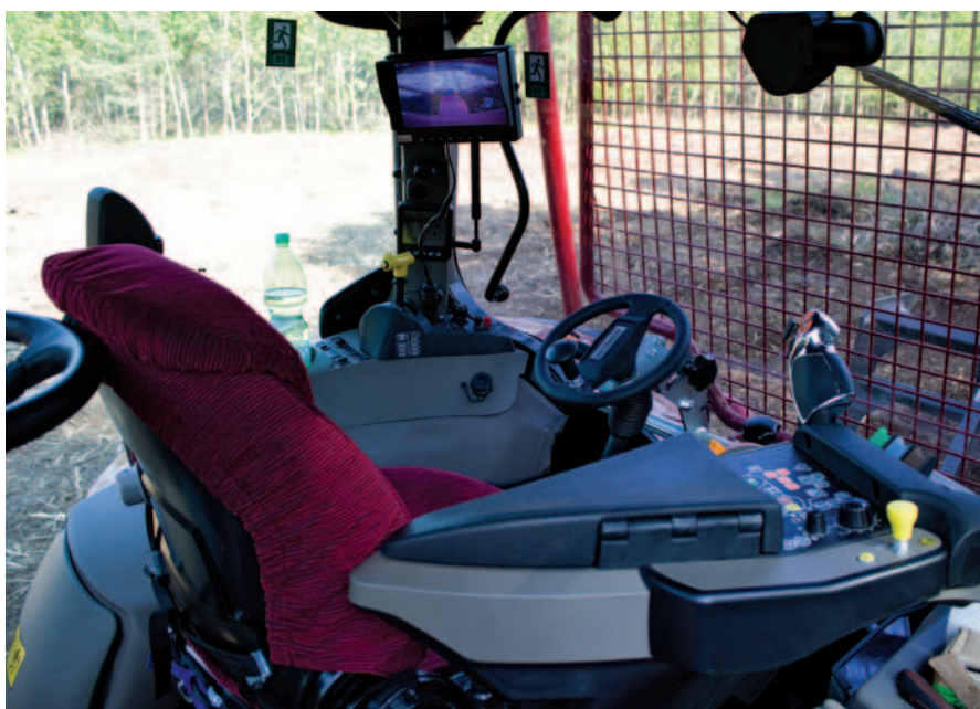
Obr.: Kompletní otočné řízení. Přes loketní opěrku Multicontroller se ovládají veškeré důležité funkce traktoru včetně zvedání a spouštění frézy
