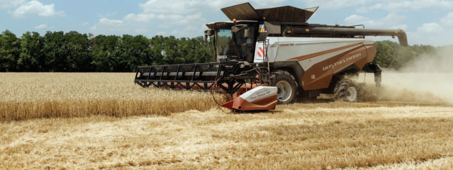
Obr.: TORUM vizuálně navazuje na RSM 161, avšak v útrobách se skrývá axiální technologie výmlatu
