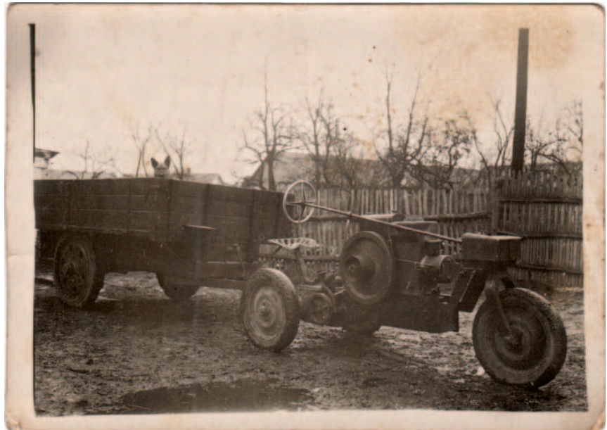
Obr.: Tříkolový traktor Svoboda DK 7,5 HP se vyráběl v letech 1935 až 1938
