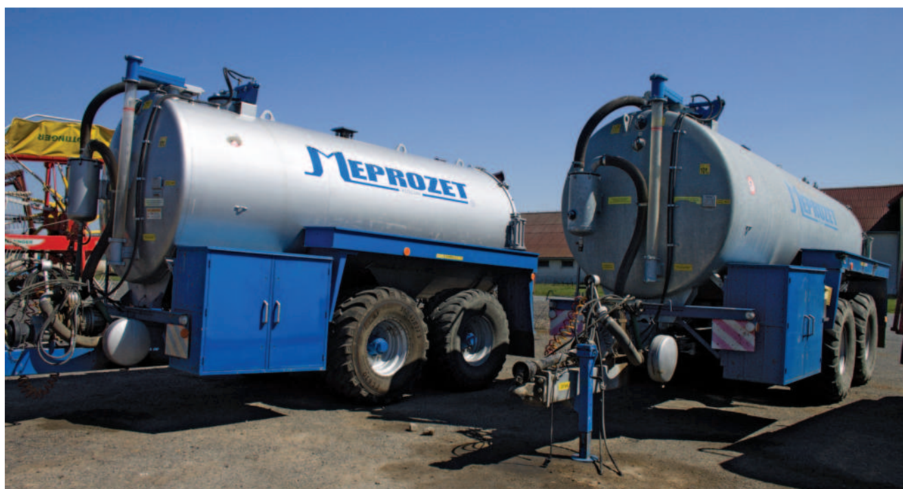
Obr.: Nádrž cisterny je z pozinku, který se vyznačuje odolností vůči korozi, mechanickému poškození a dlouhou životností. Další cisterna je uvnitř pogumovaná
