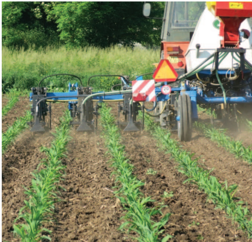
Obr.: Kultivátor Cropper umožňuje provádět řízenou výživu širokořádkových plodin v době vegetace a podsev do meziřádků
