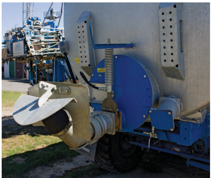
Obr.: Zde probíhá rozstřik kejdy přímým nárazem na rozstřikovací koncovku
