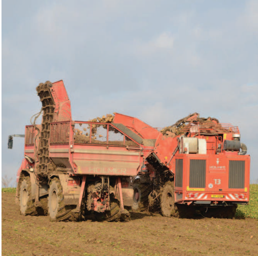
Obr.: Víceúčelový nosič Terra Variant s řepnou nástavbou (foto Věra Hejhálková)
