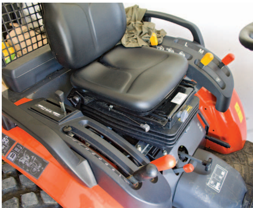
Obr.: Ovládací prvky u modelu B2261 jsou barevně odlišeny, oranžové jsou určeny pro pojezd, žluté pro vývodové hřídele a černé pro hydrauliku
