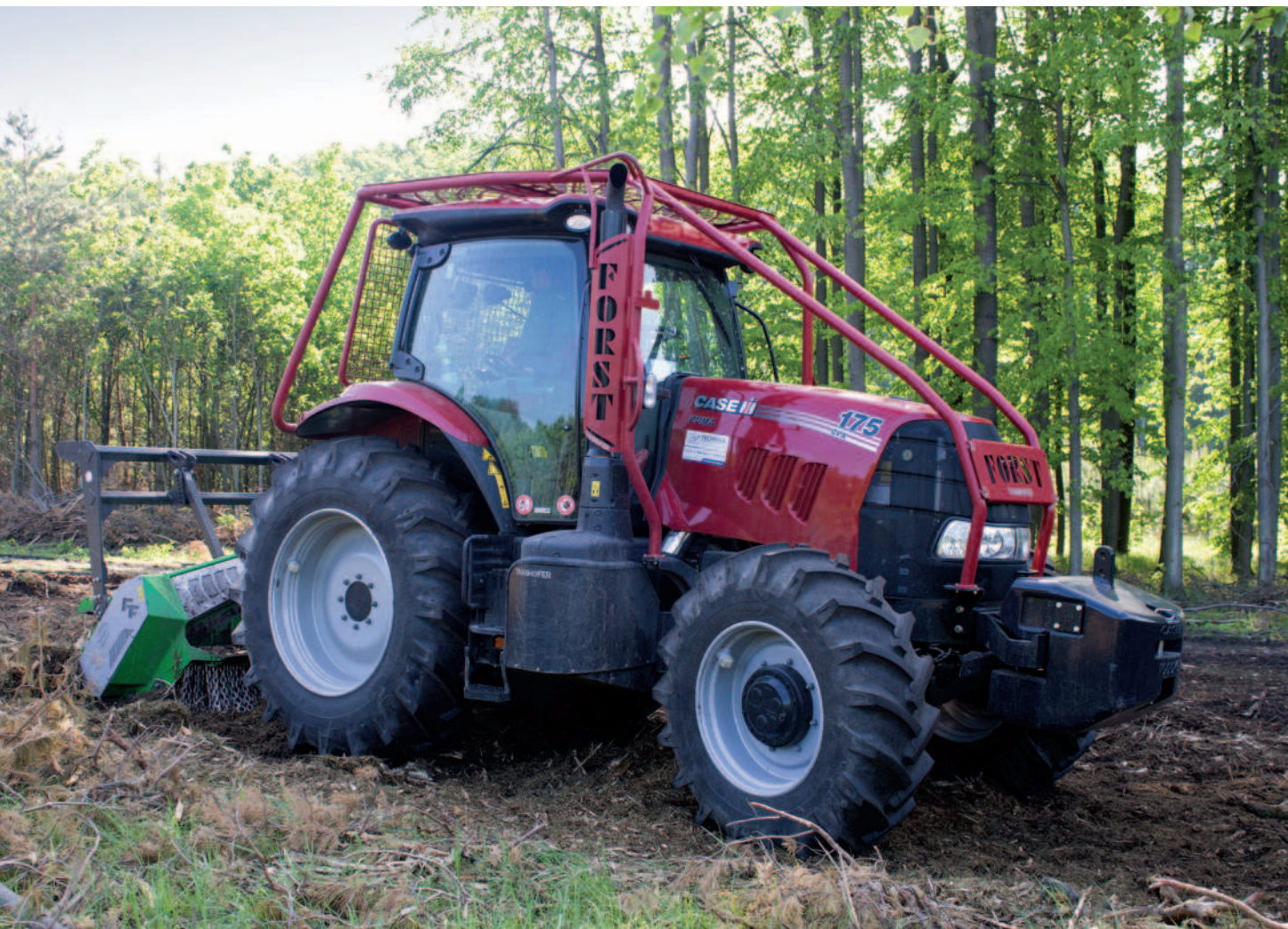
Obr.: Výkonnost soupravy obsluha odhadla na 50 arů za pracovní dobu
