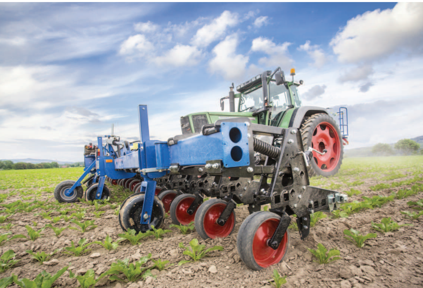
Obr.: Originalita stroje Multi Cropper spočívá ve tvaru a sledu pracovních nástrojů vytvářejících vhodnou strukturu povrchu půdy a modulujících půdní profil pro optimální pohyb srážkové vody ke kořenům rostlin
