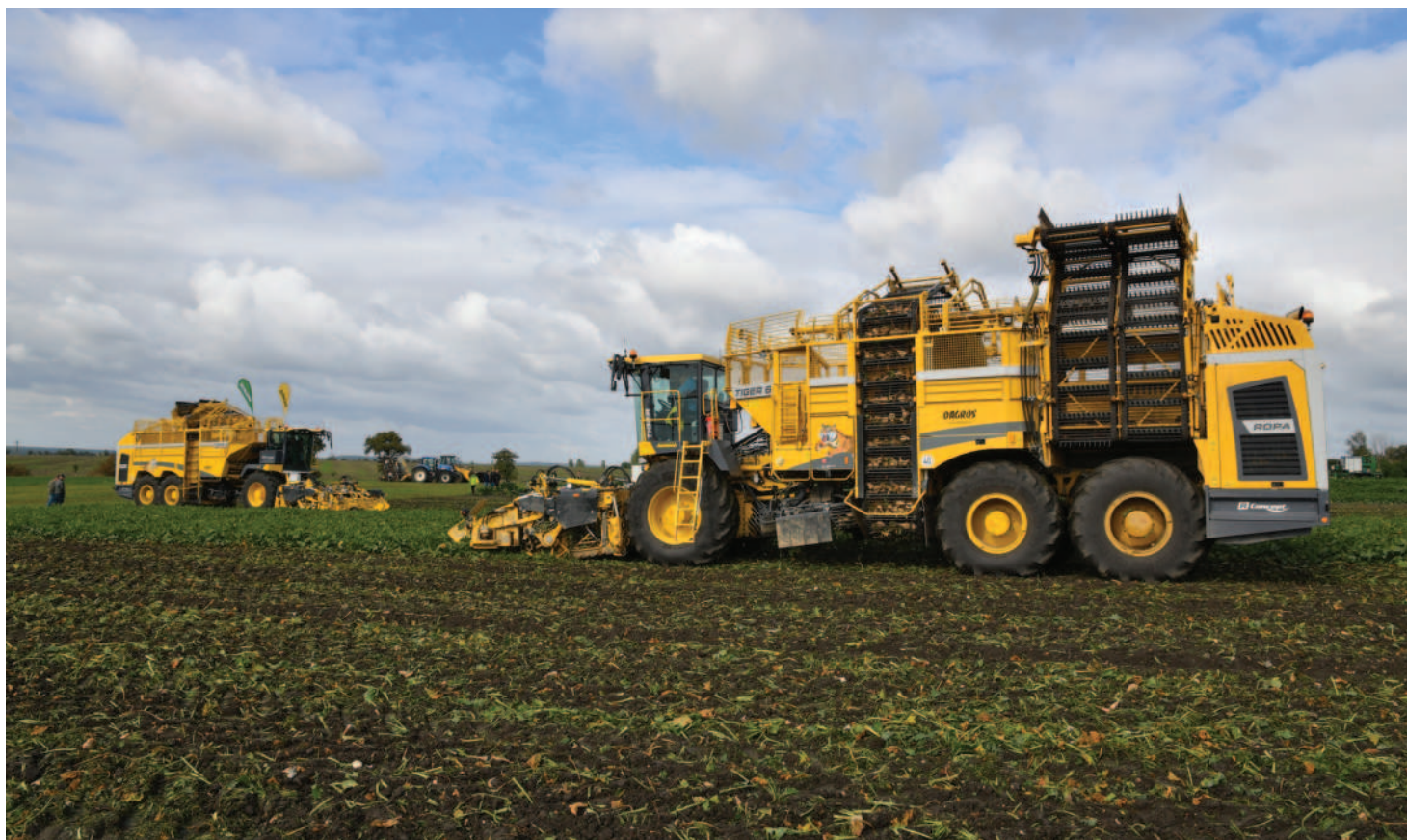
Obr.: Dvojice sklízeců Ropa Tiger 6 disponující motory Volvo s výkony 768 koní
