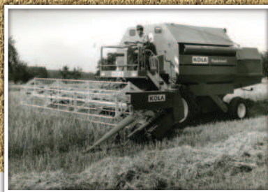
Ködel & Böhm: Evropský průkopník sklízecích mlátiček s hydrostatickým pohonem
