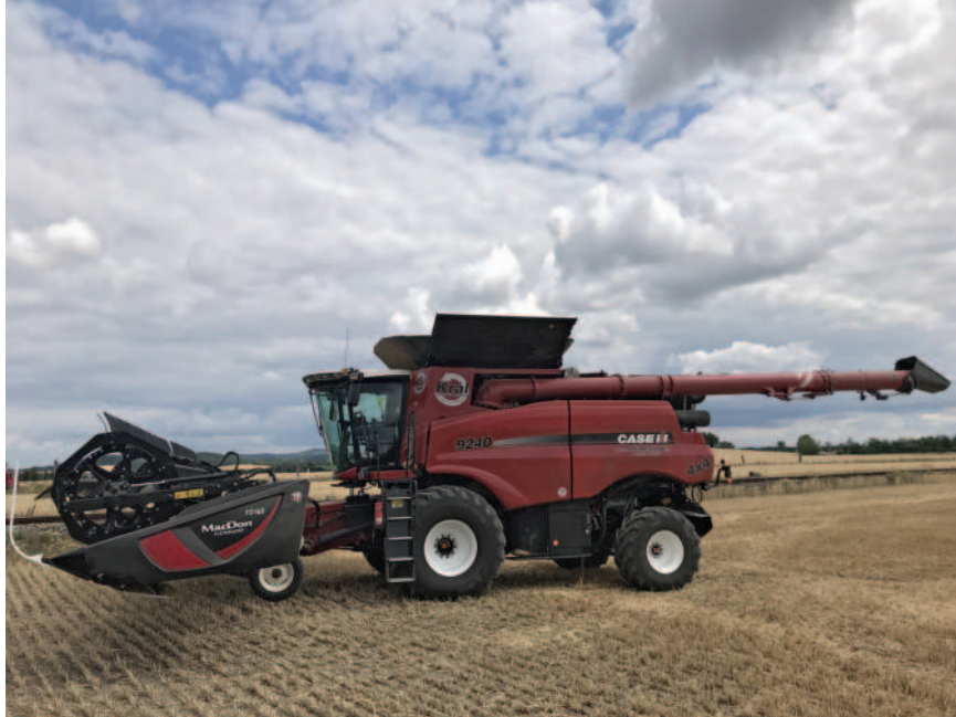
Obr.: Sklízecí mlátička Case IH Axial-Flow® s žacím adaptérem MacDon FD140 o záběru 12 metrů a upraveným výložníkem pro systém v režimu sklizně CTF (systém řízeného pohybu strojů)
