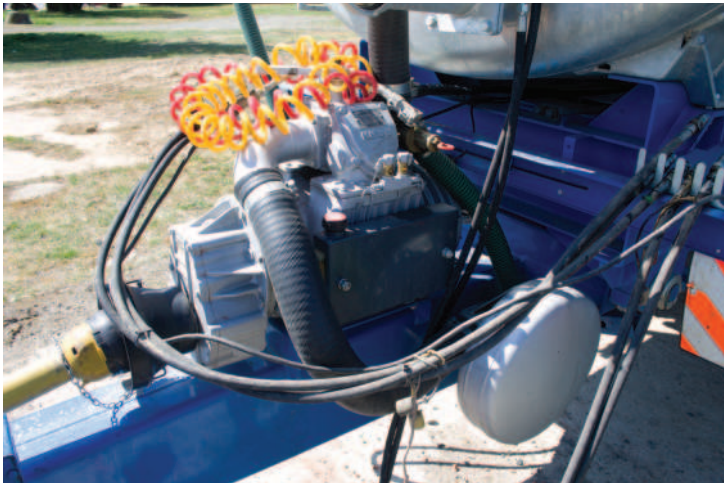
Obr.: U větších cisteren Meprozet (vlevo) má čerpadlo průtok 11 000 l/min a u menších 9 000 l/min
