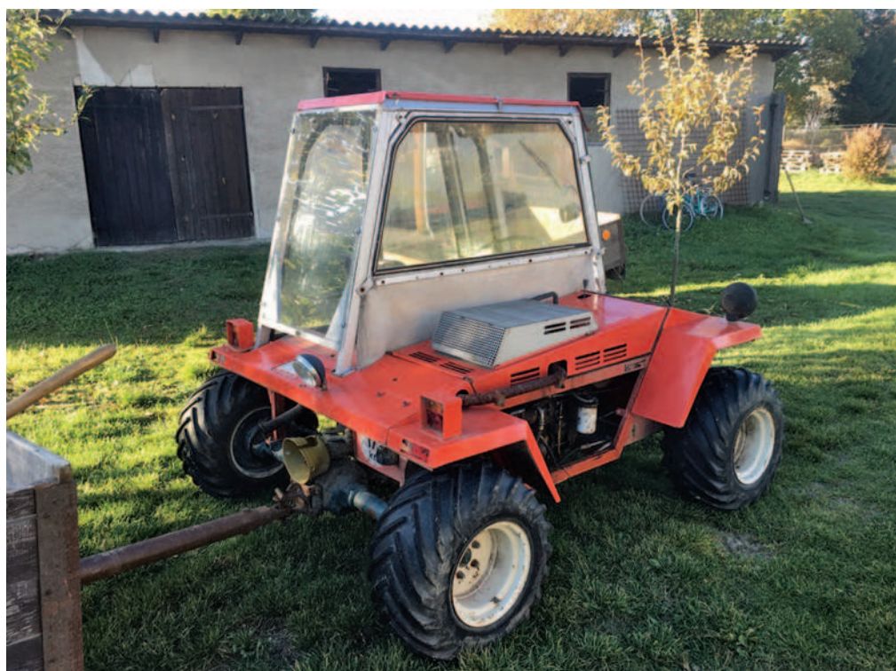
Obr.: Nízko položený motor Lombardini a velký rozvor kol poskytují stroji výbornou stabilitu při náklonu
