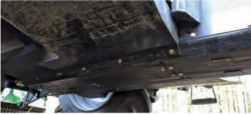
Obr.: Proti průrazu je chráněna celá spodní část traktoru masivní ocelovou konstrukcí
