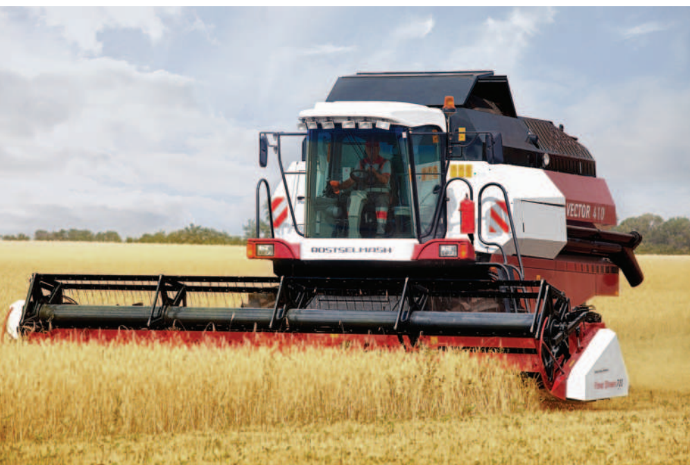
Obr.: Čtyřvytrásadlový VECTOR 425 je vybaven velkým 800mm mláticím bubnem a separačním košem
