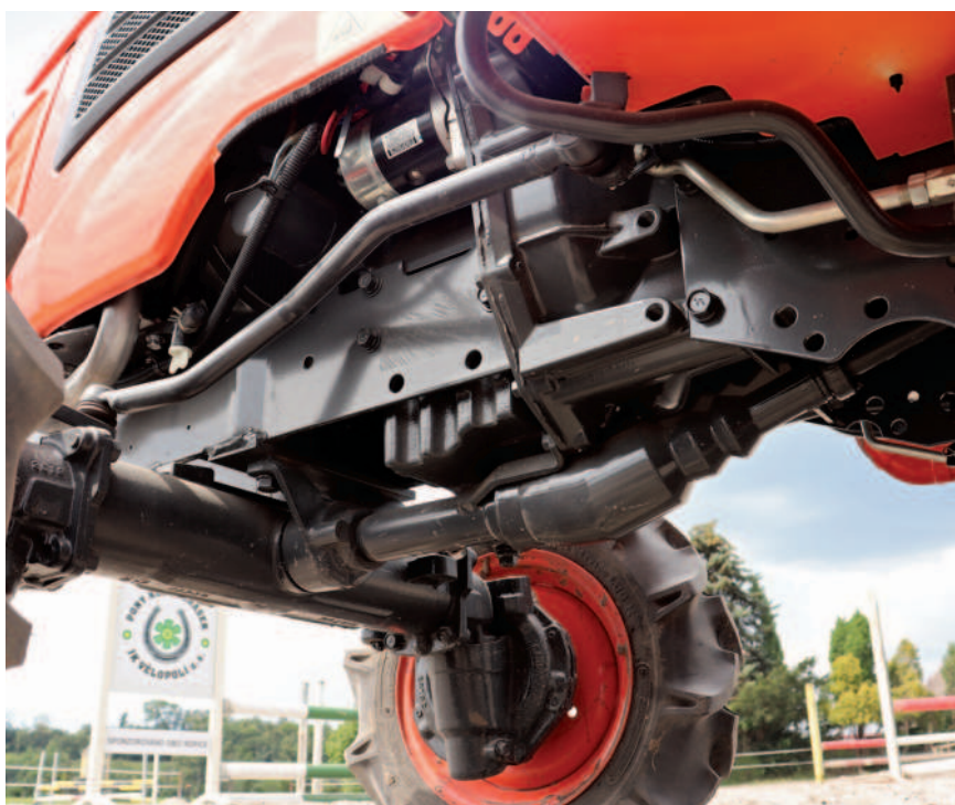
Obr.: Malotraktor je vybaven pohonem všech kol včetně uzávěrky diferenciálu pro maximální trakční schopnost.
