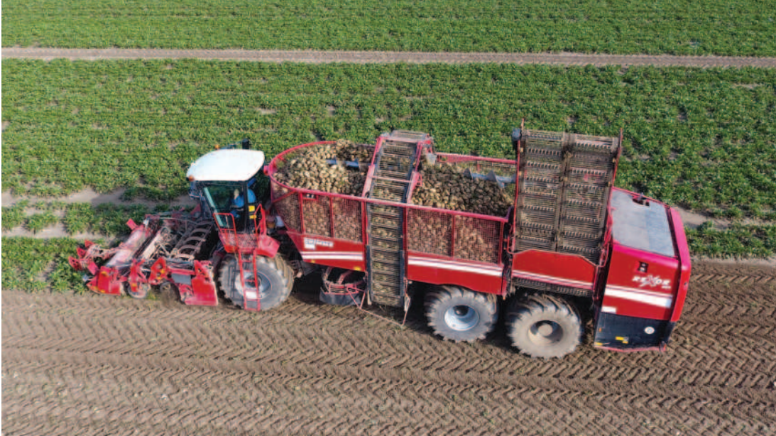
Obr.: Třinápravový sklízeč Grimme Rexor 630 je rozdělen na dvě části a spojen kloubem. Na fotografii můžeme vidět přesazenou jízdu.
