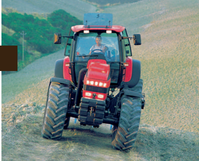
Obr.: I když by se traktor pohyboval při orbě v brázdě, kabina by byla ve vodorovné poloze.
