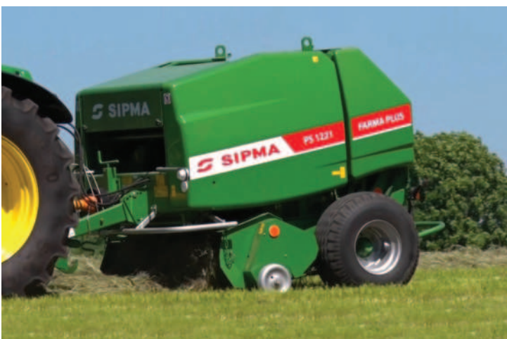
Obr.: Pícniny a slámu na farmě lisují do kulatých balíků. Lisování obstarává SIPMA PS 1221 FARMA PLUS. Foto: SIPMA, Youtube
