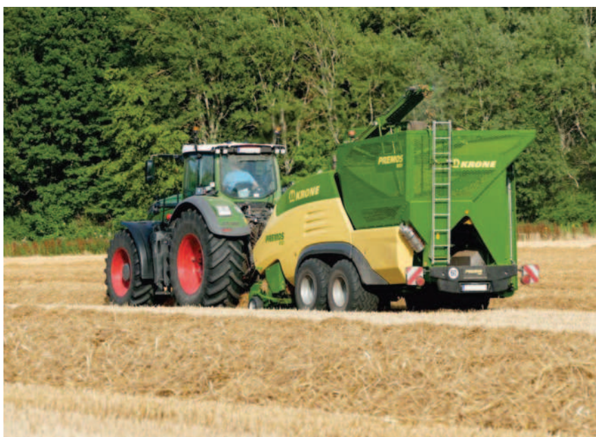
Obr.: Další možností je sklizeň slámy tzv. peletovačem, který vyrábí konečný produkt (slaměné pelety) při jednom pracovním postupu přímo na poli. Zdroj: Krone
