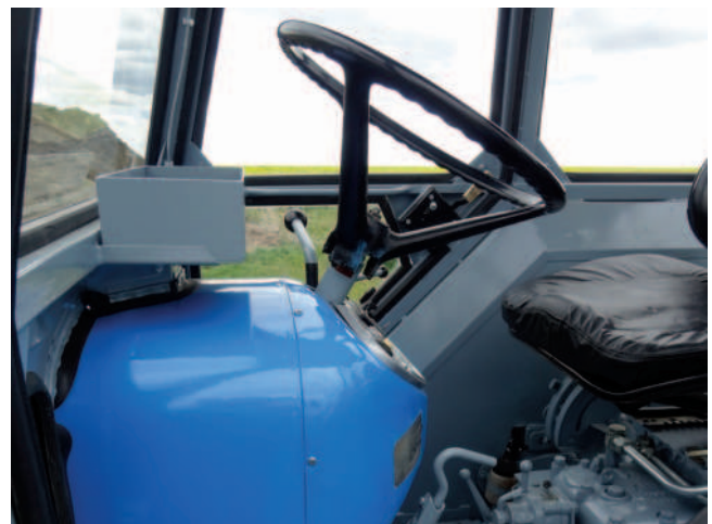
Obr.: Vše bylo nalakováno dvousložkovou PUR barvou (šedá odstín RAL 7000 a modrá RAL 5015).
