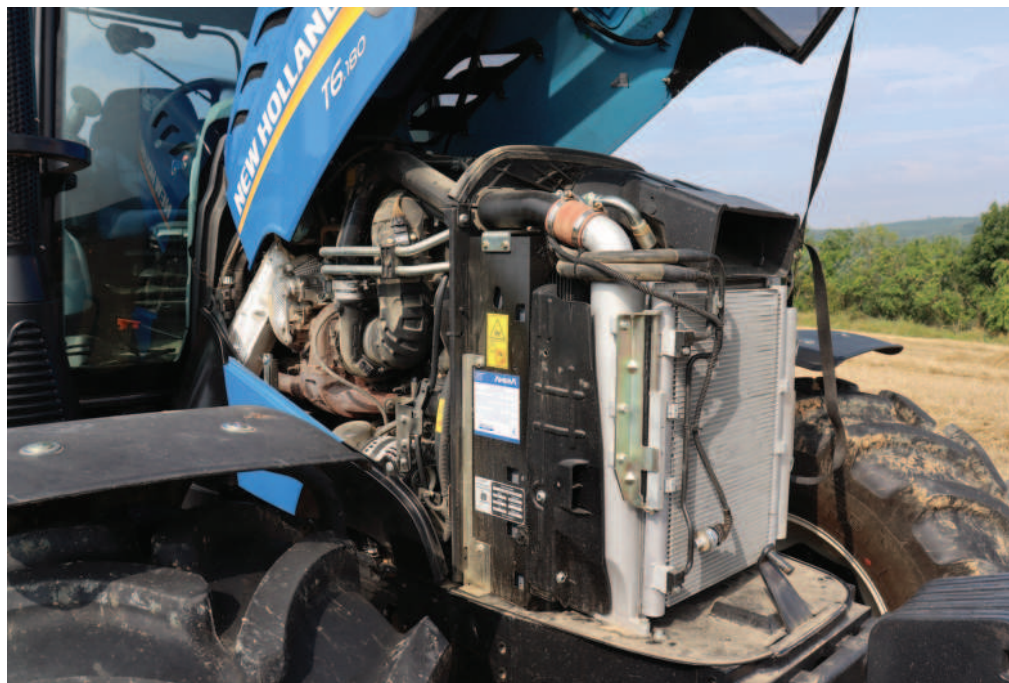
Obr.: Šestiválcový motor je podle majitele pružný a dokáže na vývodové hřídeli nabídnout až o deset koní více ve srovnání se čtyřválcem. Traktor má zatím odpracováno 190 motohodin.
