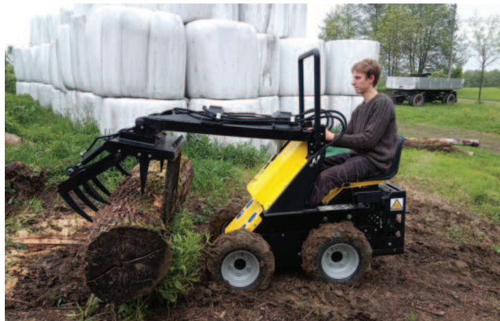
Obr.: Srdcem nakladače je benzínový motor LIFAN nebo HONDA s elektrickým startem o výkonu 15 koní.
