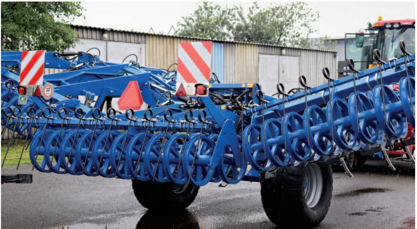
Obr.: Pohled na dvojitý STS válec a zavlačovače při sklápění do přepravní polohy.
