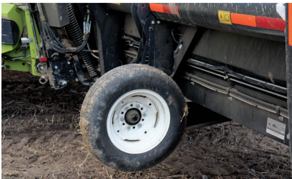
Obr.: Stabilizační kolečka usnadňují kopírování na terénních nerovnostech a upravují přítlak lišty.
