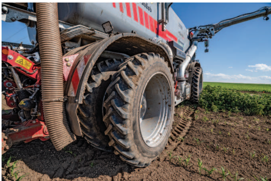
Obr.: Obratný Holmer Terra Variant s poloměrem otáčení jen 11,0 m, rozvorem 4,76 m a čtveřicí zdvojených řízených kol. Foto: Ondřej Pytlíček.
