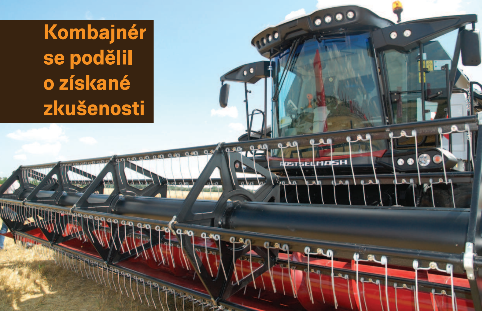
Obr.: Sklízecí mlátička RSM 161 byla speciálně vyrobena pro adaptér s pracovním záběrem devět metrů.
