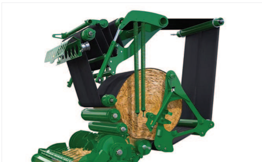
Obr.: Tvorba balíku v lisovací komoře tvořené nekonečnými pásy.
