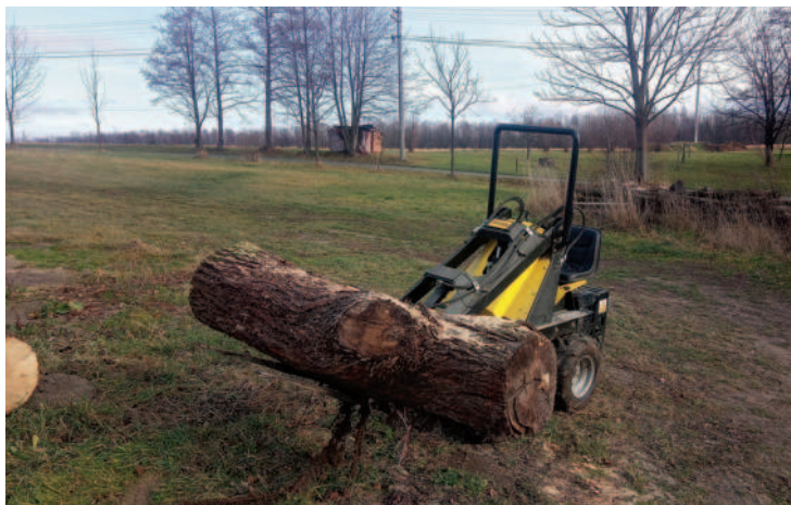
Obr.: Navzdory minimalistickým rozměrům je stroj schopen uzvednout 300 kg do výšky dvou metrů.
