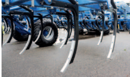
Obr.: Vector pro Agrodružístvo Morkovice (vlevo) byl osazen úzkými dláty, zatímco Vector pro Salix Morava křídlovými radličkami.
