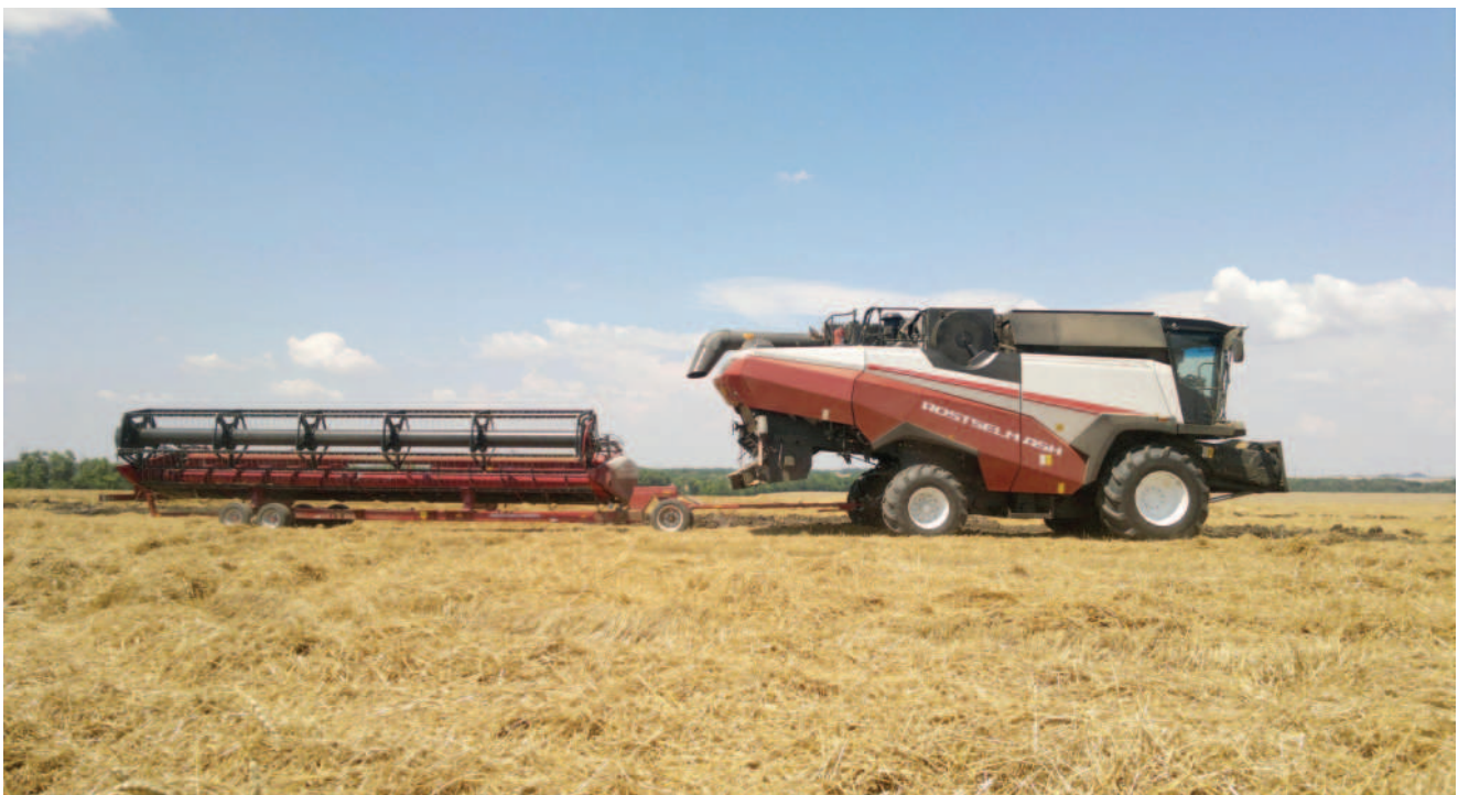
Obr.: Sklízecí mlátička je vybavena mlátičím systémem TETRA Procesor.
