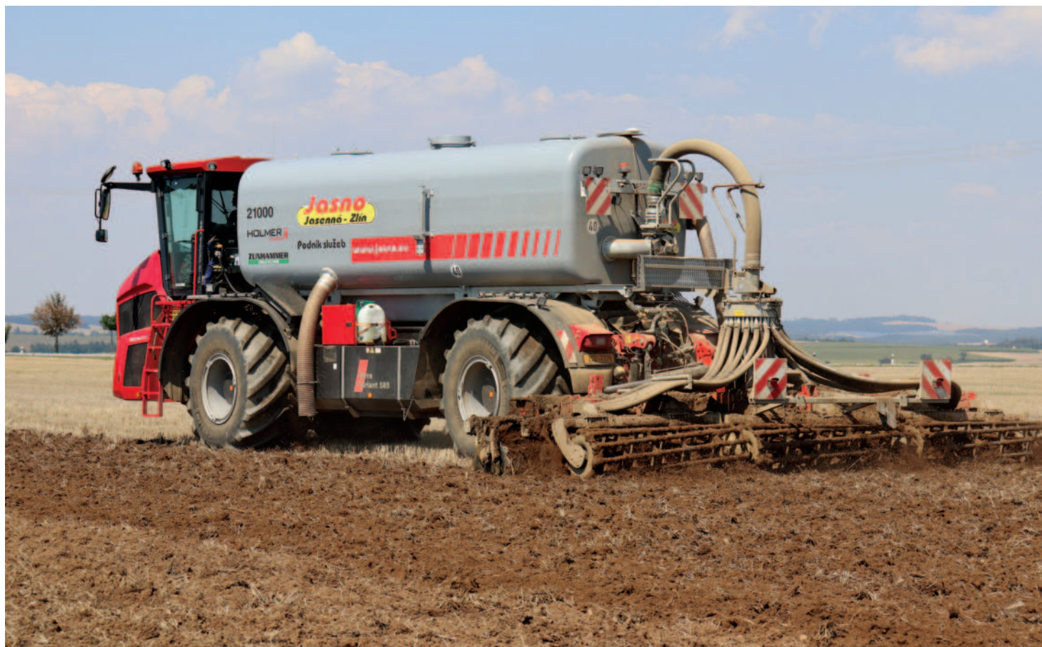
Obr.: Holmer Terra Variant při zapravování hnojiva do strniště.
