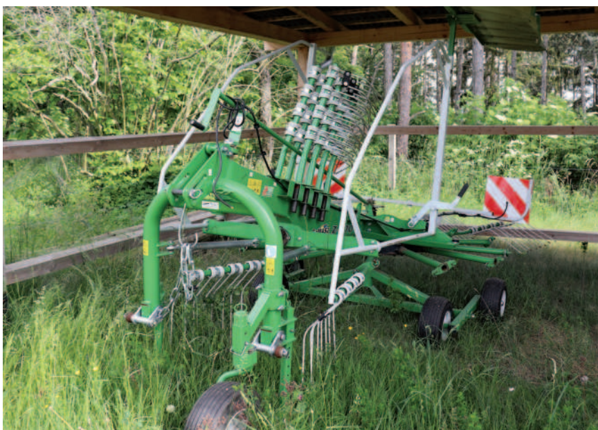
Obr.: Shrnutí píce uložené naširoko do jednoduchého řádku, a tedy zajištění kvalitního sběru lise, obstarává na statku jednorotorový nesený shrnovač SaMASZ lehké konstrukce.
