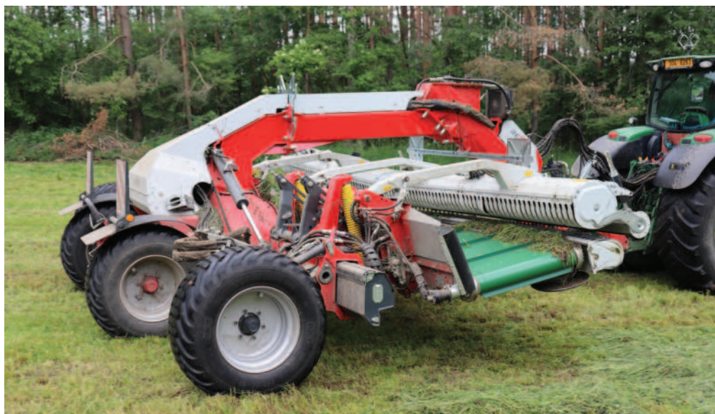
Obr.: Při zvednutí je sběrač od země vzdálen 750 mm. Při otáčení nebo poježdění nedeformuje již vytvořené řádky hmoty.
