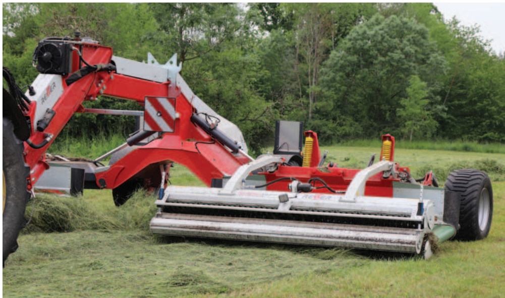
Obr.: Pod rámem (ve tvaru U, střed) projde i vydatný řádek hmoty.
