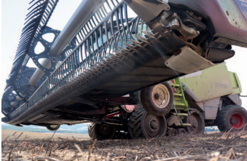
Obr.: Kopírovací plazy velice efektivně kopírují veškeré nerovnosti a zaručují velice nízké strniště i u velkozáběrových lišt.
