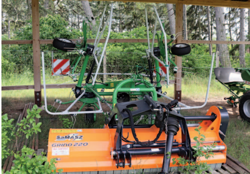
Obr.: SaMASZ Grino 220. Mulčování hmoty zajišťuje cepová hřídel se spirálovitým uspořádáním cepových nožů a řada protilehlých nožů.
