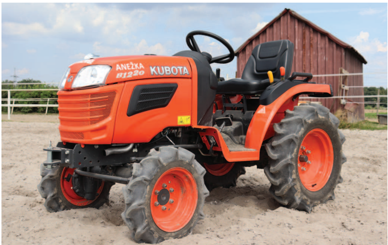
Obr.: Eleganční design zajišťuje dobrou viditelnost a pohodlí. Maximální rychlost malotraktoru činí 17 km/h a hmotnost 460 kg.
