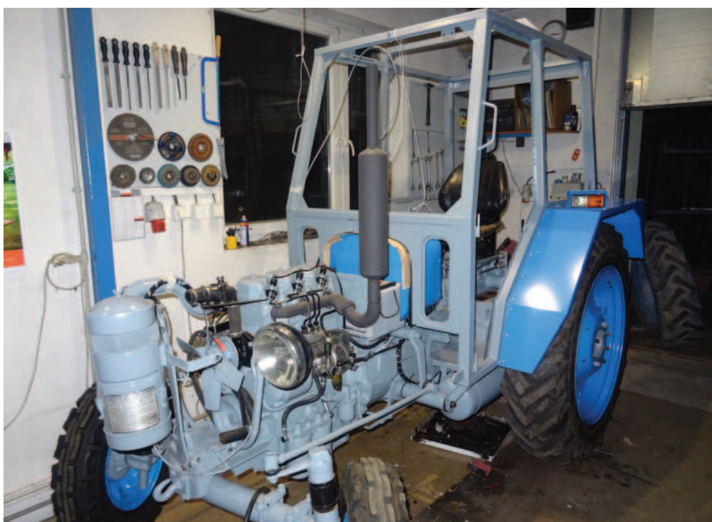
➔ Obr.: Kromě generální opravy motoru bylo potřeba kompletně renovovat přední nápravu.
