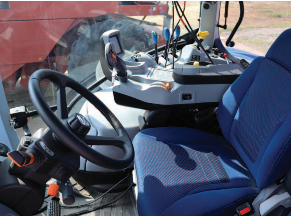
Obr.: Interiér traktoru s jednoduše koncipovaným ovládacím panelem s pevnou pákou a menším monitorem.
