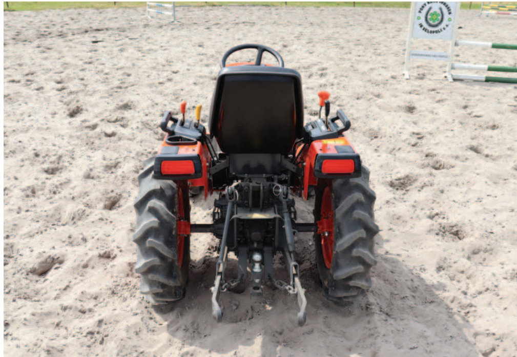
Obr.: Maximální zatížení zadního hydraulického tříbodového závěsu činí 430 kg.
