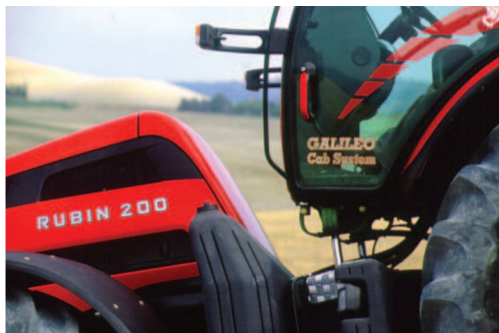
Obr.: Zajímavým konstrukčním řešením bylo oddělení kabiny od kapoty motoru.
