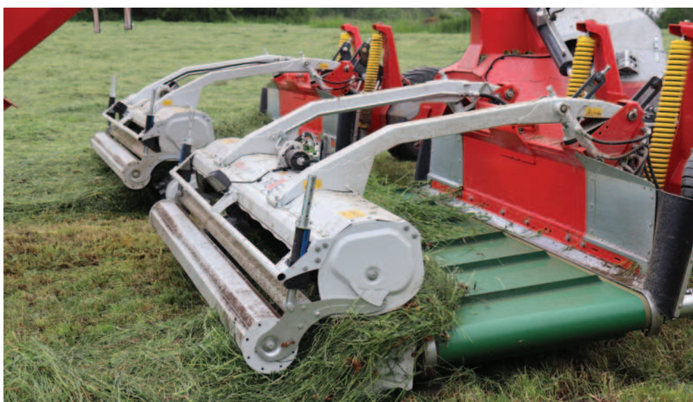
Obr.: Hmota z pole na řádek urazí velmi krátkou vzdálenost, což eliminuje její kontaminaci.
