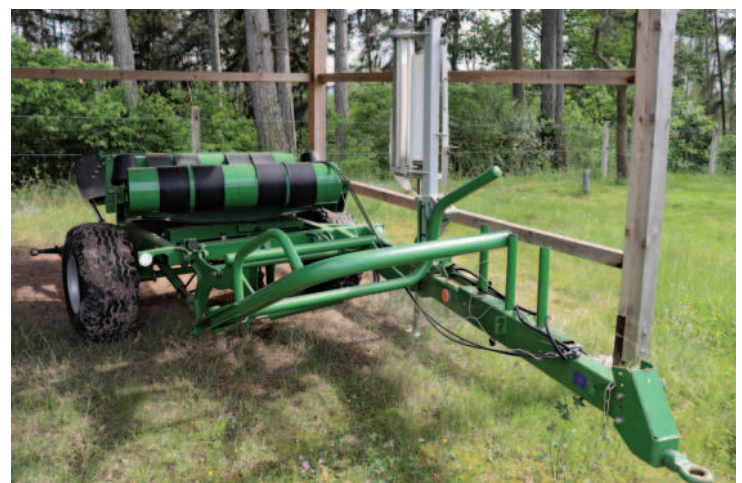
Obr.: Tažená balička SIPMA zvládne zabalit balík o průměru 1200 až 1500 mm a hmotnosti do 1200 kg.
