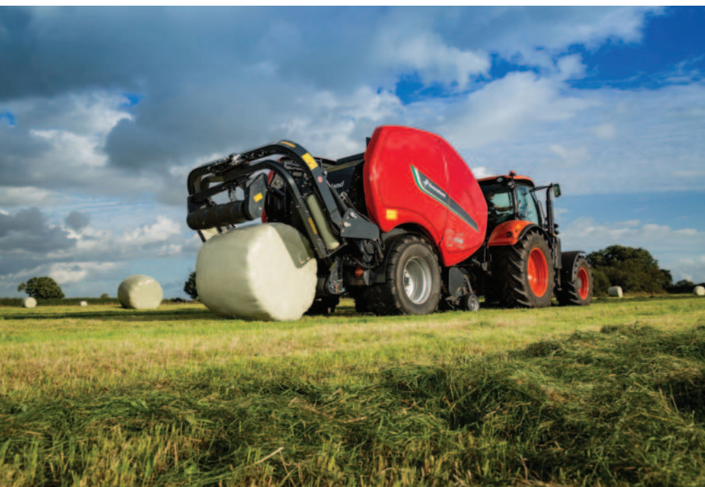
Obr.: Kverneland FastBale je prvním lisem na světě s integrovanou ovíječkou, který nemusí zastavovat. Foto: Kverneland
