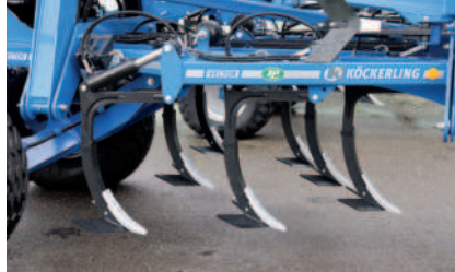
Obr.: Vector pro Agrodružístvo Morkovice (vlevo) byl osazen úzkými dláty, zatímco Vector pro Salix Morava křídlovými radličkami.
