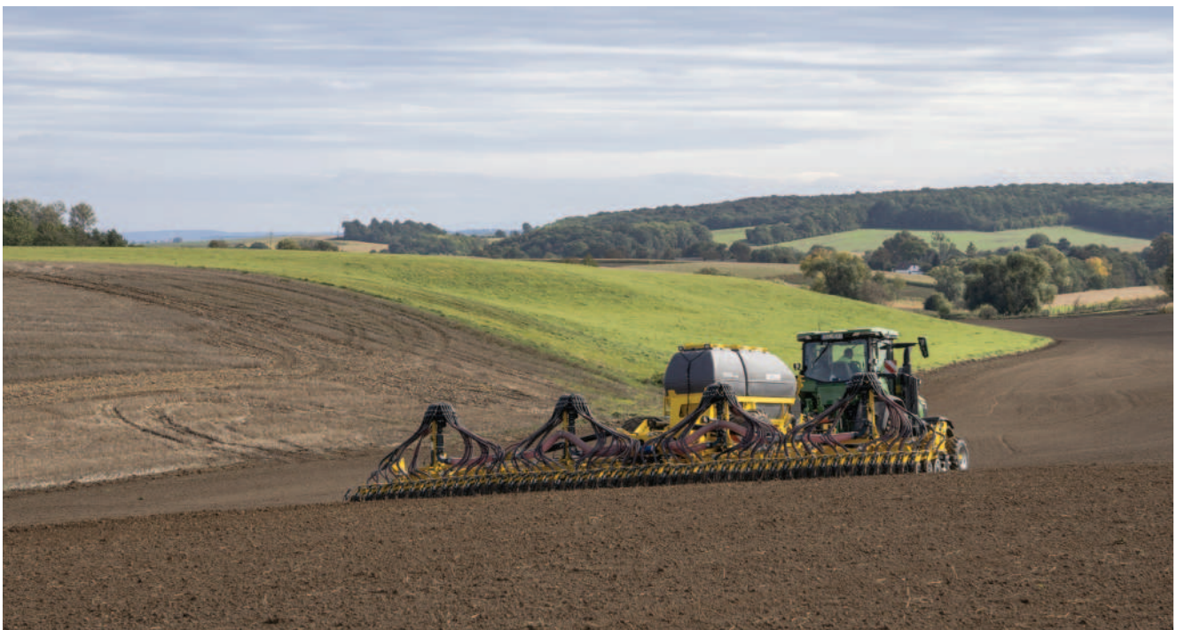
Obr.: Secí stroj BEDNAR EFECTA CE 12000 přináší nové trendy v oblasti vysokého denního výkonu, až 200 ha/den, s nízkou spotřebou paliva, vysokou pracovní rychlostí a malým požadavkem na tahový výkon traktoru pouhých 300 koní.
