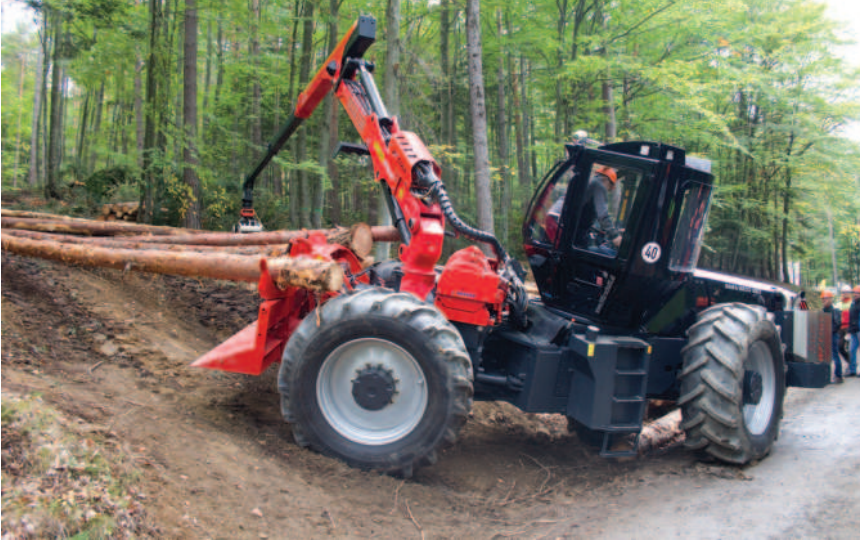
Obr.: Kolový traktor na výstavě disponoval navijákem C102.2 H2 ZD a hydraulickou rukou Epsilon X 150 R 140.
