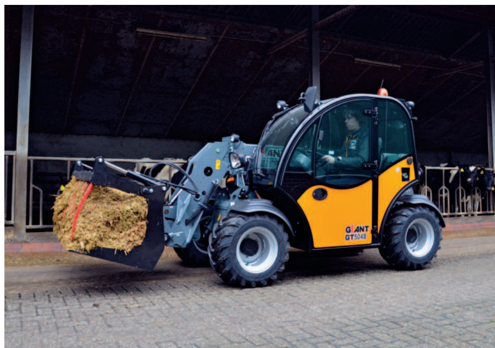
Obr.: Stroj je osazen tříválcovým turbomotorem Kubota s objemem 1,8 litru a výkonem 36 kW / 50 koní.
