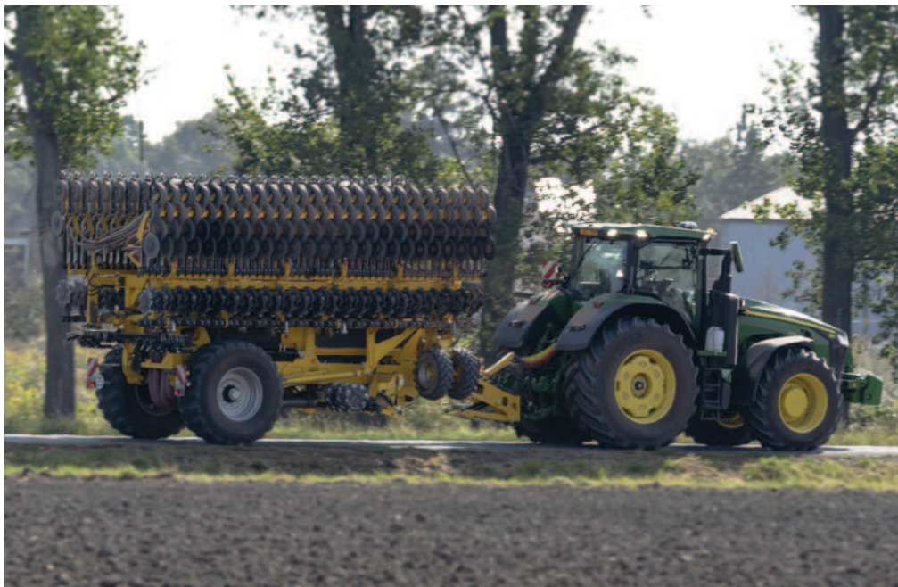
Obr.: Stroj má technické parametry, které odpovídají požadavkům provozu strojů po pozemních komunikacích v Evropské Unii. Jeho přepravní šířka činí 3 m, přepravní délka 7,8 m a přepravní výška 4 m.
