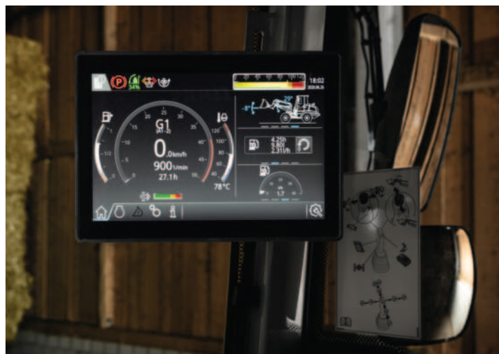
Obr.: Všechny důležité parametry stroje jsou zobrazeny na 9palcovém dotykovém displeji.
