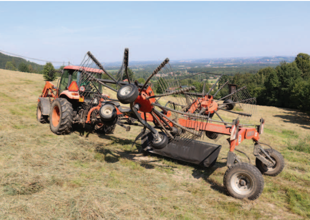
Obr.: Dvourotorový středový shrnovač Kubota RA2072 Hydro disponuje komfortními prvky, které umožní stroj ovládat pohodlně z kabiny.
