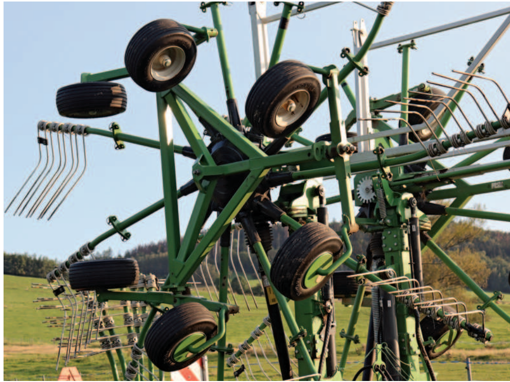
Obr.: Rotor shrnovače má bezúdržbovou převodovku, z mechanismu pak vyústí ramena s prsty se speciálním tvarem, uspořádáním a profilem, jež napomáhá preciznímu sběru a správnému tvarování řádku.
