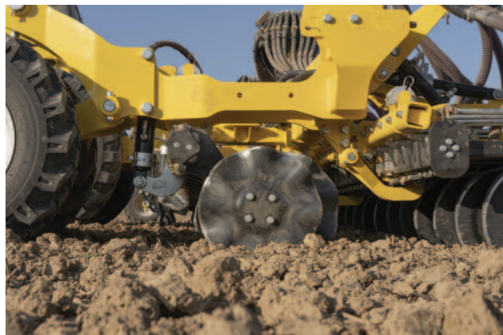
Obr.: Přední pracovní část před secími botkami může být osazena oblíbenými PROFI Coulterly nebo TURBO Coulterly.
