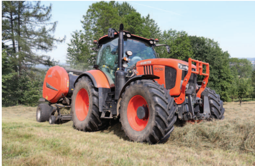
Obr.: Kubota M7131 Premium se pro práci s čelním nakladačem velmi hodí, protože je obratný a má malý poloměr otáčení. V tomto směru je podle majitele traktor podstatně technologicky vyspělejší než konkurence.
