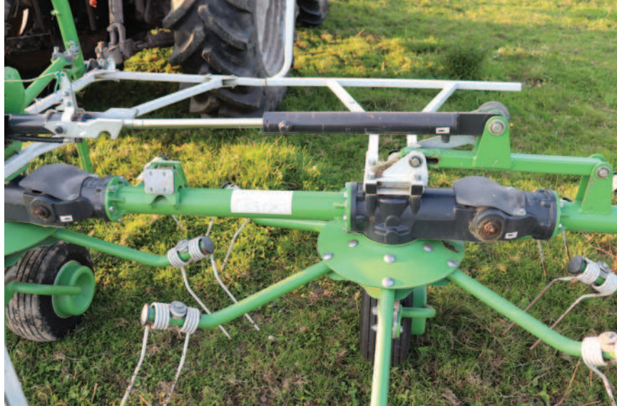
Obr.: U obraceče jsou součástí hlavního rámu s trubkovým profilem převodovky s olejovou náplní se snadno přístupnými mazacími body.
