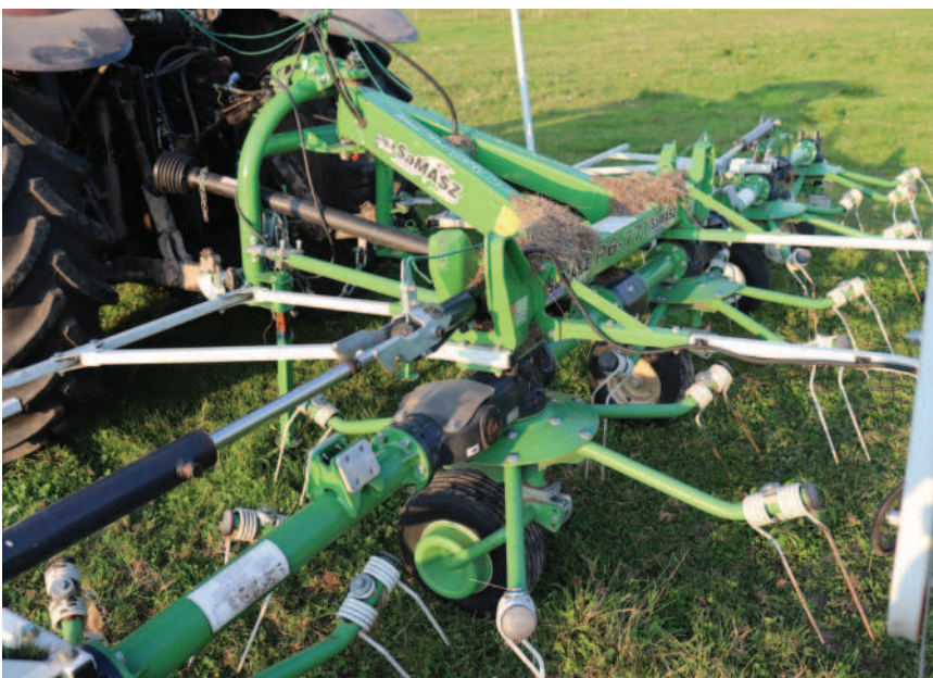
Obr.: Dvojice hydraulických válců zajišťuje plynulé skládání levé i pravé strany obraceče do transportní polohy.
