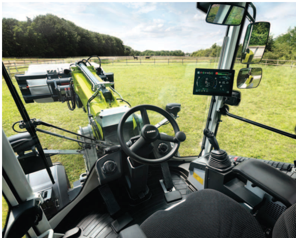
Obr.: Torion 738 T Sinus disponuje čtyřsloupkovou kabinou, zkosenou kapotou a štíhlým výložníkem.
