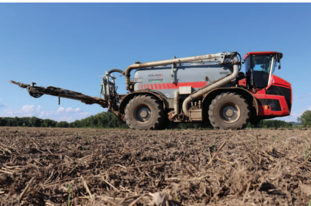
Obr.: Teiml si celkově pochvaluje koncepci Terra Variantu, která se skládá ze dvou řízených náprav s vysokou nosností, kabiny umístěné vpředu a z lehké nádrže umístěné za ní s možností bočního sání přes rameno.
