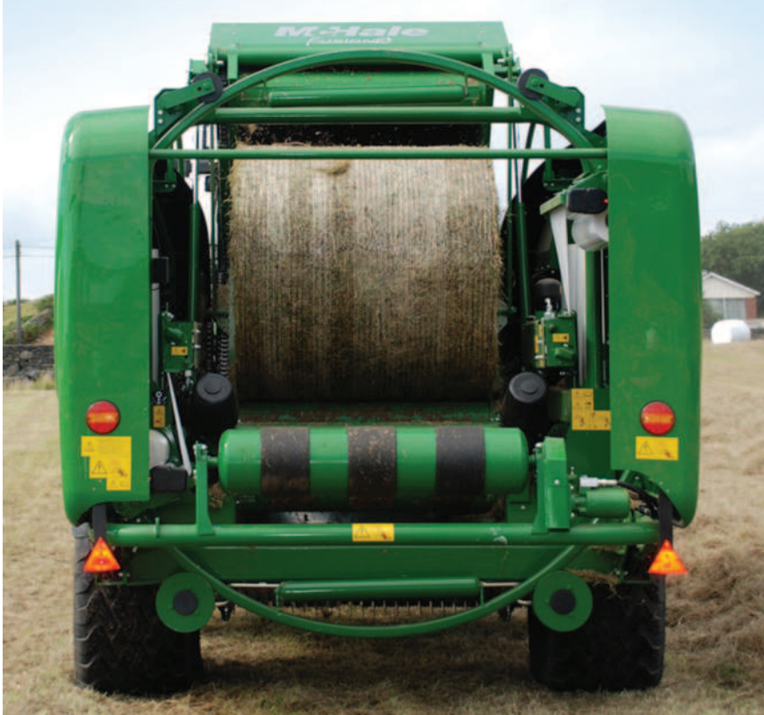
Obr.: O ovíjení fólií se stará vertikální balicí mezikruží vybavené dvěma napínači.
