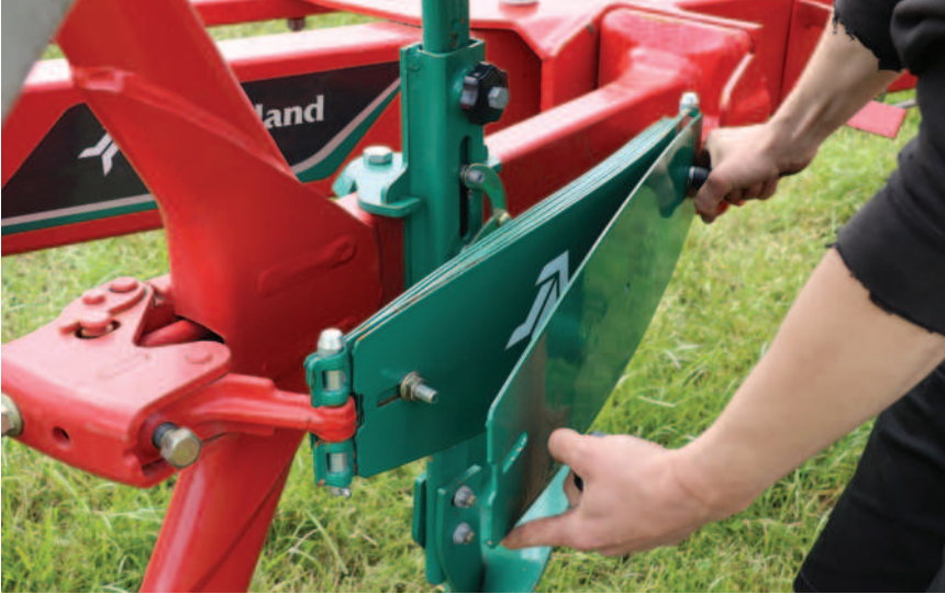
Obr.: Díky novému inteligentnímu systému lze pružiny snadno přidat nebo odebrat.
