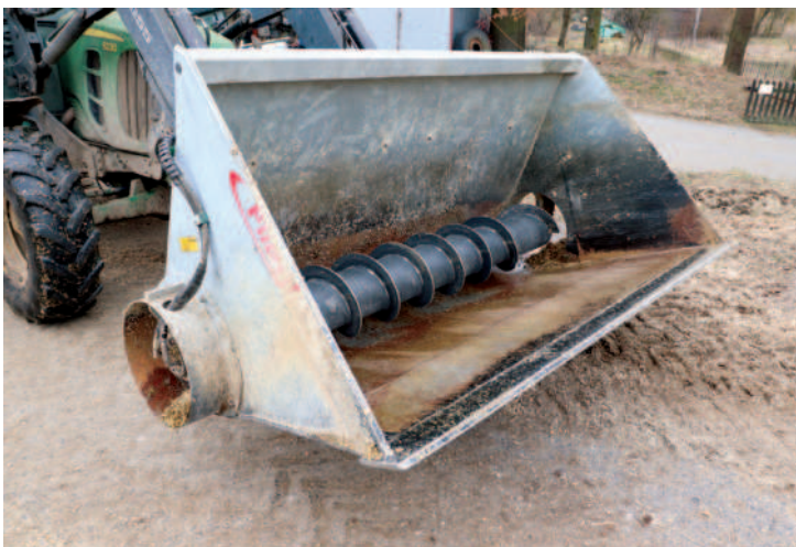
Obr.: V živočišné výrobě je za pomoci čelního nakladače využívána i krmná lopata s vynášecím šnekem.
