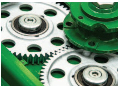
Obr.: Ozubená kola, která pohánají disky, pracují v nepřetržitě mazaném prostředí.
