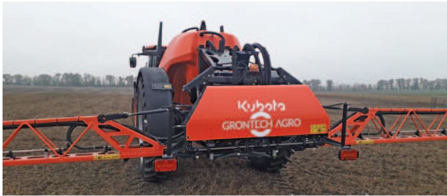
Obr.: Ramena jsou zavěšena prostřednictvím hydropneumaticky odpruženého paralelogramu, který významně tlumí rázy a výkyvy.
