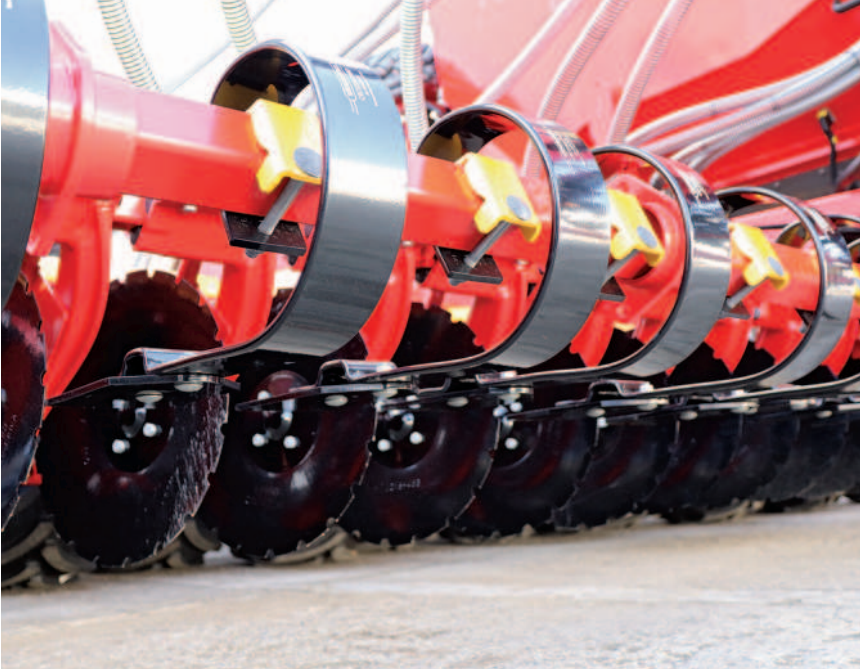
Obr.: Přípravu setového lůžka zajišťuje přední hydraulicky ovládaný smyk. Za ním vidíme sekci s disky.
