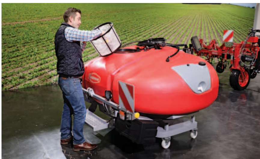
Obr.: Pro přepravu postřiku může posloužit čelní nádrž Steketee SprayHub s kapacitou 1 100 nebo 1 500 litrů.
