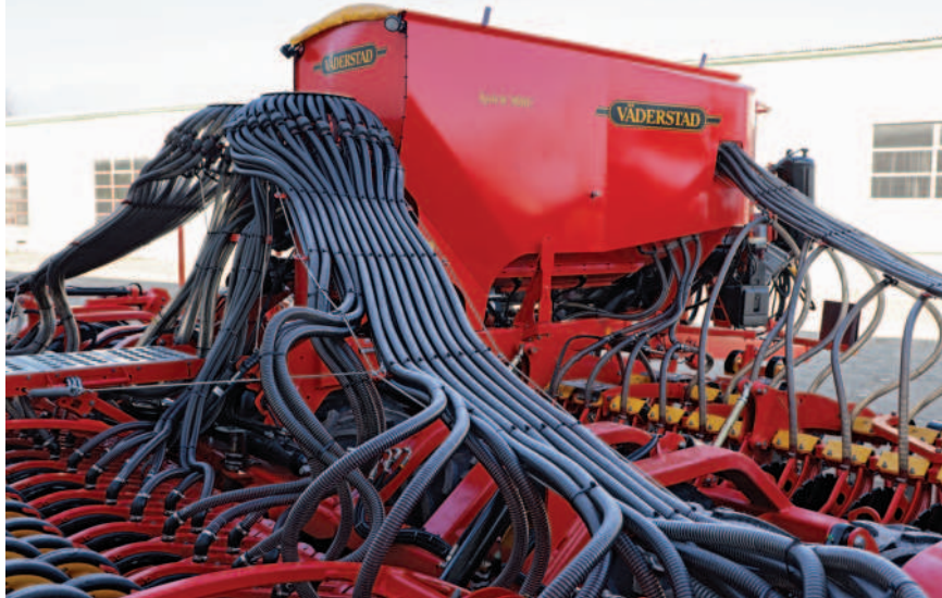
Obr.: Rozdělení osiva po celém pracovním záběru i ve svažitém terénu podporují rozdělovací hlavy umístěné ve vysoké poloze. Zásobník má kapacitu 5000 litrů.
