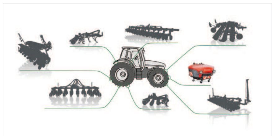
Obr.: Čelně nesený postřikovač iXtra LiFe lze použít pro cílenou aplikaci v kombinaci s libovolným půdozpracujícím/secím strojem.
