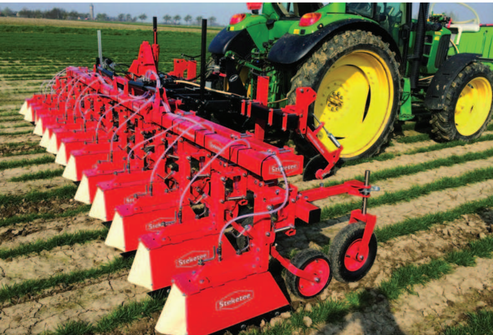
Obr.: Aplikátor EC-Spray, který je vyroben na základě mechanických pleček Steketee, lze zavěsit na přední nebo zadní závěs traktoru.
