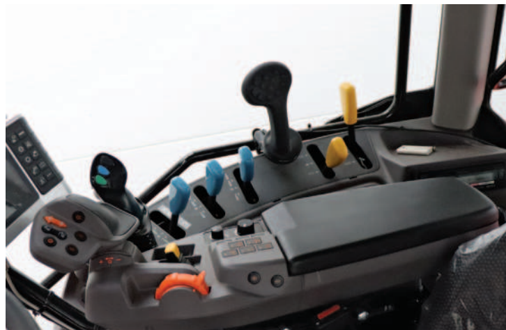
Obr.: V loketní opěrce je integrován multifunkční joystick.
