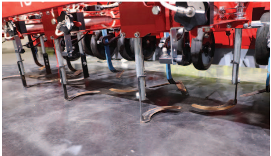
Obr.: Detailní pohled na pracovní orgány plečky Steketee IC Weeder AI.
