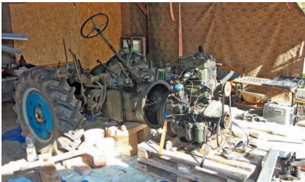
Obr.: Nejtěžší prý bylo oddělit 450kg motor od převodovky.
