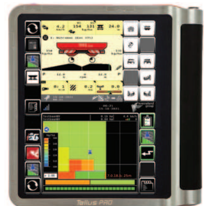
Obr.: Všechny ISOBUS kompatibilní stroje Kverneland umí variabilně dávkovat osivo, hnojivo nebo přípravky na ochranu rostlin.
