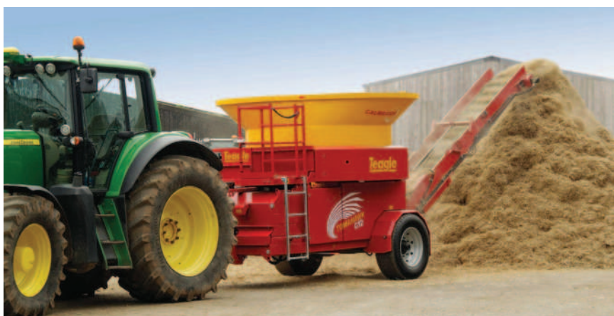
Obr.: Rozdružovač s řezacím rotorem je možné využít při zpracování sena do krmné dávky, pro hrubé řezání slámy na podestýlku a jemné mletí obilných a kukuřičných zrn.
