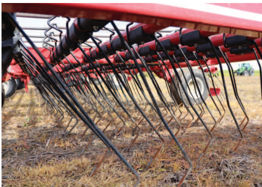
Obr.: Stroj na obrázku má odpracováno 500 ha a jeho pruty nemají téměř žádné opotřebení.
