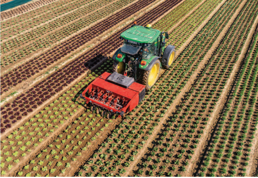
Obr.: Zvýšením efektivity plečkování plodin lze dosáhnout implementací technologií, díky nimž plečka dokáže sama rozlišit plodinu od plevelu.
