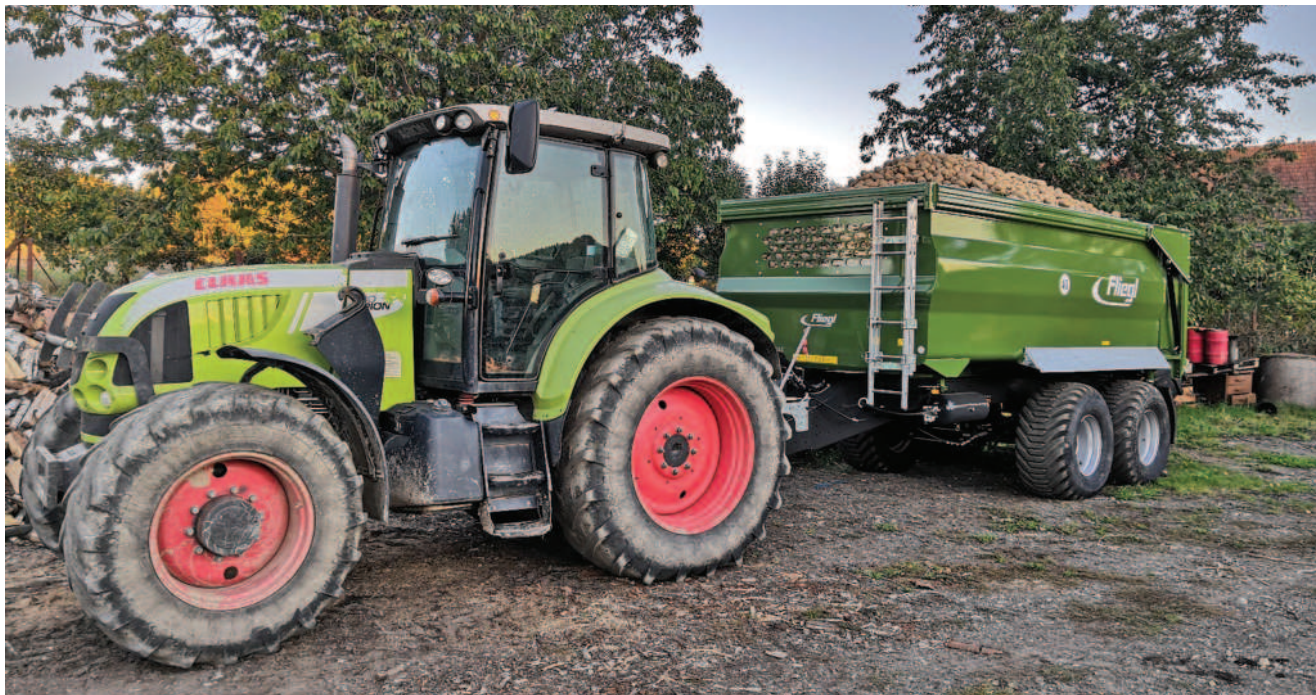
Obr.: Před pěti lety byl pořízen první návěs Fliegl TMK 160 s přípustnou celkovou hmotností 16 000 kg. Ten přepravuje veškeré komodity – od hnoje, přes obilí až po brambory.
