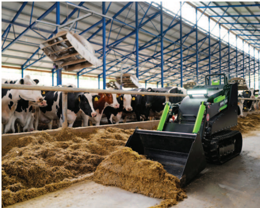
Obr.: Výhodou elektrických nakladačů jsou nulové emise a tichý chod. Zemědělci je proto ocení například ve stáji či kravínu. Na fotografii model MiniZ.
