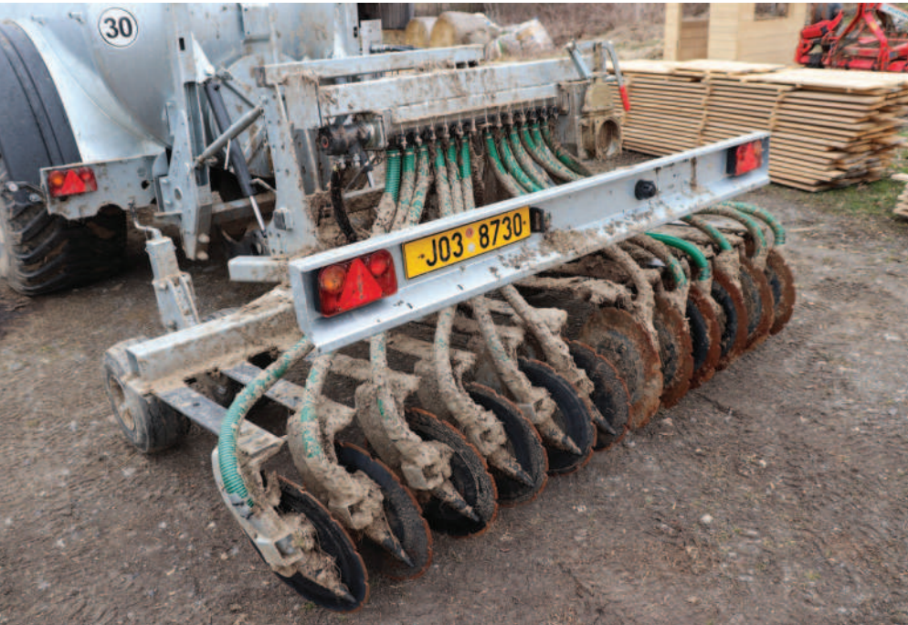
Obr.: Spolu s pořízením cisterny na farmě investovali též do diskového aplikátoru Fliegl s pracovním záběrem tři metry. Hadice je od rozdělovače přivedena k disku, který půdu nařízne a do vytvořené drážky je ukládána kejda.
