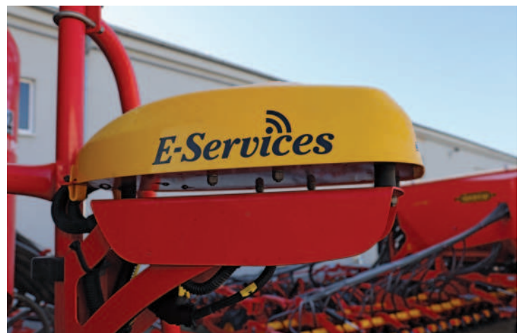
Obr.: Zde je ukryta technologie, která zrcadlí údaje ze secího stroje na ovládací tablet uvnitř kabiny traktoru.
