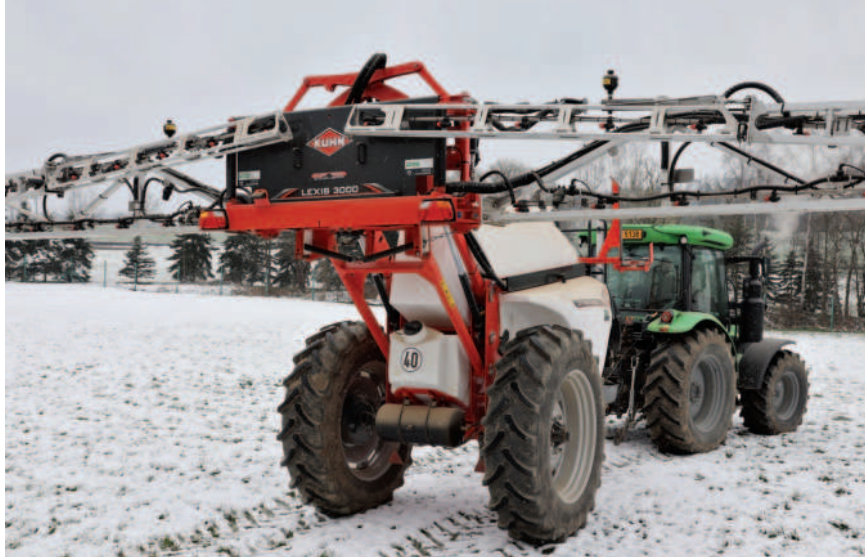
Obr.: Modely postřikovačů mohou mít hliníková (na obrázku), nebo ocelová ramena. Na fotografii postřikovač Kuhn Lexis ve společnosti RAVON AGRO. (foto Milan Jedlička)
