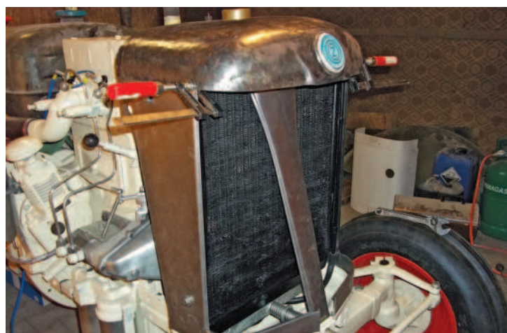
Obr.: Vyměněna byla téměř veškerá kapotáž. Přední masku pan Knesl svařoval z jednotlivých replik dílů.
