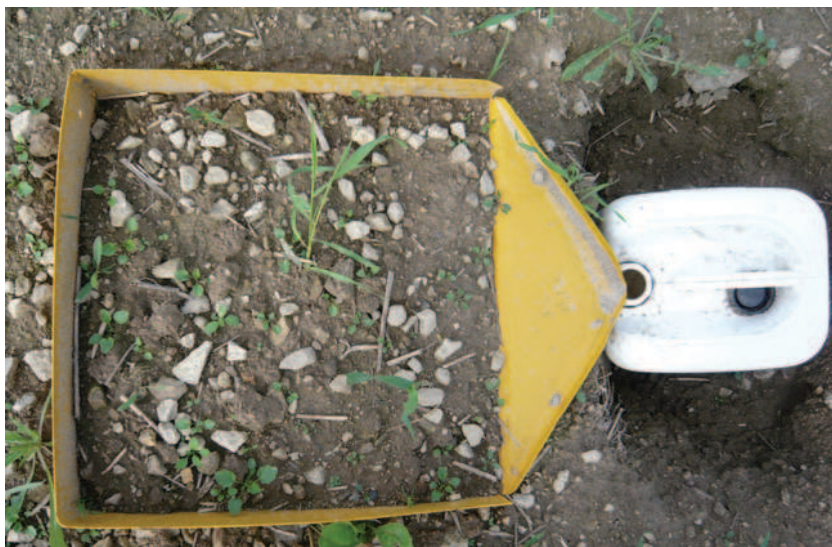
Obr. 2: Odtoková mikroparcelka se záchytnou plochou 0,16 m 2 .
