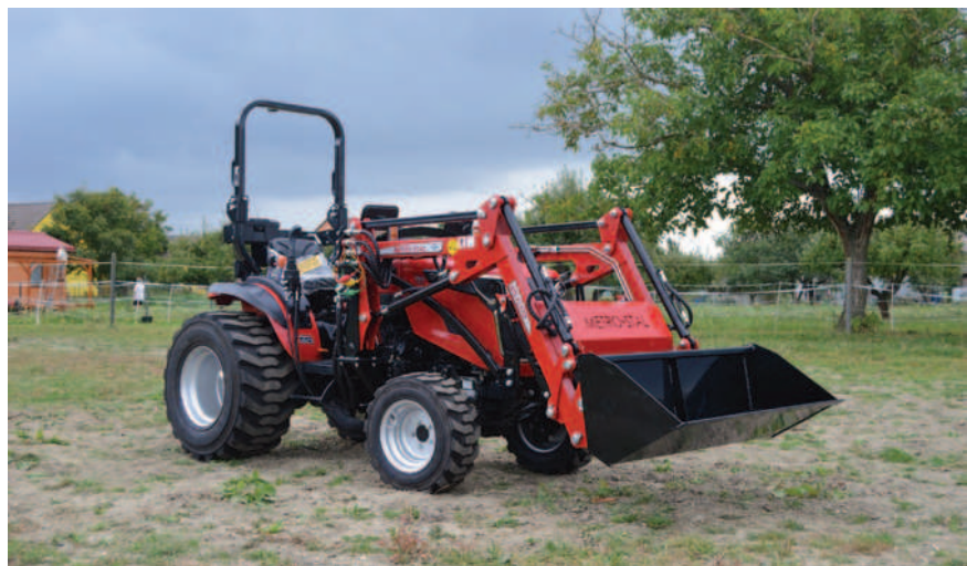
Obr.: Captain má 2 čerpadla – jedno na řízení a druhé na hydrauliku, což pocítíte hlavně když máte čelní nakladač a lehce se vám otáčí s volantem.
