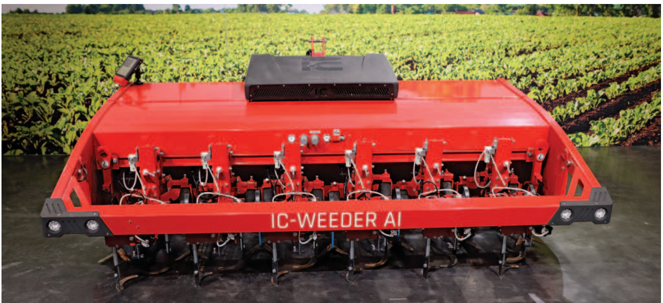
Obr.: Plečka je osazena vícero kamerami, jejichž počet se odvíjí od pracovního záběru stroje. Kamery jsou zakryté, aby nedocházelo k jejich oslnění slunečním zářením.
