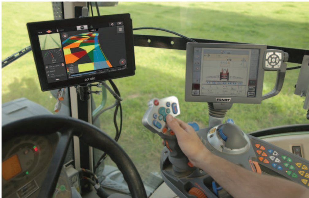
Obr.: Všechny důležité informace týkající se přesného postřiku lze sledovat na terminálech ISOBUS CCI 800 nebo 1200.
