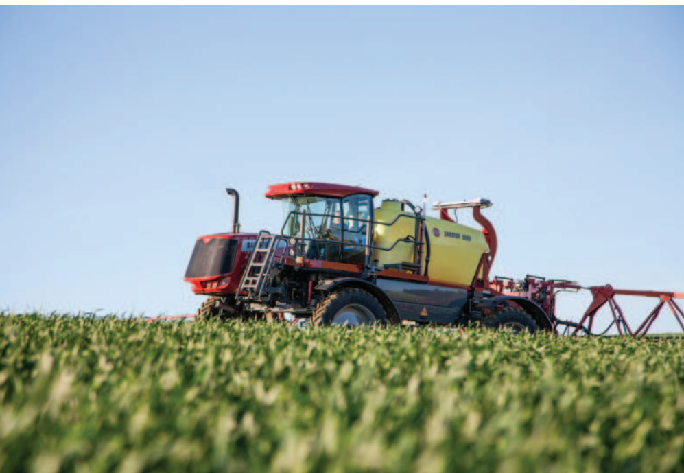
Obr.: Hmotnost samojízdných postřikovačů se pohybuje okolo 13 tun (bez kapaliny v nádrži) – hmotnost je rozložena v poměru 50:50.
