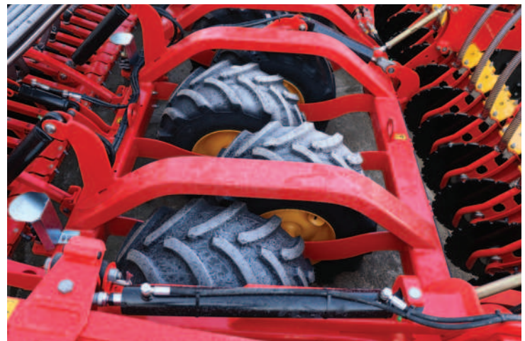
Obr.: Půdu mezi předním nářadím a secími botkami utužují velká pěchovací kola. Prostřední odpružená kola současně slouží pro přepravu stroje po silnici.
