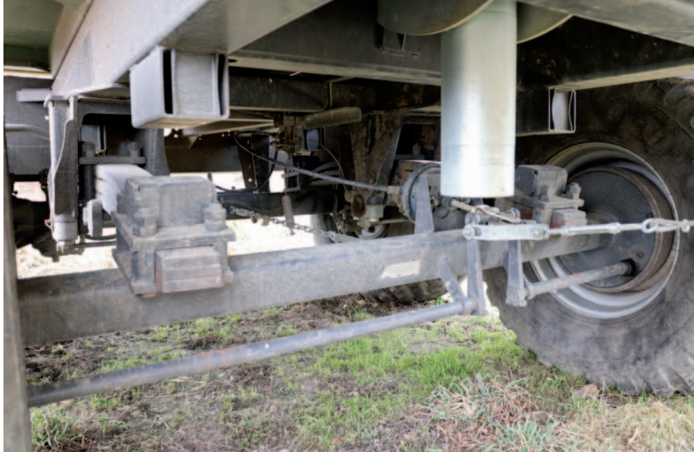
Obr.: Návěs využívá tandemového podvozku s odpružením Titan pro překonávání velkých terénních překážek.
