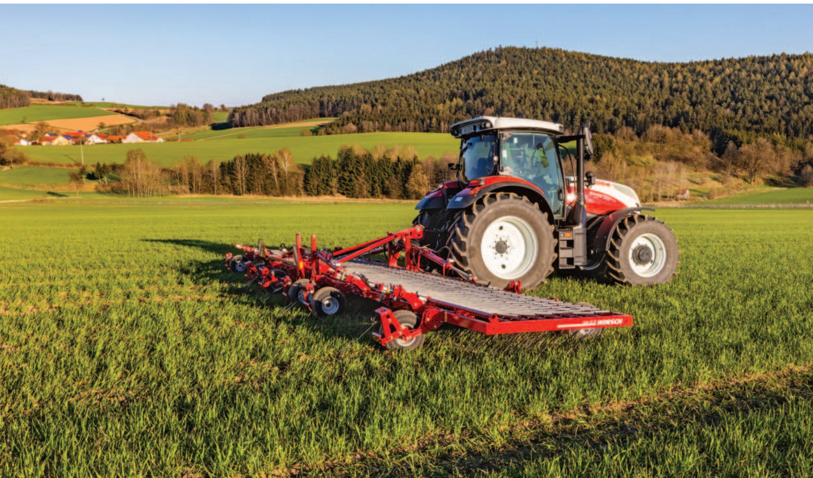
Obr.: Prutové brány Horsch Cura ST se vyrábí v neseném provedení v záběrech 6, 9, 12, 13 a 15 metrů a tažené se vyrábí v záběru 24 metrů.
