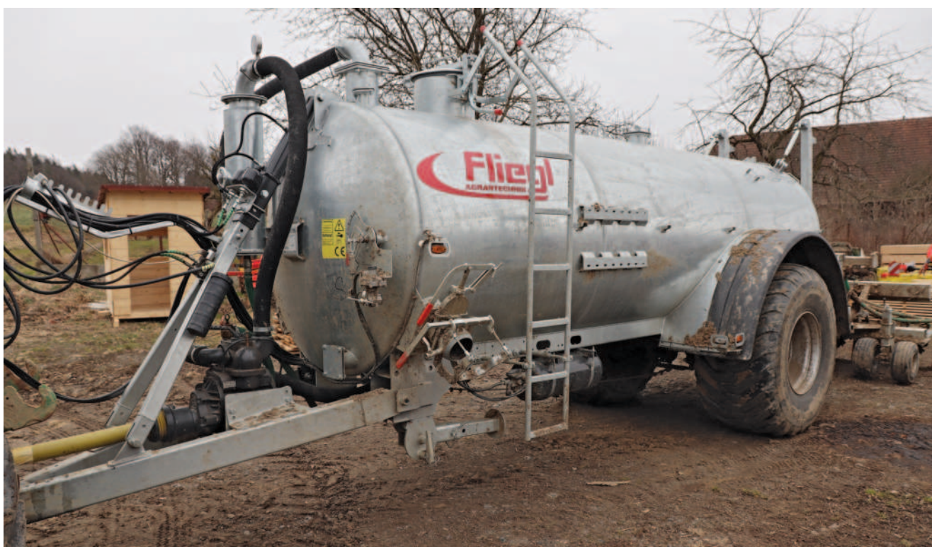
Obr.: Loni v létě byla pořízena jednonápravová podtlaková cisterna Fliegl VFW Jumbo Line s objemem nádrže 10 600 litrů.
