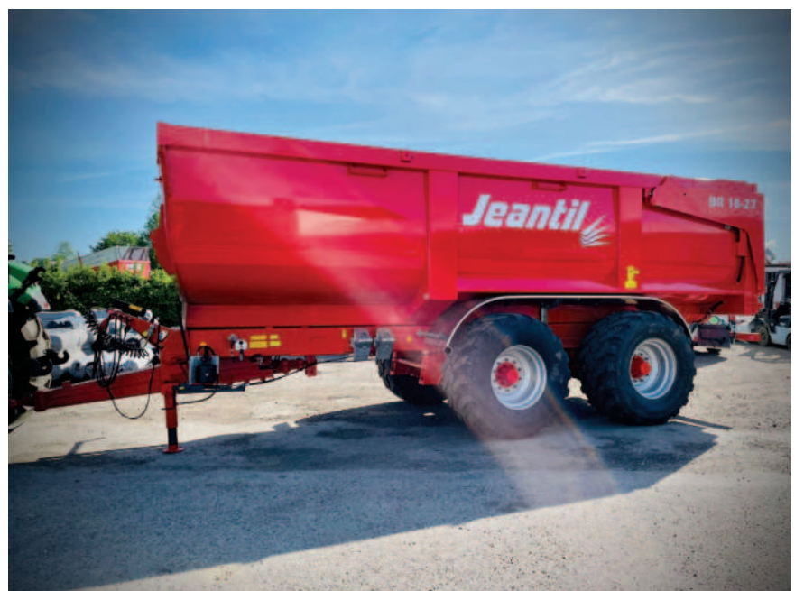
Obr.: Ve výrobním programu nalezneme i řadu velkoobjemových návěsů BR s vanovým typem korby a jednostranným sklápěním pro přepravu jakéhokoliv druhu materiálu.
