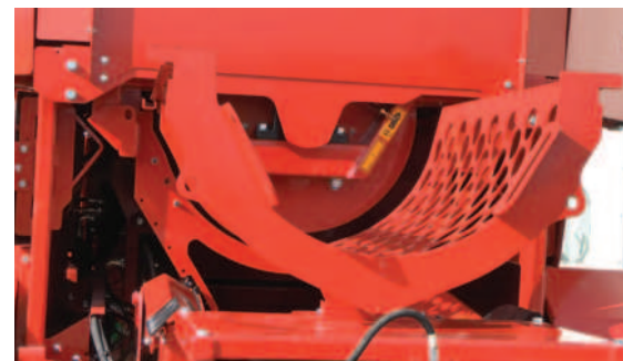
Obr.: Délku řezanky určují dvě síta, která tvoří půlkruh kolem spodní poloviny rotoru.
