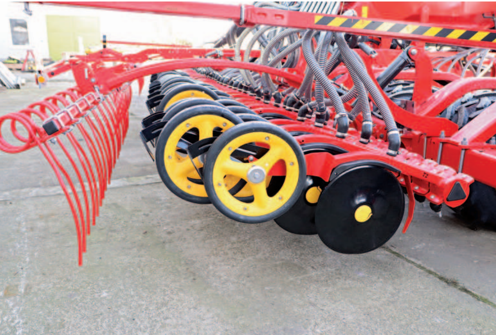
Obr.: Rychlé a přesné setí bez ucpávání provádí 380mm disky. Opětné utužení zajišťuje pýchovací kolo každé secí botky.
