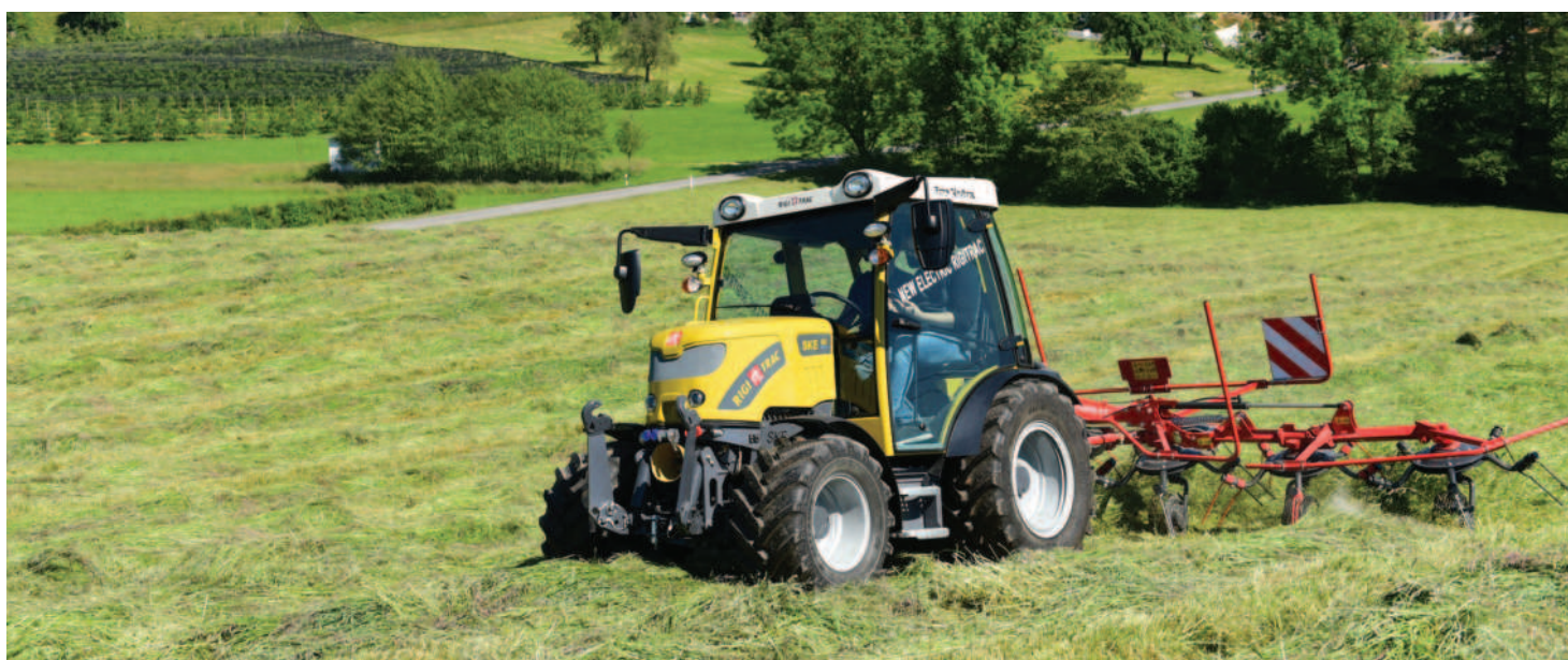
Obr.: Traktor využívá baterie s velmi dobrým poměrem hmotnost/energie. Umístěné jsou vpředu a podél podvozku stroje.
