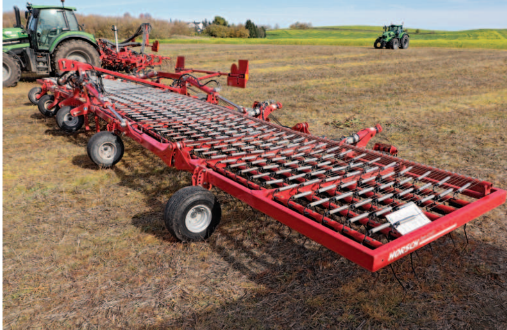
Obr.: Pružinový systém zajišťuje regulaci tlaku na špičce prutu, aby bylo možné zpracovávat půdu do hloubky pouze 2 cm. Uvnitř velké pružiny, jež pohlcuje větší síly, se nachází ještě jedna malá pružina pohlcující menší síly.
