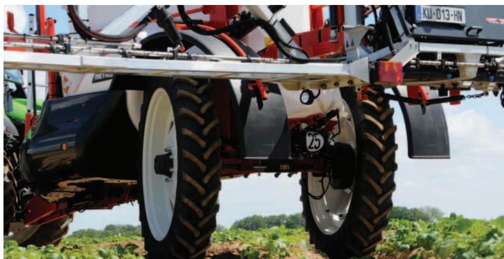
Obr.: Systém TRACKASSIST zajišťuje kopírování kolejových stop traktoru.
