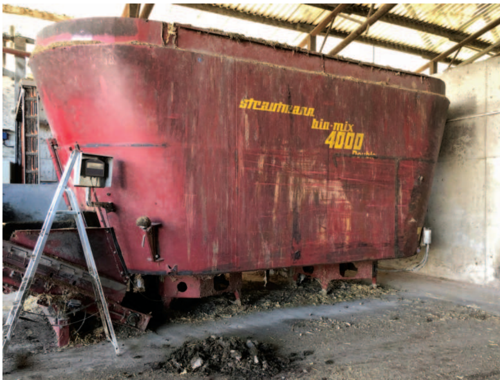
Obr.: Mísic na organické hnojivo používaný ve firmě Zera, Ratíškovice. Původní vnitřní vyložení vyrobené z nerezové oceli typu 304 (18 % Cr, 8 % Ni) mělo životnost pouze 8 měsíců.
