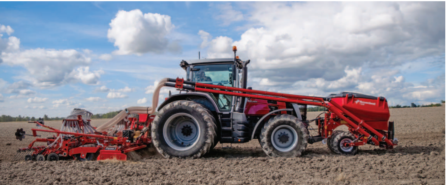
Obr.: Čelní zásobník f-drill snadno poslouží při variabilní aplikaci hnojiva u pásového zpracování půdy a v kombinaci se secí lištou i jako secí stroj s možností variabilního dávkování osiva.
