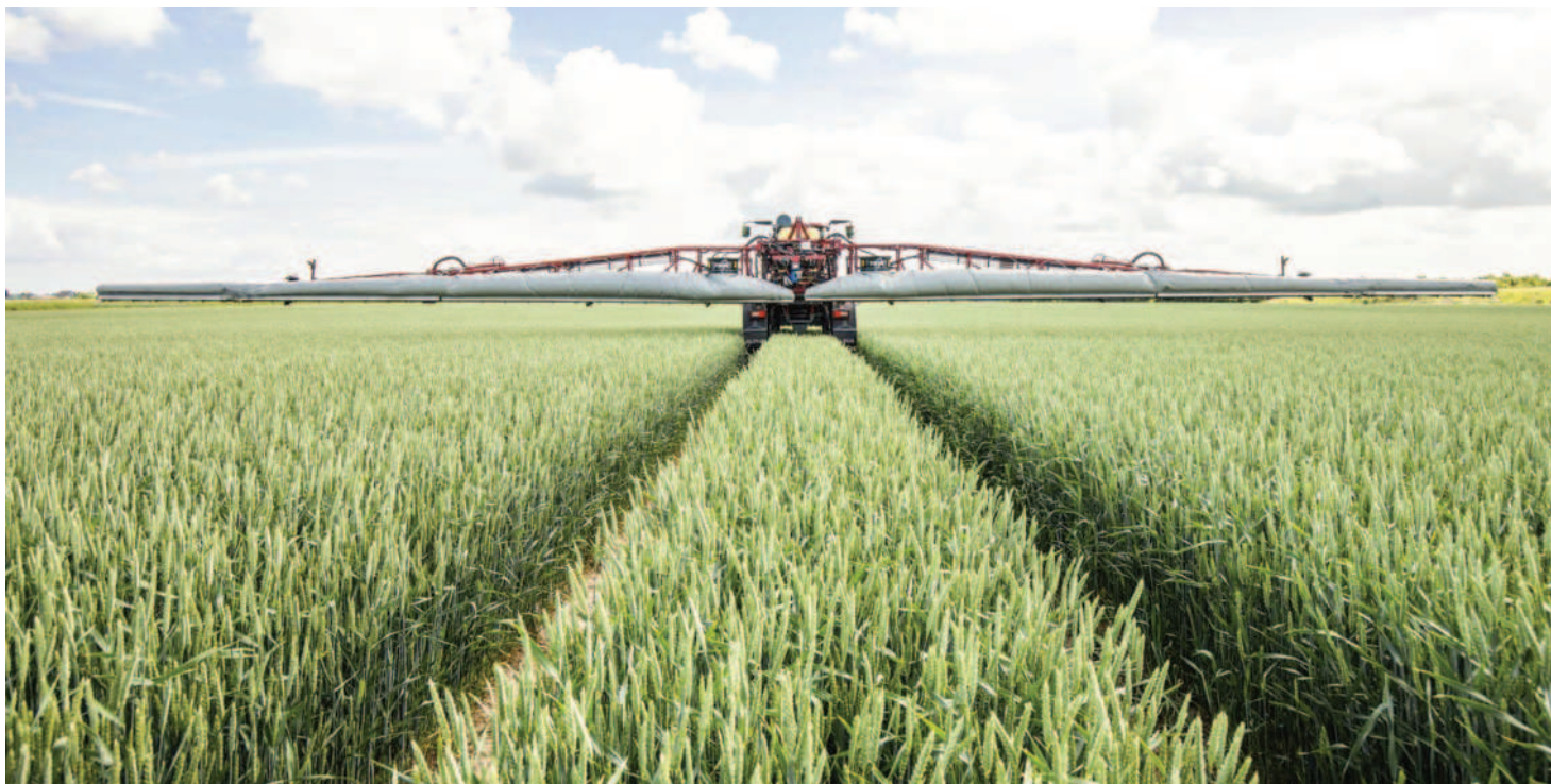
Obř. Samojízdné postřikovače jsou také vybavené systémem řízení ramen.
