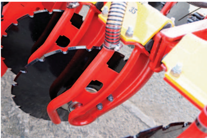
Obr.: Disk s přihnojovací botkou. Hnojivo je umísťováno do 5 cm širokých pásů v řádkové rozteči 125 mm před každým vysévaným řádkem.
