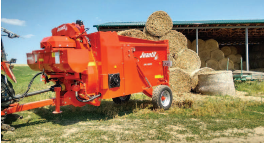
Obr.: Jeantil vyrábí rozdružovače balíků s různými objemy ložné plochy od 2 m 3 do 6 m 3 v závislosti na modelu.
