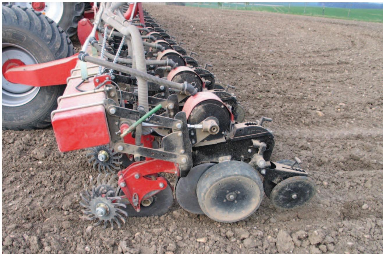
Obr. 3: Secí stroj s dvoukotoučovými secími botkami, opěrnými koly, které působí jako omezovače hloubky setí (umožňují dodržet zvolenou hloubku setí na pozemcích s různým odporem půdy vůči pronikání kotoučů do půdy) a přítlačnými koly. Předřazené šikmo postavené kotouče s prsty jsou určeny pro odhrnování rostlinných zbytků do stran v pružích před vlastními secími botkami.
