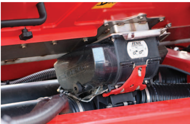
Obr.: Dávkování osiva obstarává systém Fenix II umožňující velký výsevek při vysoké rychlosti jízdy.
