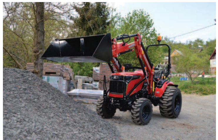
Obr.: Malotraktor Captain je možné vybavit čelním nakladačem s nosností 300 nebo 500 kg.
