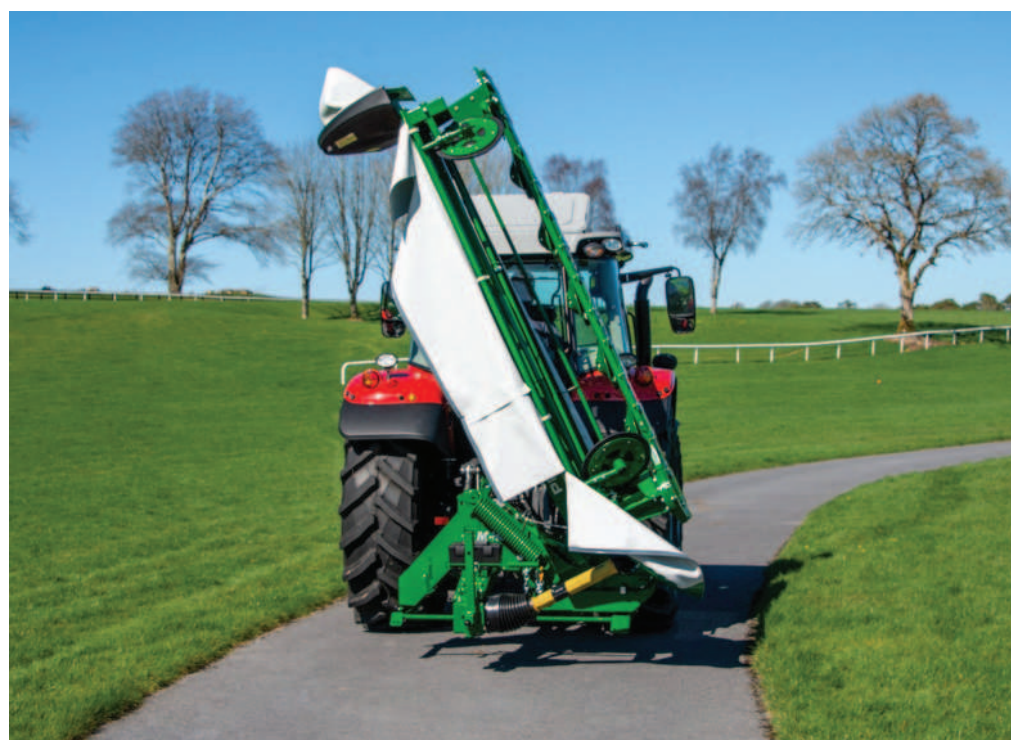
Obr.: Pro přepravu se žací stroj sklápí směrem vzhůru.
