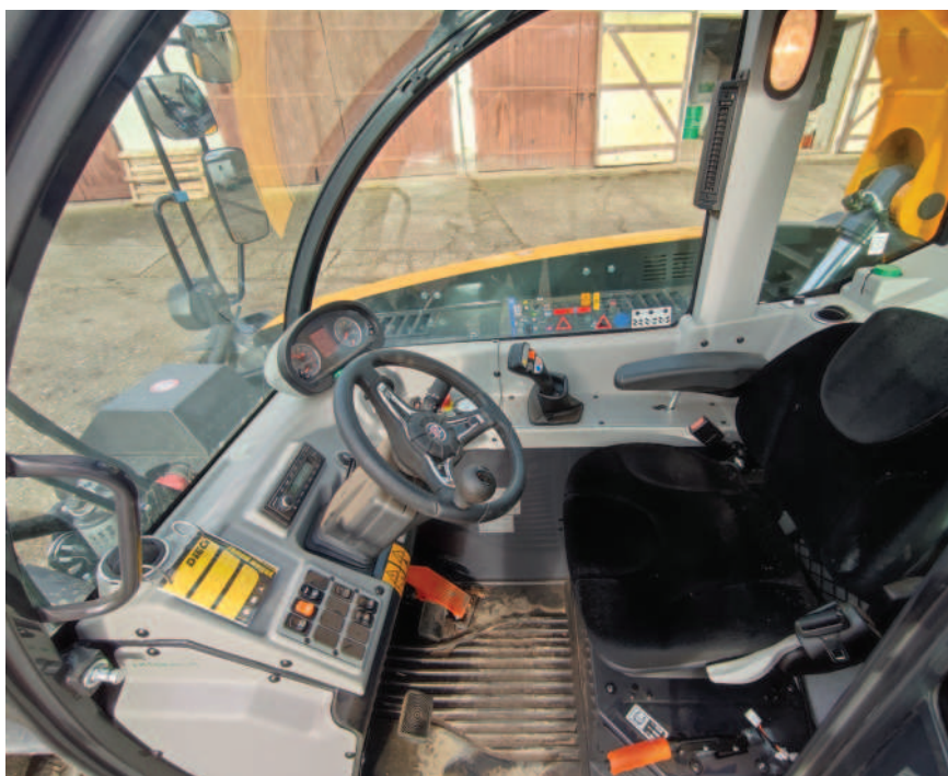
Obr.: Kabina je odhlučněna a uvnitř nalezneme nastavitelný volant, klimatizaci a sedadlo s mechanickým nebo vzduchovým odpružením.
