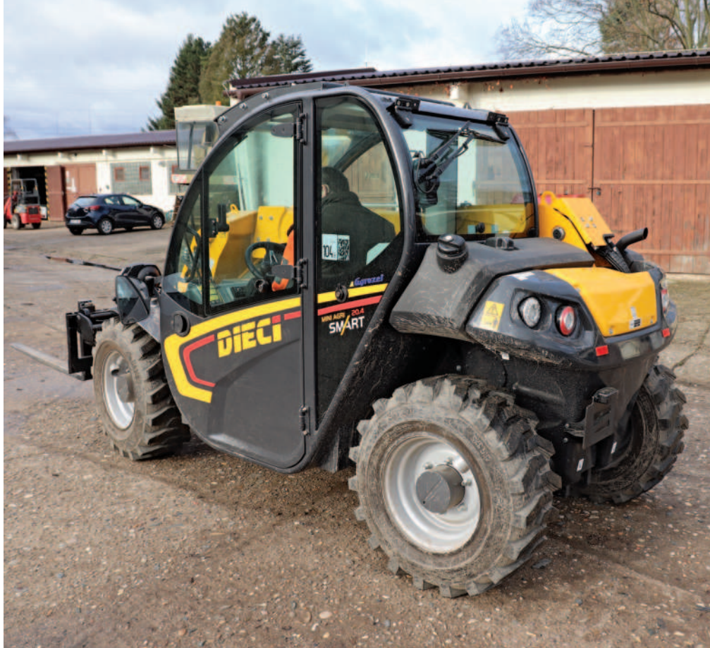
Obr.: Výška manipulátoru činí pouze 1,9 metru, šířka 1,5 metru a délka 3,5 metru.
