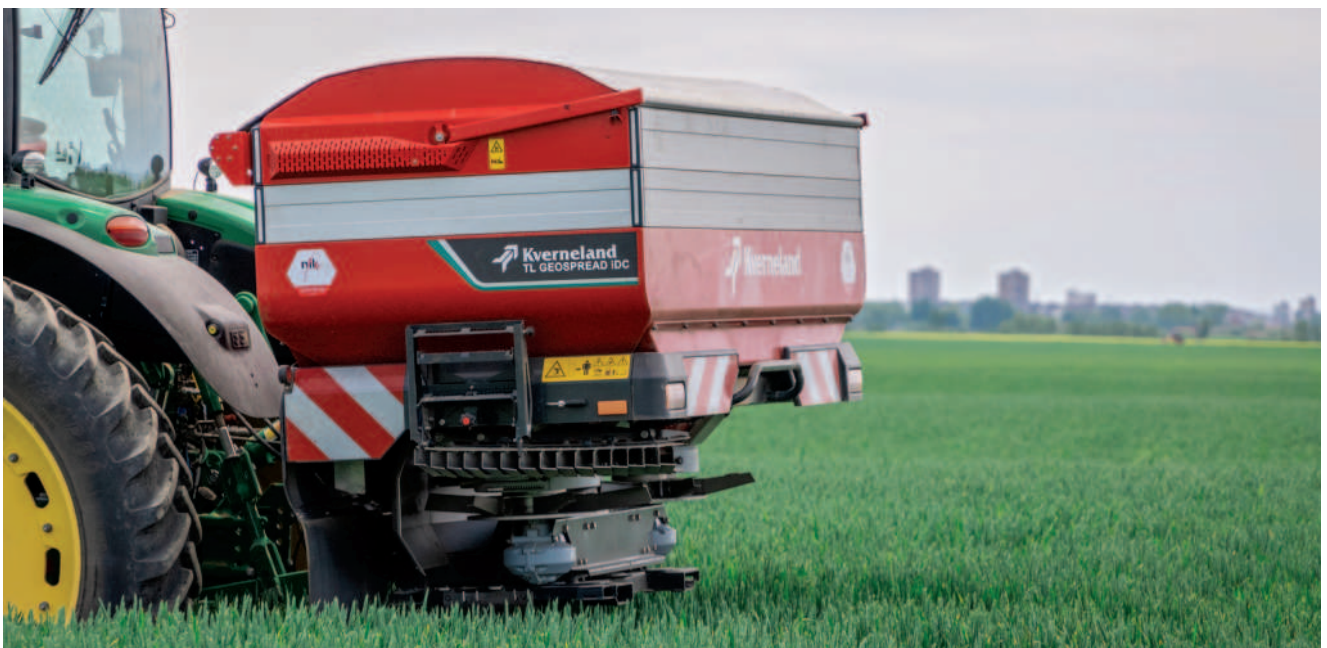
Obr.: Rozmetadlo Kverneland Exacta TL GEOSPREAD iDC je oproti svému předchůdci vybaveno kompletním centrálním hydraulickým pohonem rozmetacích kotoučů.
