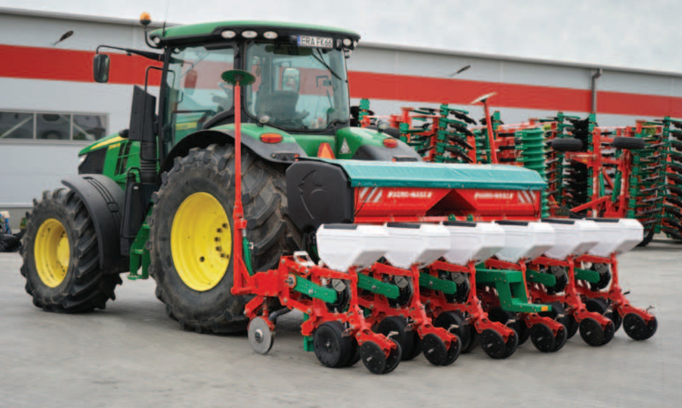
Obr.: Přesný secí stroj AGRO-MASZ Falcon je k dostání se čtyřmi, šesti nebo osmi výsevními sekcemi.
