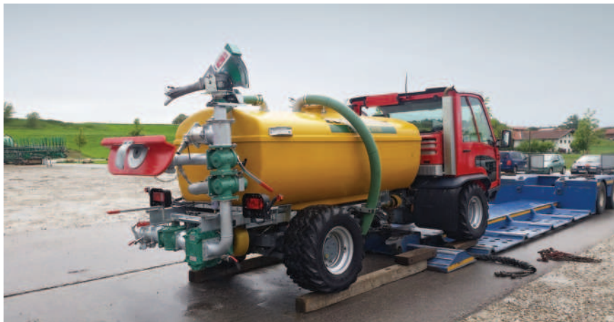
Obr.: Tažené cisterny Zunhammer různých objemů jsou lehké díky kompozitovému materiálu GFK.
