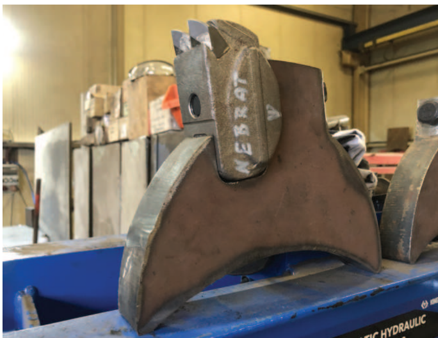
Obr.: Držák zubu – Hardox 500.
