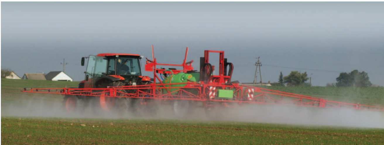
Obr.: Tažené postřikovače lze vybavit nejmodernějšími technologiemi včetně rozhraní ISOBUS.
