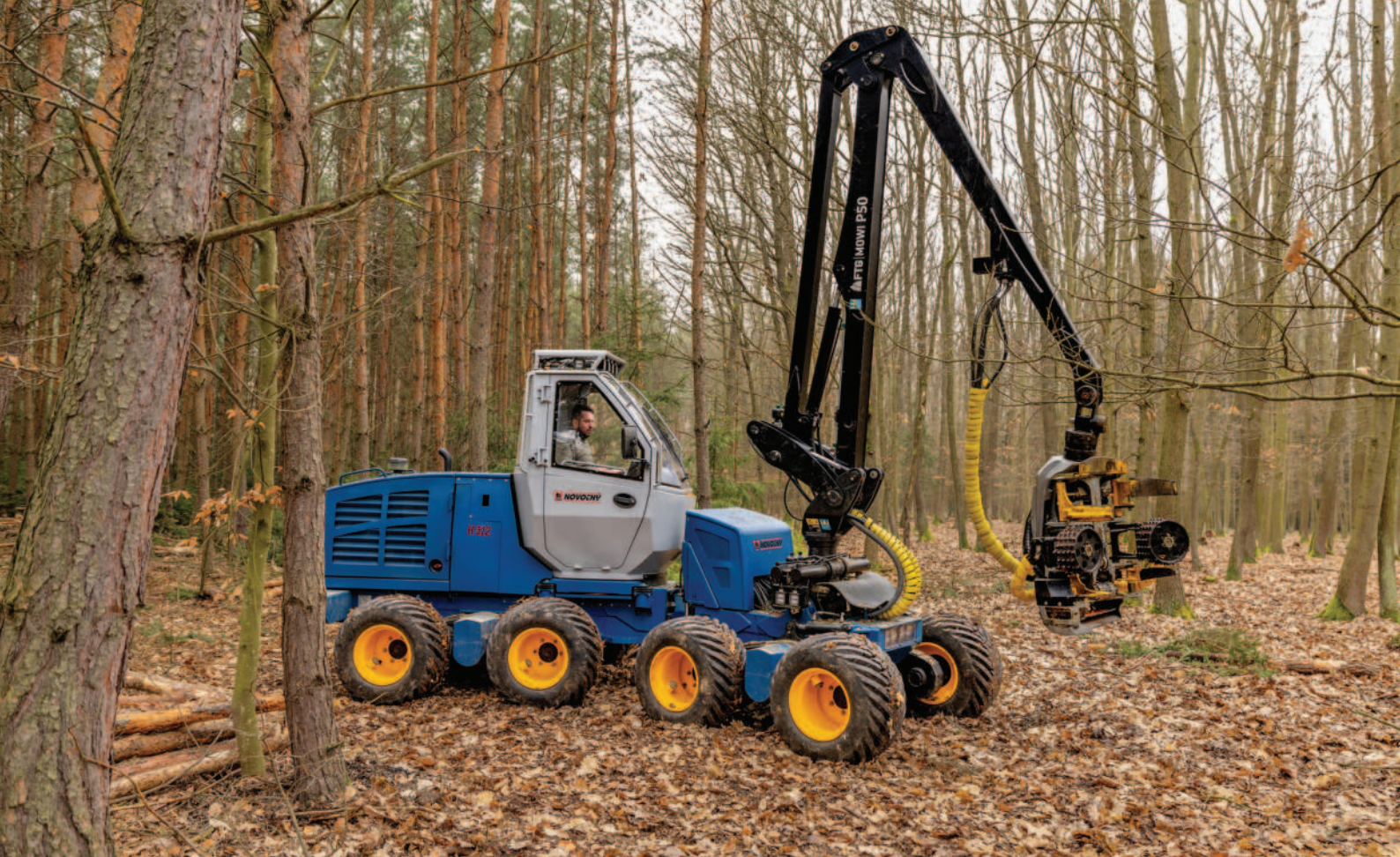
Obr.: Charakteristickým znakem nového harvestoru je osmikolový podvozek.
