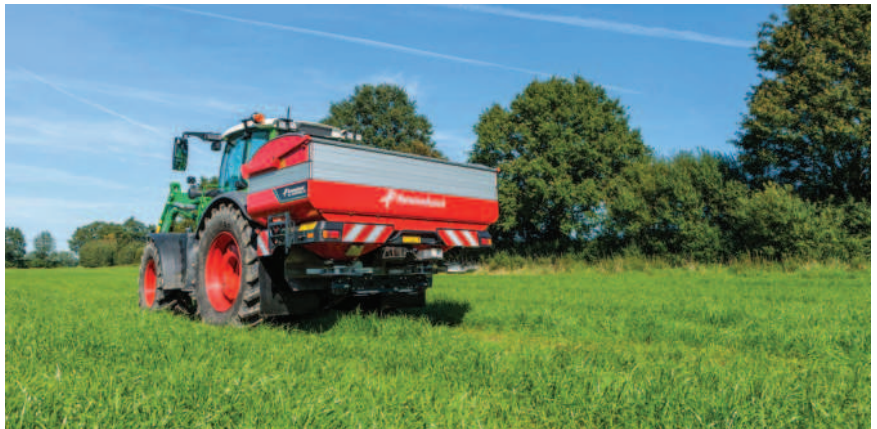
Obr.: Benefitem rozmetadla Kverneland Exacta TL GEOSPREAD iDC je možnost ovládní otáček levého i pravého kotouče nezávisle na sobě.
