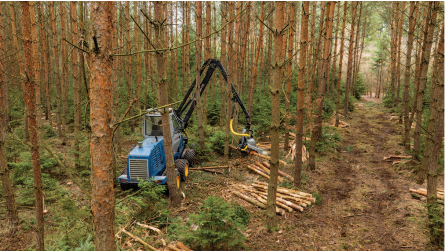
Obr.: Harvester je velmi obratný díky malému poloměru zatáčení a šířce stroje, která dosahuje hodnoty 2,1 m na 500 mm pneumatikách.
