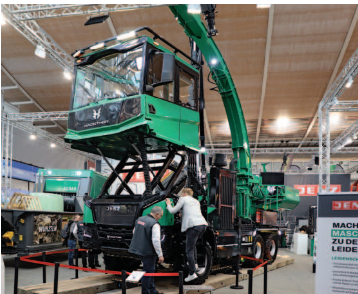
Obr.: Kabinu je možné zvednout až do výšky 4,70 m. Obsluze se tak nabídne dokonale výhled.
