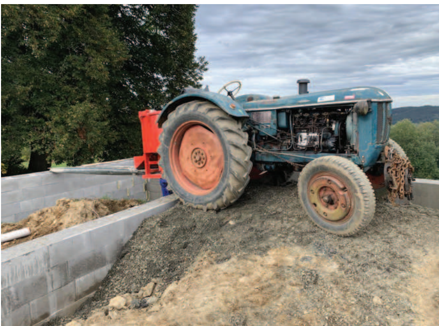
Obr.: Hanomag R435/45A s míchačkou na beton JAR-MET (350L).
