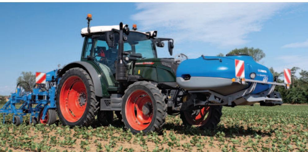
Obr.: Návštěvníci si budou moci prohlédnout čelní nádrž Lemken SprayHub se sadou SprayKit pro páskový postřik a ve spojení s mechanickou meziřádkovou plečkou Lemken EC Weeder.
