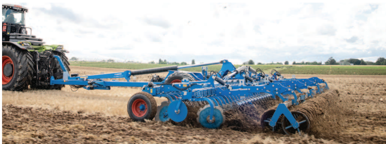
Obr.: Největším vystaveným exponátem na výstavní ploše společnosti bude velkoplošný diskový podmítač Lemken Rubin 10/1000 KUA s desetimetrovým pracovním záběrem.
