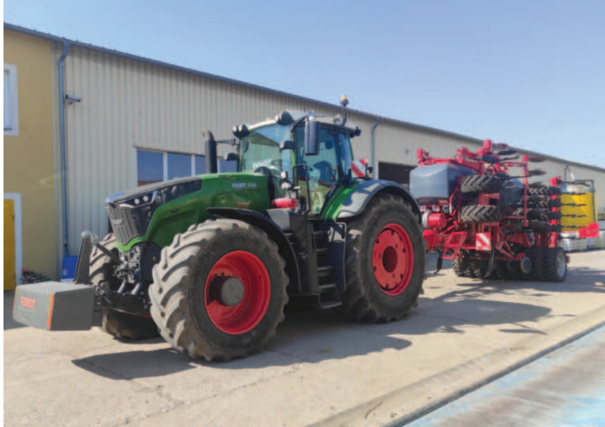
Obr.: Secí stroj Horsch Focus je agregován s traktorem Fendt 1046 o výkonu 476 koní.
