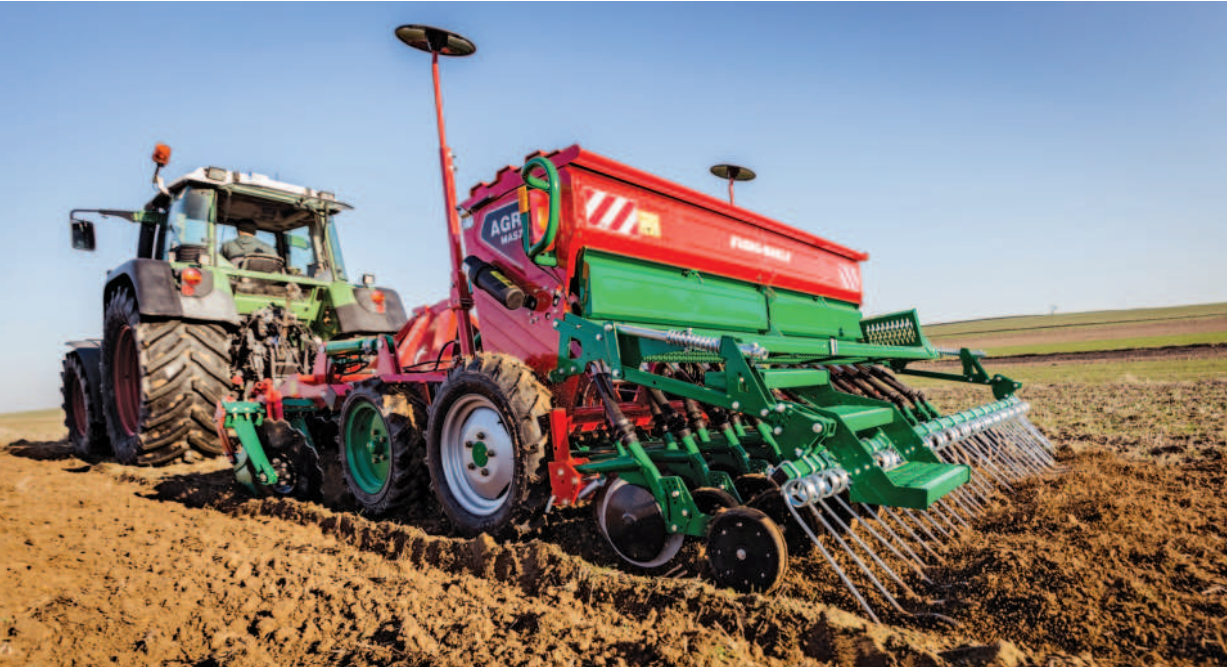
Obr.: Secí stroj AGRO-MASZ SR se vyrábí s pracovním záběrem 2,5 m, 2,7 m, 3 m, 3,5 m nebo 4 m se základním objemem zásobníku na osivo od 450 do 790 l.
