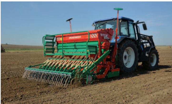
Obr.: AGRO-MASZ má v sortimentu nástavbový mechanický secí stroj SN použitelný v kombinaci s rotačními bránami nebo kypřiči.
