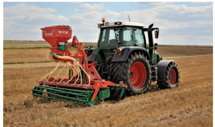
Obr.: Secí stroje a techniku na zpracování půdy lze také osadit secím zařízením pro aplikaci dalšího druhu osiva.
