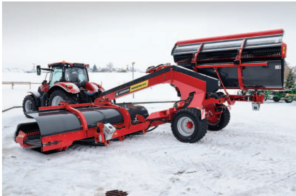
Obr.: Hydraulickým posunutím pásových jednotek do stran a změnou směru jejich otáčení se provádí změna vytváření řádku. Foto Milan Jedlička
