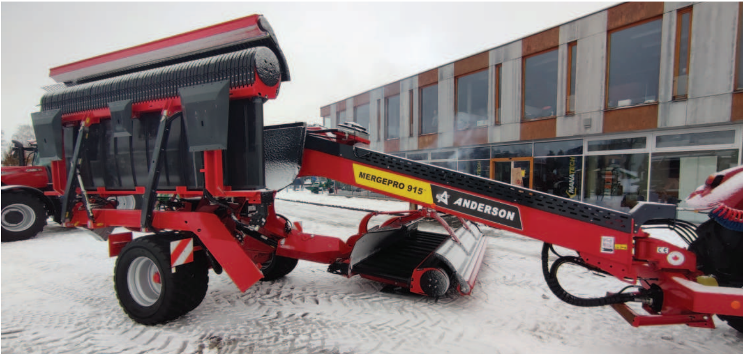
Obr.: Šestiřády sběrač je bezvačkový, takže je složen z nižšího počtu součástek a je tedy kompaktní a robustní. Foto Milan Jedlička
