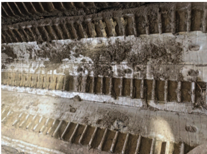
Obr.: Vyložení skeletu – Duroxite 100 a zuby hřebenu – Hardox 500 a Hardox 600.
