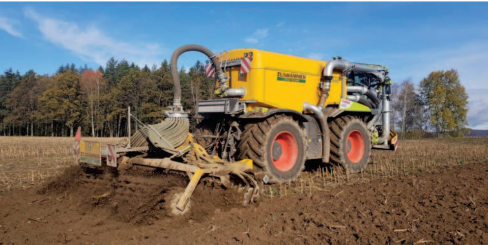
Obr.: Diskový injektor Zunhammer Kusgu dokonale zapraví hnojivo pod povrch.
