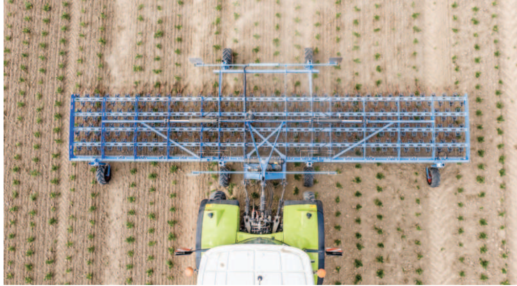
Obr.: Stroje využitelné nejen v ekologickém zemědělství budou prezentovat prutové brány Lemken Thulit 900 M pro mechanickou likvidaci plevelů.
