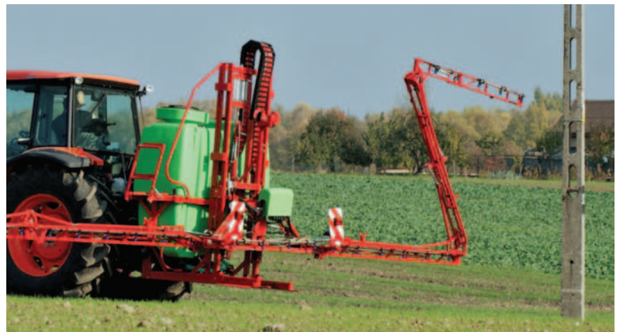
Obr.: U nesených strojů činí objem nádrže 400–1900 l.
