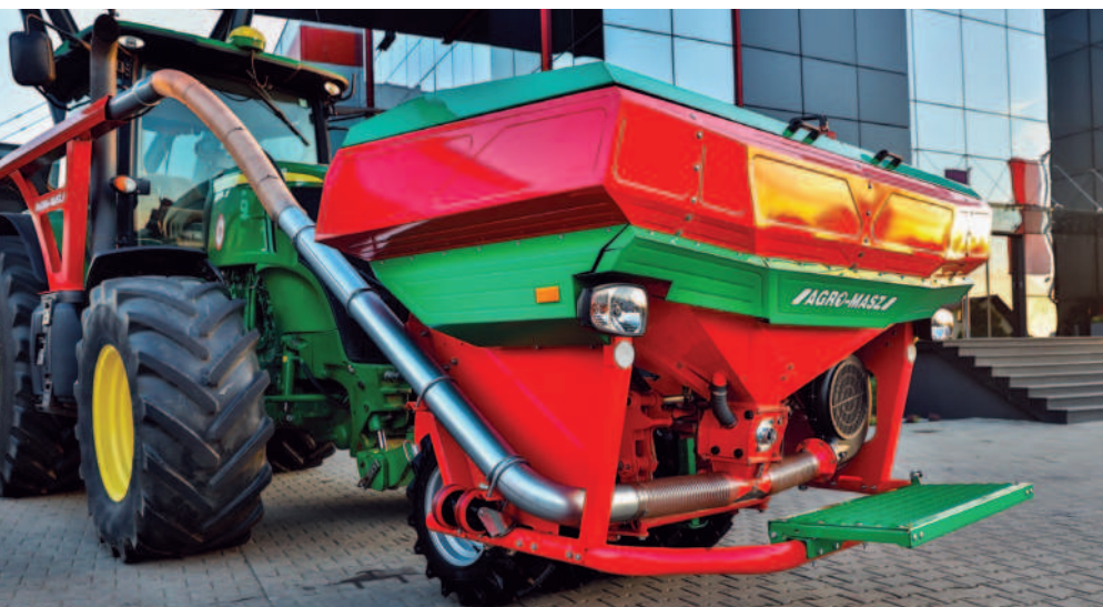
Obr.: Čelní zásobník AGRO-MASZ Ikar o objemu 1800 litrů je určen pro zavěšení do předního závěsu traktoru o výkonu 140 koní, takže funguje i jako závaží.
