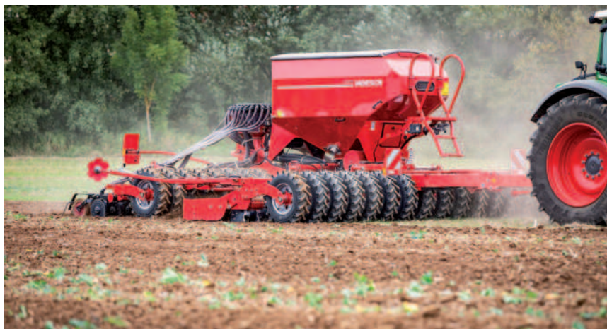
Obr.: Diskový secí stroj Horsch Pronto 6DC jedním pracovním přejezdem připraví setové lůžko, správně utuží půdu a vyseje osivo. Ilustrační foto.
