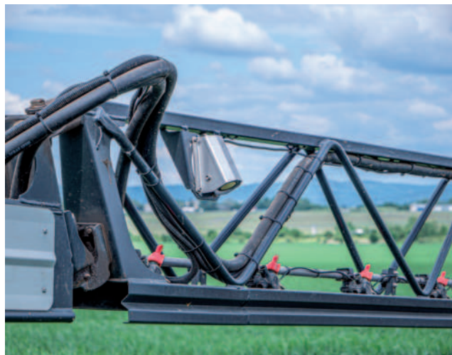
Obr.: Postřikovač využívá aktivní systém řízení ramen BoomControlPro. Na snímku senzor hlídající výšku a naklápění.
