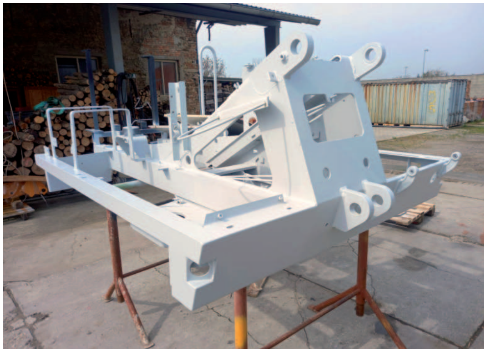
Obr.: Stroj bylo nejprve potřeba zcela umýt, vyčistit a odmastit. Dále bylo potřeba vše rozebrat, odvést na pískování a nalakovat.
