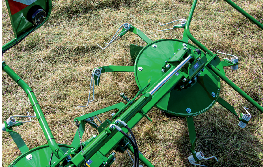
Obr.: Všechny obrabeče McHale ProPel jsou osazeny rotory o průměru 1,54 m.
