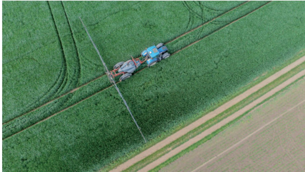
Obr.: Tažený postřikovač Horsch Leeb 4 AX disponuje pracovním záběrem 24 metrů.
