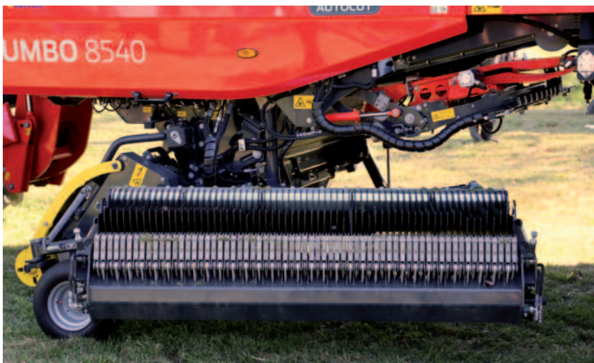
Obr.: Řezací ústrojí lze stisknutím tlačítka na boční straně vozu stranově vykývnout bez nutnosti použití nářadí. Vpravo nahoře můžeme vidět systém pro automatické broušení nožů Pöttinger AUTOCUT.
