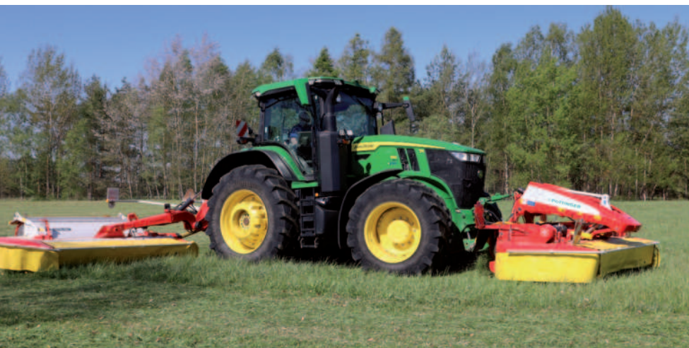
Obr.: Nízký travní porost sklídl traktor John Deere 7R 330 se žací trojkombinací Pöttinger tvořenou zadní kombinací NovaCat V 8400 ED a čelním žacím strojem NovaCat 301 AlphaMotion Pro.
