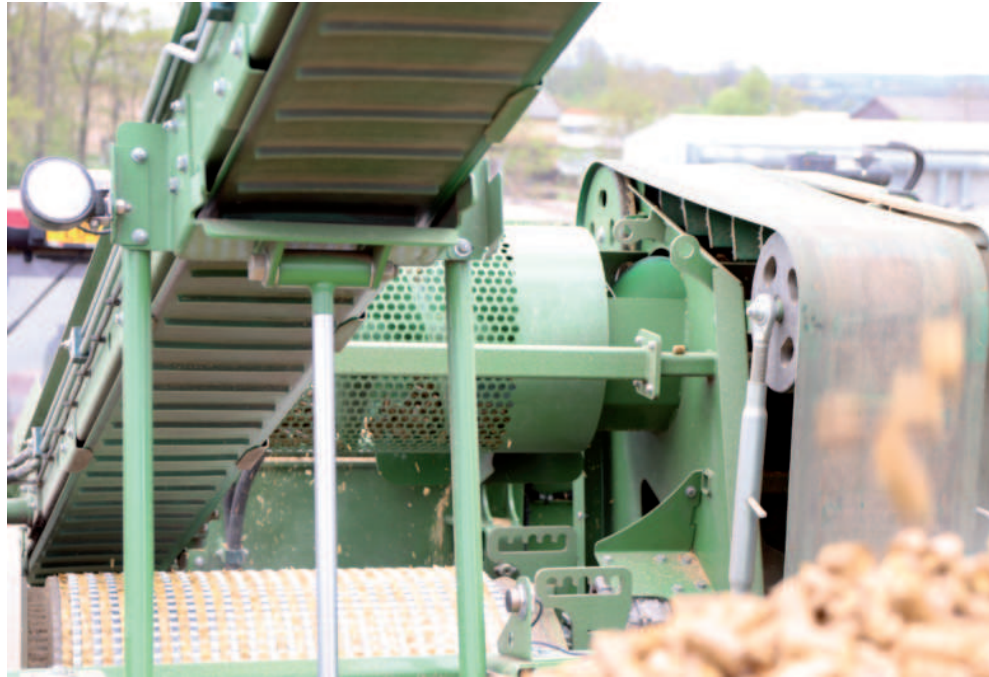
Obr.: Při průchodu síťovým bubnem jsou pelety zbaveny prachu. Přebytečný materiál padá dolů zpět na dopravní pás.
