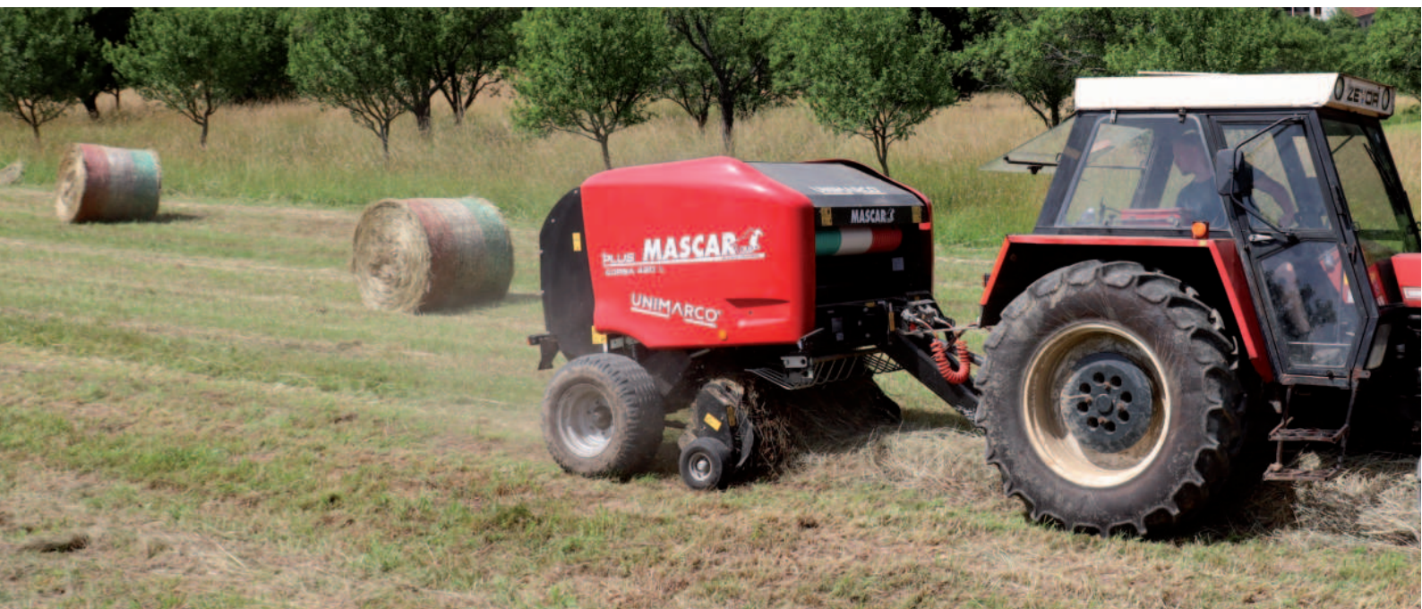
Obr.: Lis s pevnou lisovací komorou Mascar CORSA 420L Plus RETE. Pro dokonalé zabalení balíku využívá majitel síť NovatexWINNER NOVA v šířce 123 cm v barvách italské vlajky.
