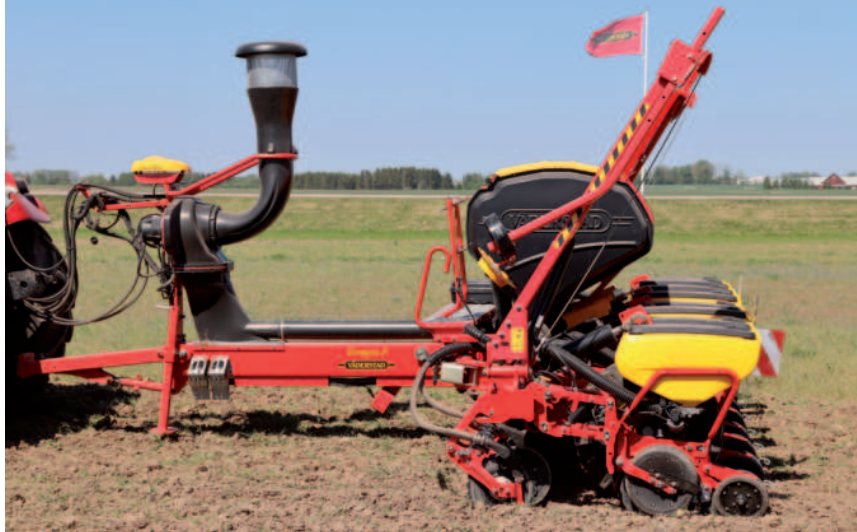
Obr.: Secí stroj Väderstad Tempo F 8 s novým elektronickým systémem WSX (s gyroskopem) s novými elektromotory a vylepšenou kabeláží.
