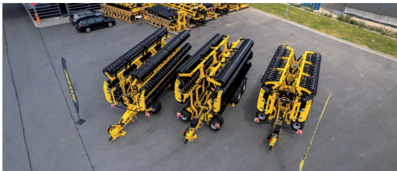
Obr.: Nakoupené stroje budou převážně používány pro první podmiítku po sklizni hlavní plodiny. I když jde o tři diskové podmiítače, každý je jiný.
