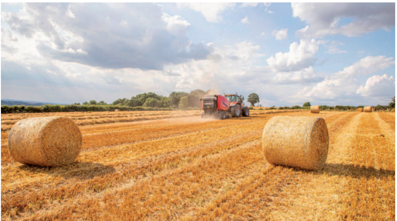
Obr.: Ve standardní výbavě lisu Kverneland 6716 PLUS je systém měkkého jádra balíku Intelligent Density 3D s možností předvolení nastavení lisu pro lisování jednotlivých druhů materiálu.
