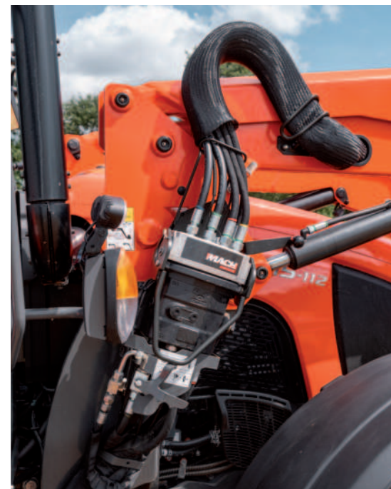
Obr.: Sružená bezúkapová rychlospojka MACH system.
