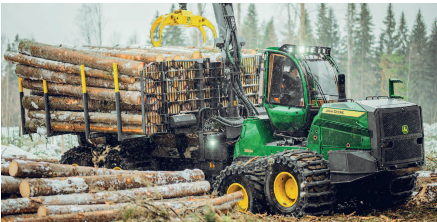
Obr.: Nové vyvážecí traktory mají zvýšenou nosnost a díky výsuvným klanicím rozšířenou nabídku nákladových prostorů o dvě nové velikosti.
