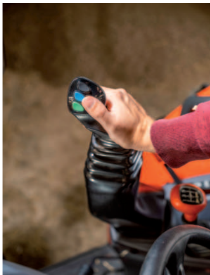
Obr.: Dvojice joysticků pro ovládání čelního nakladače. Vlevo základní ovládání PROPILOT, vpravo elektronické ovládání e-PILOT.
