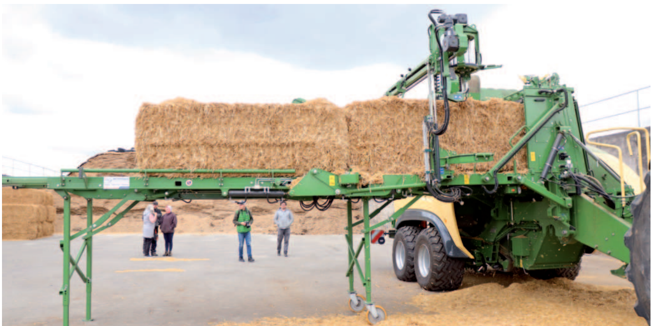
Obr.: Sklopný hydraulický podávací stůl se systémem pro automatické odstranění motouzu z balíku.
