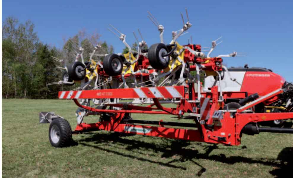
Obr.: Obracení posečené hmoty zajistil Zetor Proxima HS 110 s taženým desetitorovým obracečem Pöttinger HIT HT 11100.
