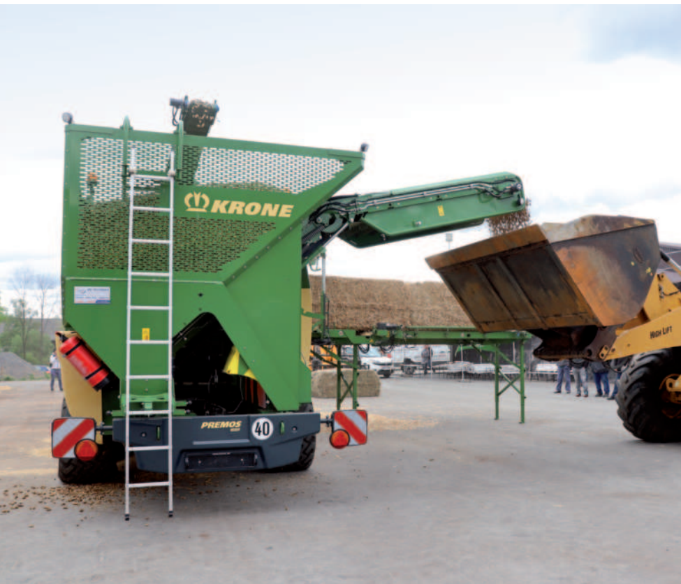
Obr.: Zásobník na pelety má objem 9 000 l. Vyprazdňovací dopravník s překládací výškou až 4 m umožňuje plnění všech obvyklých zemědělských návěsů.
