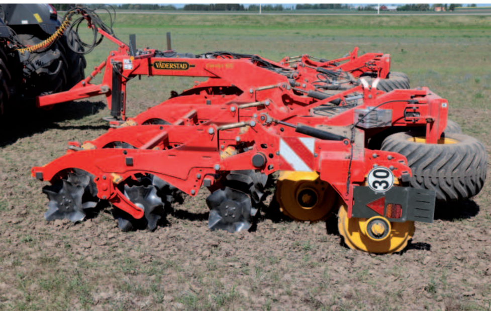
Obr.: Od ostatních podmítačů Carrier se nový model odlišuje třemi řadami disků namísto dvou.
