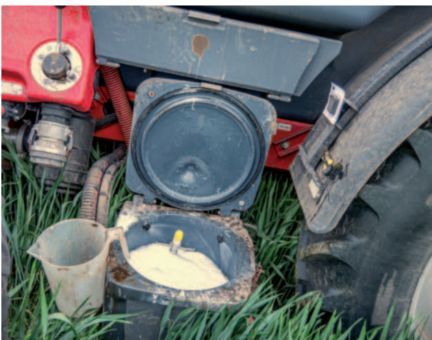
Obr.: Naplavovací šachta je v plastovém provedení o objemu 36 l a nabízí různé funkce.
