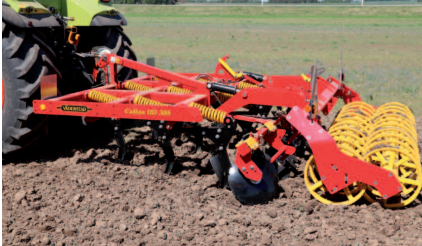
Obr.: Úzké kypřicí radličky u kypřiče Väderstad Cultus 300 HD slouží pro intenzivní prokypření půdy do hloubky až 30 cm.
