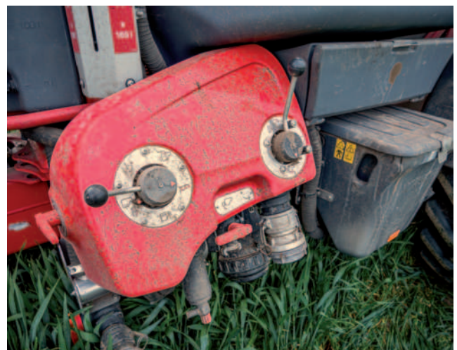
Obr.: Ovládací jak výtlačné, tak sací strany postřikovače se provádí mechanickými kohouty.
