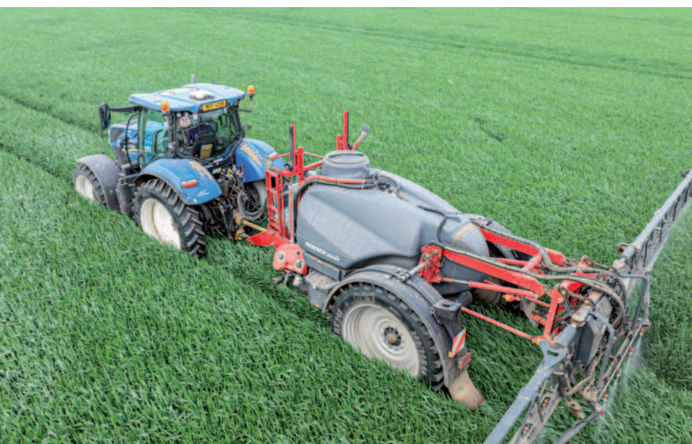
Obr.: BoomControlPro umí přizpůsobovat ramena v jedné úrovni po celém pracovním záběru.
