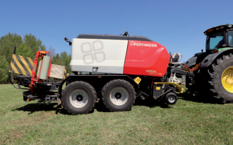
Obr.: Řádky hmoty slisoval traktor John Deere 6215R s lisem na kulaté balíky s variabilní komorou a integrovanou ovíječkou Pöttinger Impress 3160 VC PRO.
