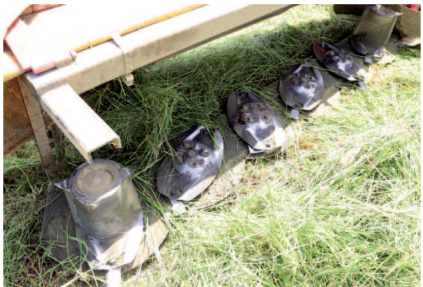
Obr.: Každý disk žací lišty má dva nože.
