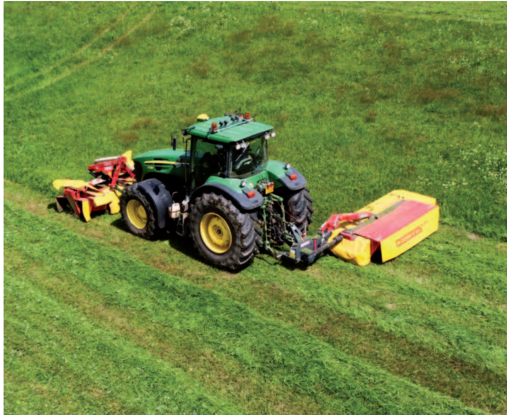
Obr.: Hmotnost stroje je 1 150 kg a vyžaduje minimální výkon traktoru 70 kW (95 HP).
