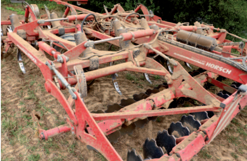
Obr.: TerraGrip s pružinovým jištěním a maximálním zdvihem 30 cm umožňuje radličce při přetížení se ihned uhnout překážce.
