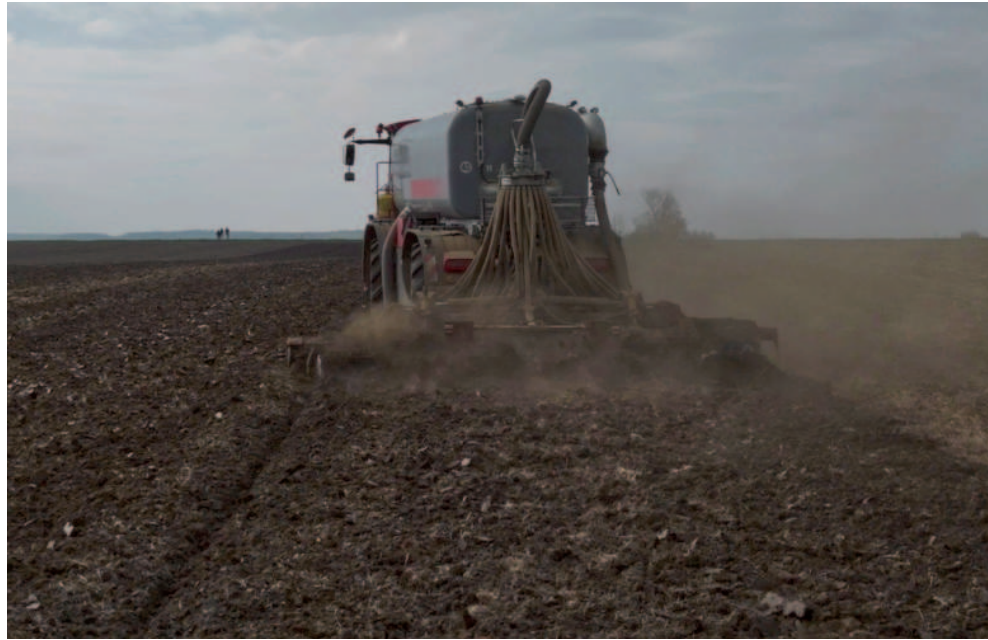
Obr.: Nářadí zůstává ve správné poloze i při jízdě v krabím režimu, kdy každé kolo tvoří vlastní stopu.
