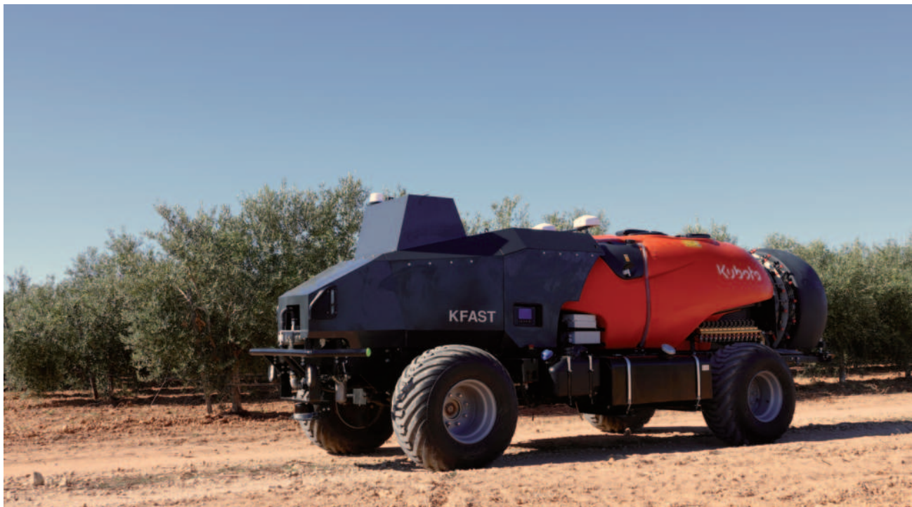
Obr.: Koncept robota KFAST, vyvinutý společnostmi Kubota a FEDE dokáže autonomně aplikovat fytosanitární ošetření. Foto: Kubota
