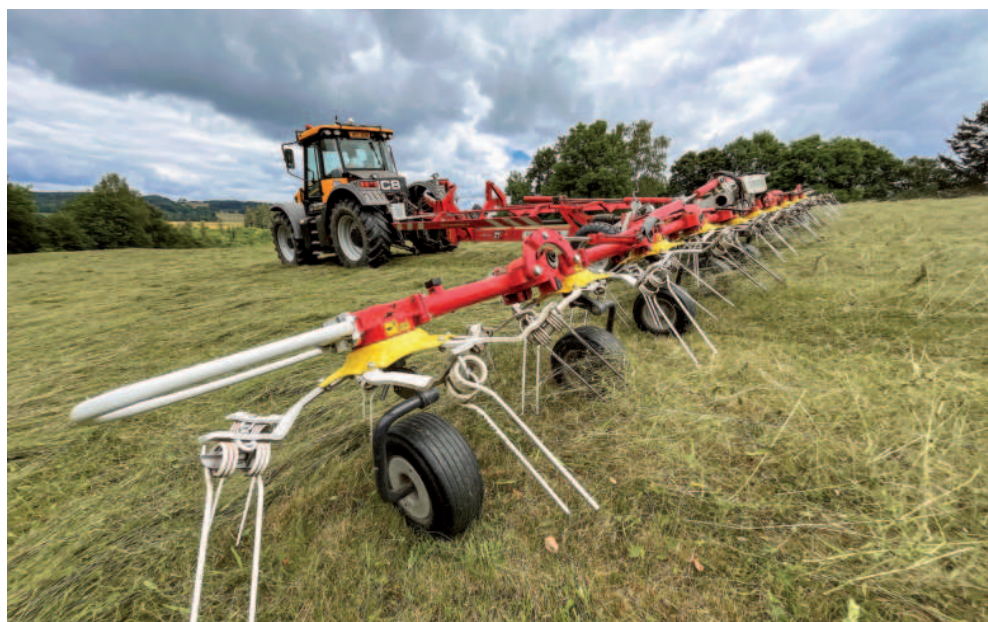
Obr.: Tažený desetirotorový obraceč HIT 10.11 T s pracovním záběrem 10,60 metru pracuje na farmě třetí sezonu. S traktorem 220 k vychází průměrná spotřeba 2,1 l naftu na hektar a zpracuje 8,7 hektaru za hodinu.
