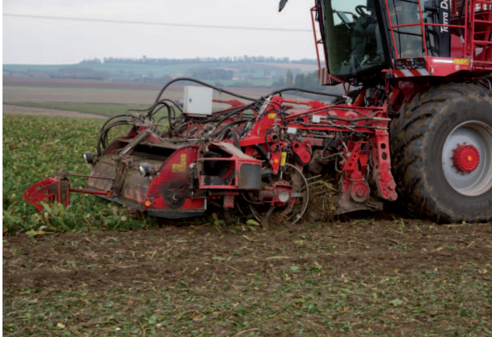
Obr.: Holmer Terra Dos 5 zvládne využívat 8, 9 a 12 řádkové vyorávací agregáty.
