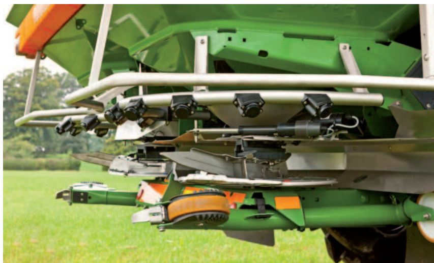
Obr.: Systém ArgusTwin zajišťuje online monitoring příčného rozhozu a následnou korekci systému zavádění.
