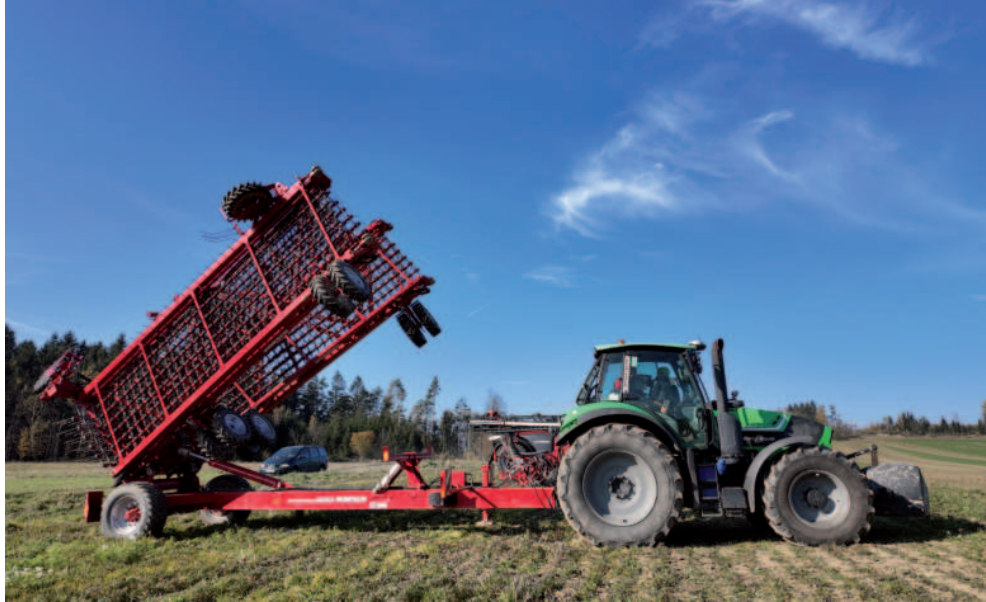
Obr.: Prutové brány Horsch Cura jsou k dostání s pracovním záběrem 15 a 24 metrů. Na snímku větší verze.
