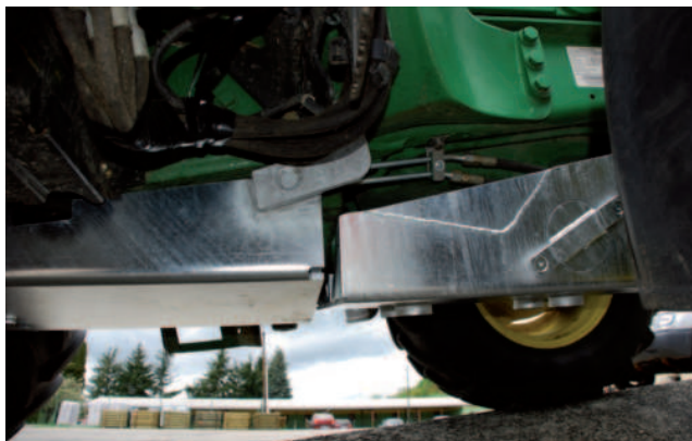
Obr.: Nástavby jsou zároveň zinkovány, což je chrání proti korozi a prodlužuje tak jejich životnost.
