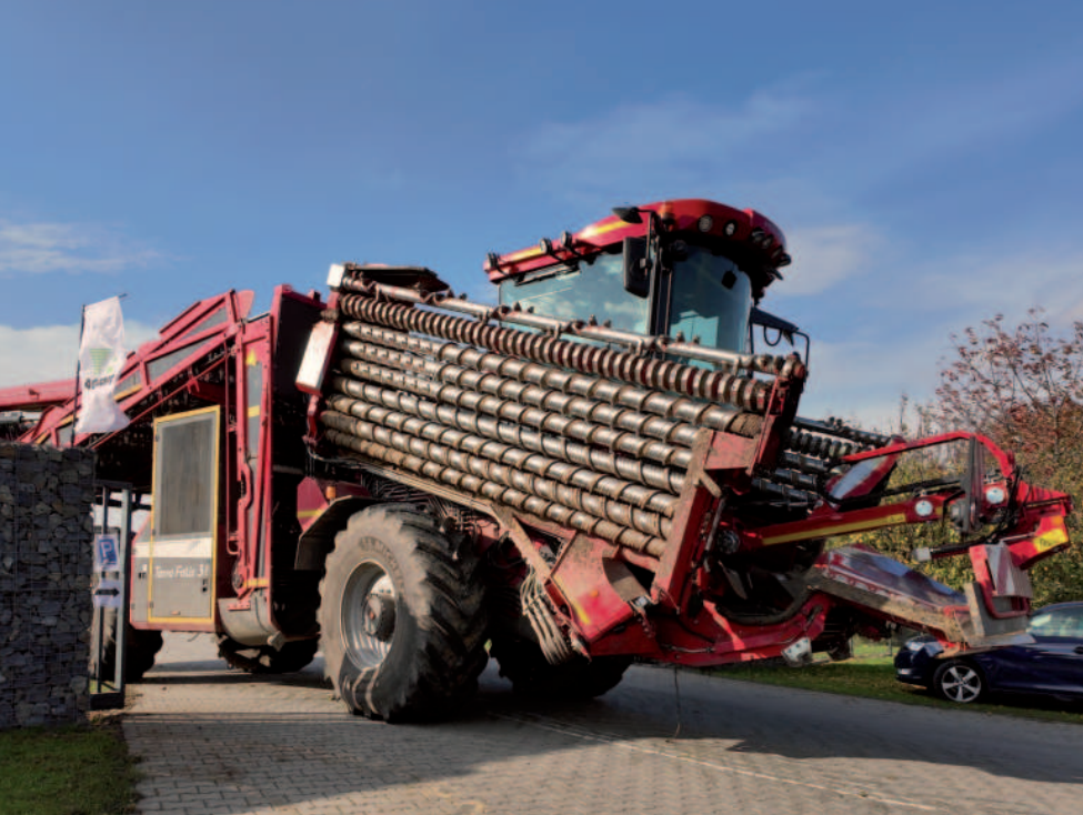
Obr.: Samojízdný nakládací čistič Holmer Terra Felis 3 evo v přepravní poloze při výjezdu z areálu společnosti AGROPT.
