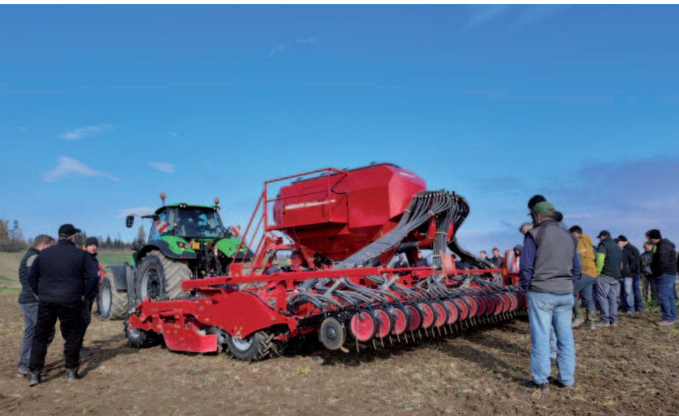
Obr.: Secí stroj Horsch Pronto 8 DC má ve výbavě dvě řady disků na zpracování půdy. Utužení povrchu zajišťuje zadní pneumatikový pěch.
