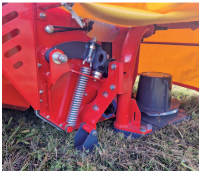
Obr.: Gumový válcový kondicionér lze snadno manuálně deaktivovat.
