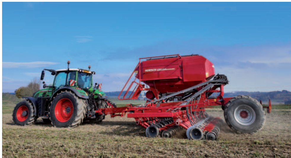
Obr.: Prakticky se představil secí stroj Horsch Avatar 6.16 SD, který má secí botky umístěné ve dvou řadách.
