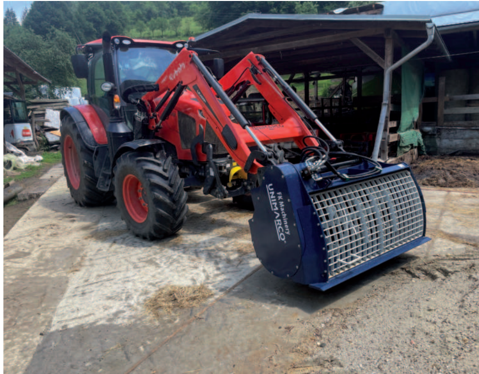
Obr.: Občas je čelní nakladač využit i s míchací lopatou na beton od výrobce FK Machinery, kterou taktéž dodala firma UNIMARCO.
