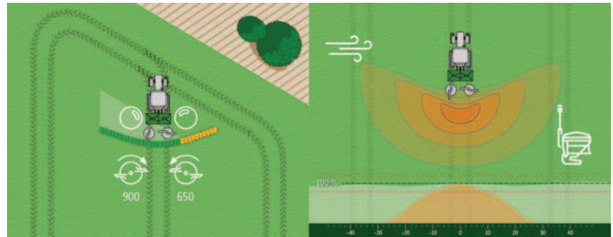
Obr.: Díky systému AMAZONE WindControl lze působení větru na rozmetací obrazec neustále monitorovat a automaticky kompenzovat.
