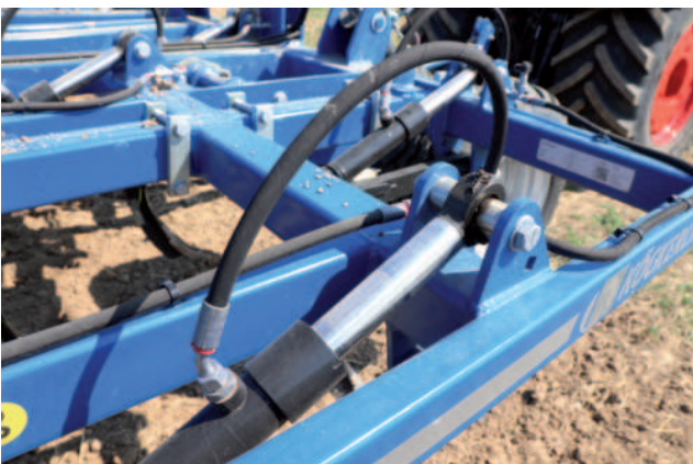
Obr.: Slupice jsou hydraulicky jištěné.
