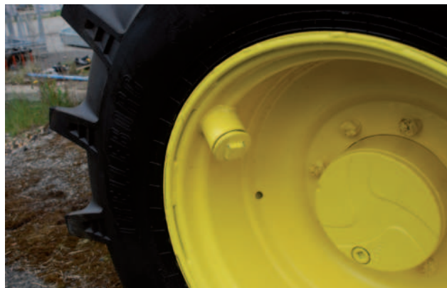
Obr.: Součástí nástavby jsou lesní pneumatiky s disky s ochranou ventilků.
