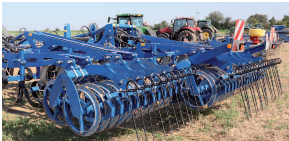
Obr.: Válce TT jsou určeny do těžších půd a postarají se o její agresivnější drobení.
