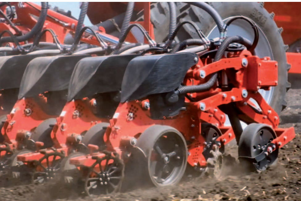
Obr.: Secí stroj Horsch Maestro 12 CV je vybaven i systémem AutoForce pro automatickou regulaci přítlaku botek na základě půdních podmínek. Ilustrační foto. Foto: Horsch / Youtube
