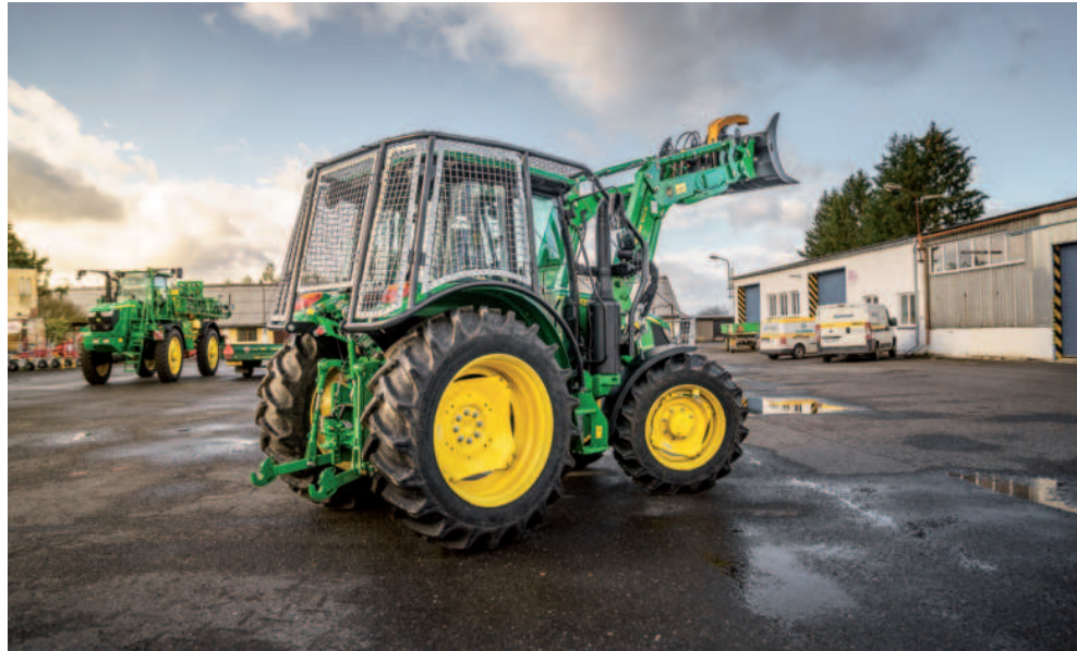
Obr.: Ochranný rám kabiny je zhotoven dle norem ISO 8083 a ISO 8084 (OPS, FOPS).
