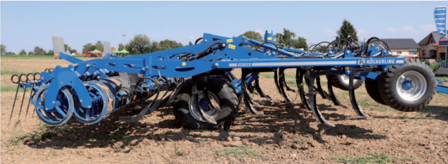
Obr.: Kypřič je tvořen čtyřmi řadami slupic, nivelátory, dále smykovou deskou, utužovacími válci a zavlačovači.
