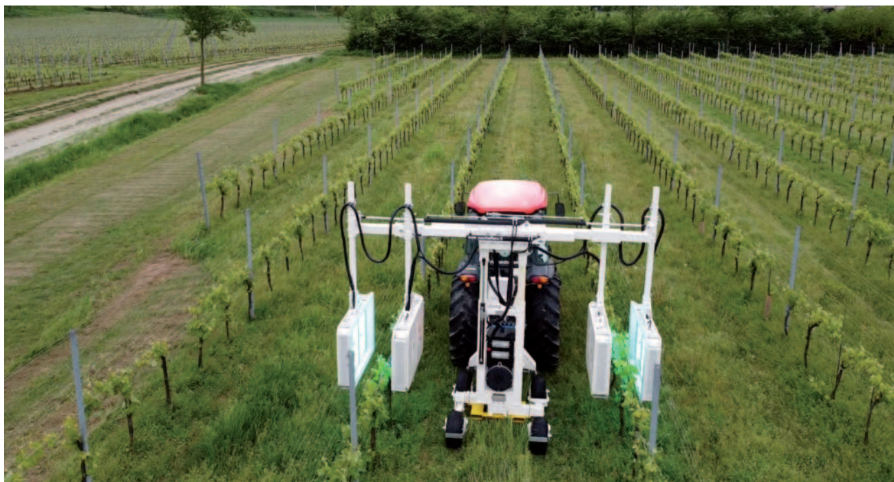
Obr.: Technologie UV Boosting představuje řešení pro stimulaci přirozené obranyschopnosti rostlin prostřednictvím záblesků UV-C záření. Foto: Kubota
