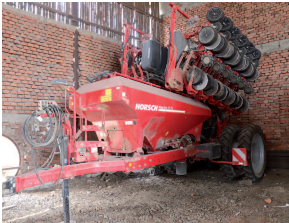
Obr.: V Dubicku využívají variantu secího stroje s centrálním zásobníkem s dvanácti výsevními jednotkami (při setí kukuřice) s možností výměny za osm výsevních jednotek (při setí cukrové řepy). Centrální zásobník je na hnojivo a každá secí jednotka má svůj zásobník na osivo. Foto: Milan Jedlička
