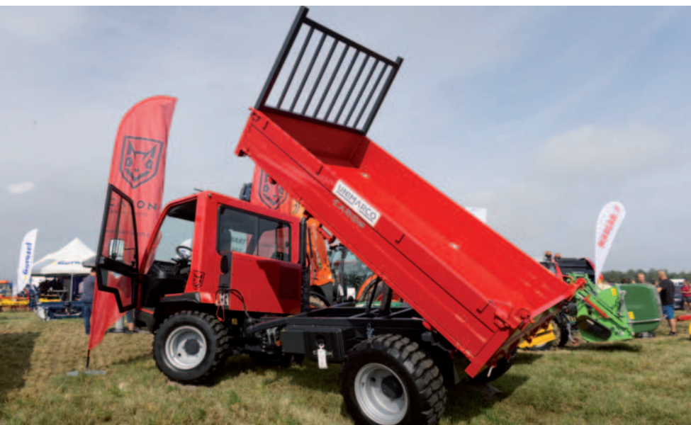
Obr.: Univerzální transportér Caron kombinuje vlastnosti traktoru, nákladního a víceúčelového vozidla. Foto: Věra Hejhálková, DiS.
