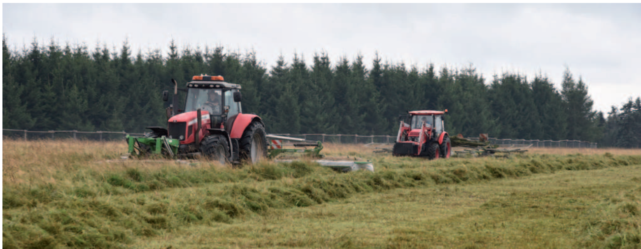
Obr.: Žací trojkombinace SaMASZ KDD 861 následovaná shrnovačem téže značky. Foto: Jiří Hejhálek
