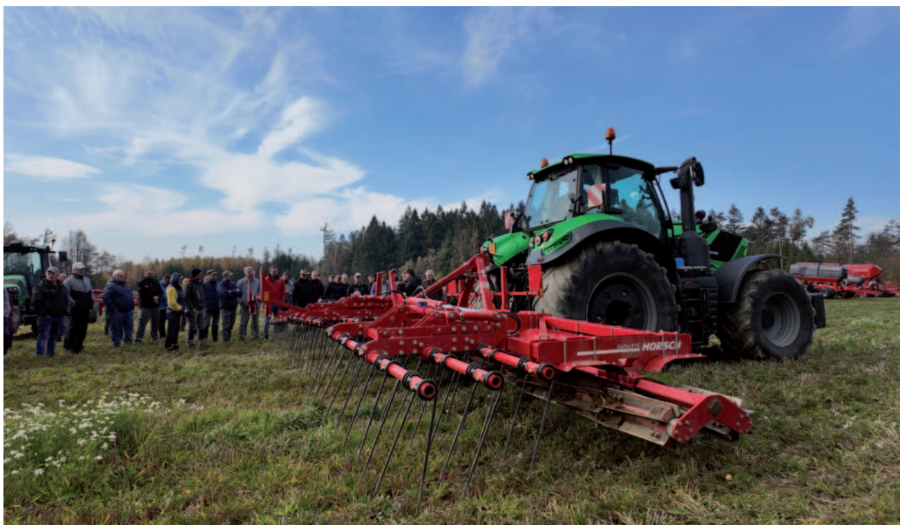
Obr.: Nožové válce Horsch Cultro 9 TC je vhodné použít při prvotním mělkém zpracování řepkového, slunečnicového nebo kukuřičného strniště, případně při rozměňování porostů meziplodiny.
