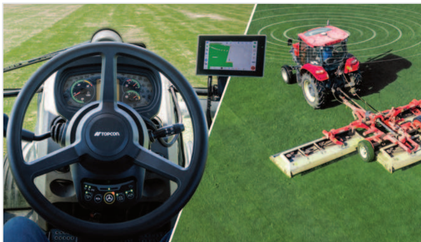
Obr.: Řešení Value Line Steering je komplexní balíček zahrnující přijímač globálního navigačního satelitního systému (GNSS), elektrický ovladač volantu, dotykový displej a software Horizon Lite.
