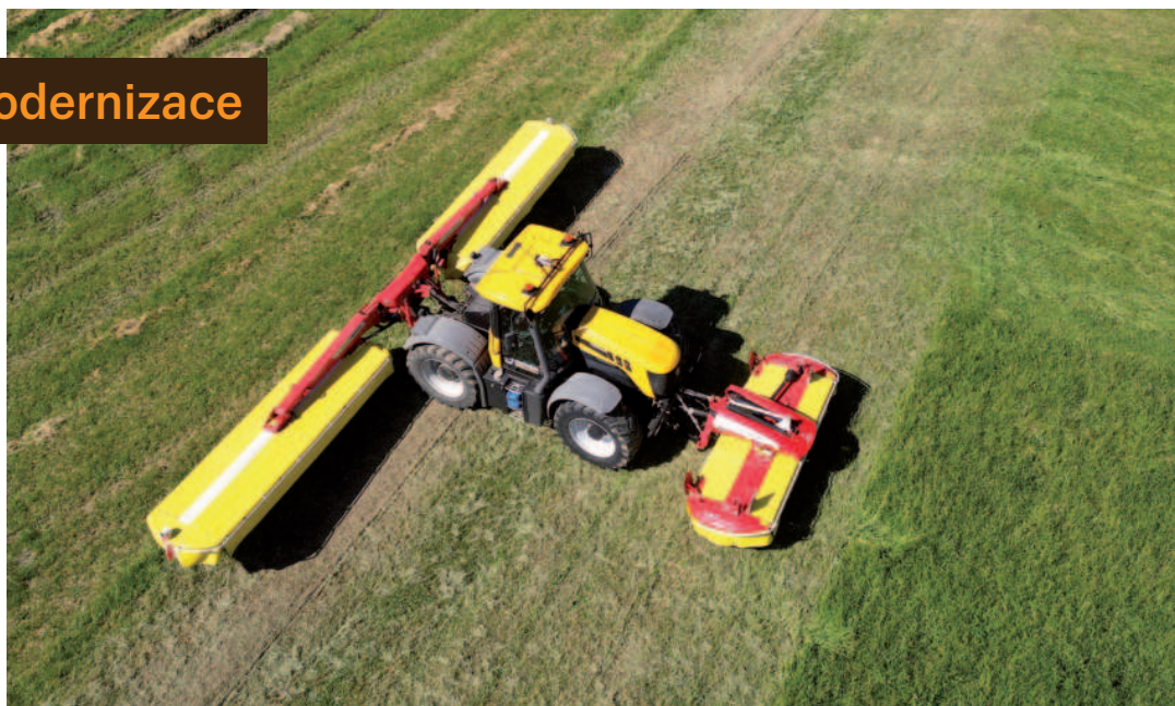
Obr.: Žací kombinace NOVACAT S12 disponuje pracovním záběrem 11,20 metru.
