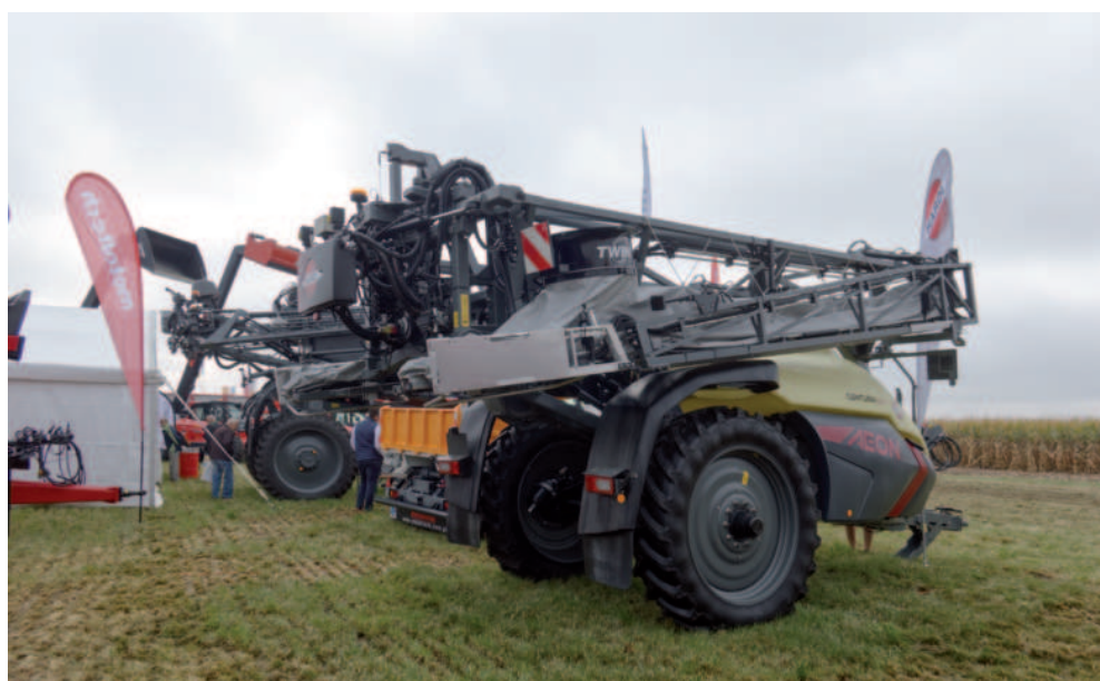
Obr.: Aeon je ve srovnání s ostatními postřikovači delší, nižší a má větší světlou výšku. Příznivý poměr šířky k délce umožňuje používat ramena i s větším pracovním záběrem. Foto: Věra Hejhálková, DiS.
