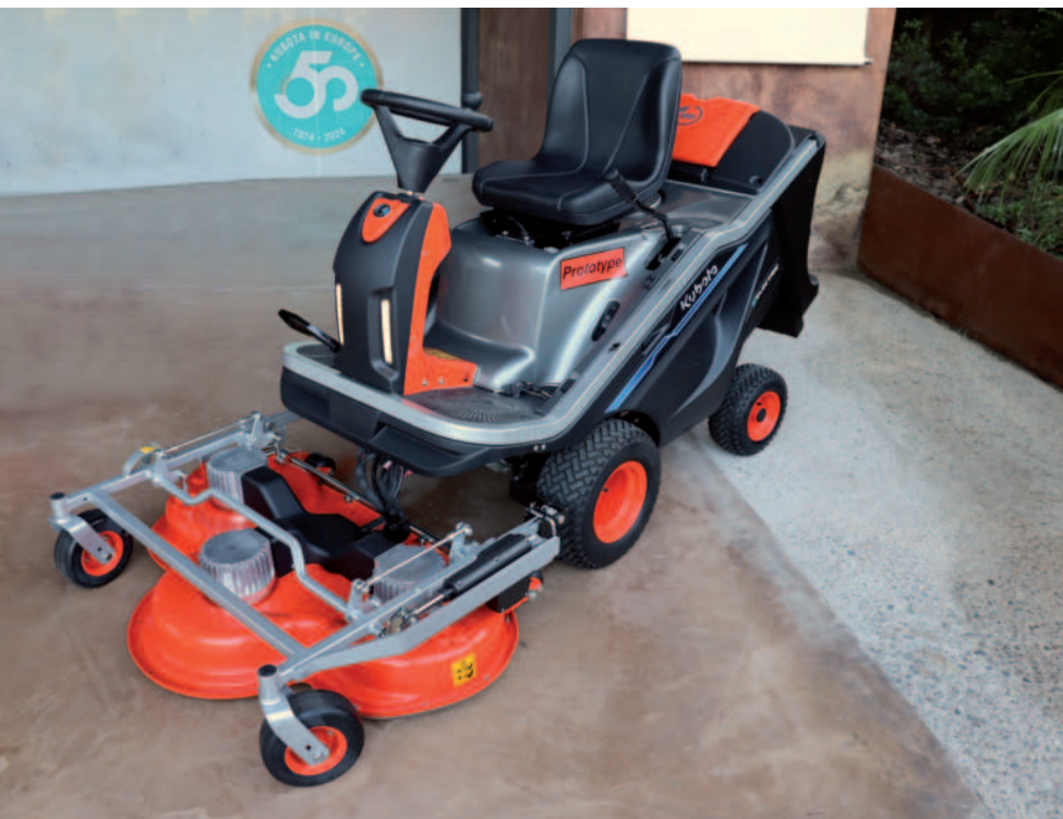
Obr.: Prototyp elektrické travní sekačky s čelním sečením (112 cm) přenastavitelným na zadní výhoz. Foto: Milan Jedlička
