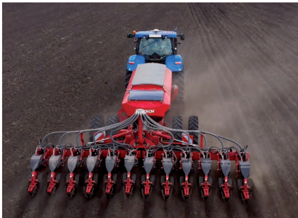
Obr.: Horsch Maestro 12 CV, písmena CV v názvu znamenají, že je secí stroj vybaven podtlakovými dávkovači Horsch AirVac. Ilustrační foto. Foto: Horsch / Youtube
