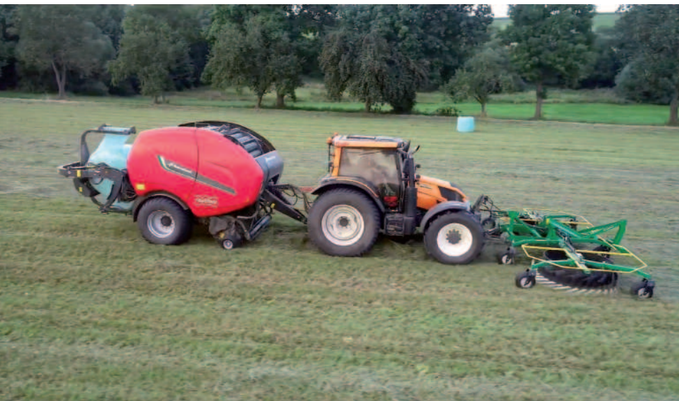
Obr.: 160koňový traktor Valtra v kombinaci s hydraulicky poháněným čelně zavěšeným shrnovačem AGRONIC a kombinovaným lisem Kverneland FastBale.
