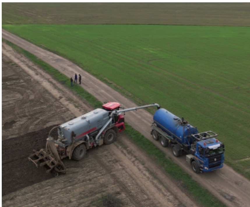
Obr.: Holmer Terra Variant 650 je dostupný s nádrží Zunhammer o objemu 21 m 3 . Přečerpání z cisterny trvá s výkonnější verzí čerpadla jen 2 minuty.
